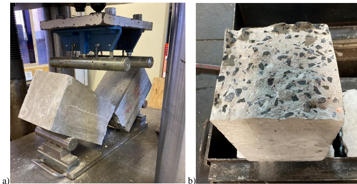
Figura 21 – Ensaio do CP prismático e superfície áspera resultante
