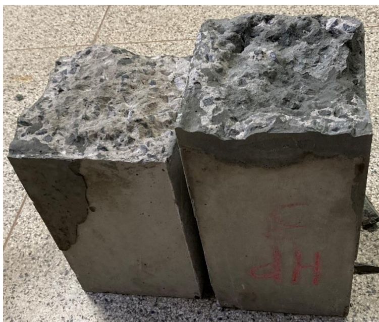
Figura 30 – Superfície de ruptura dos prismas reparados
