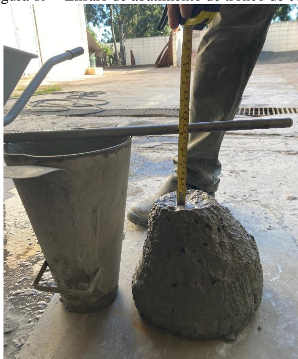
Figura 19 – Ensaio de abatimento de tronco de cone
