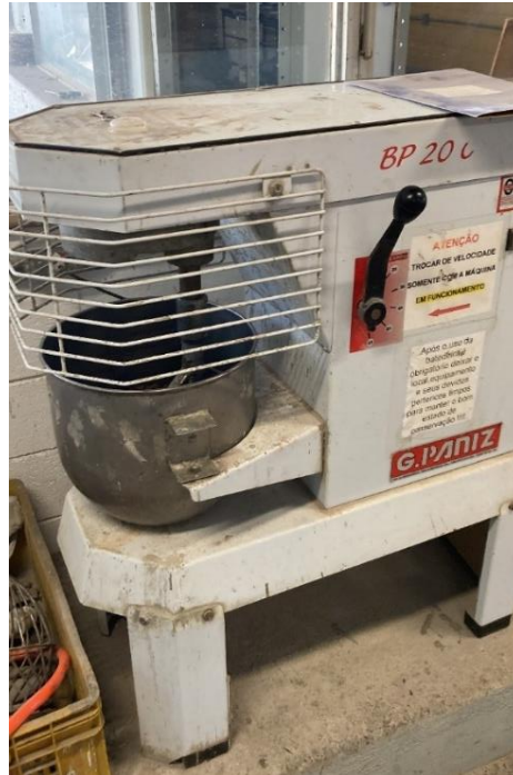
Figura 8 – Argamassadeira de eixo planetário
