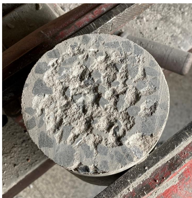
Figura 22 – Superfície serrada do corpo de prova cilíndrico em processo de desgaste
