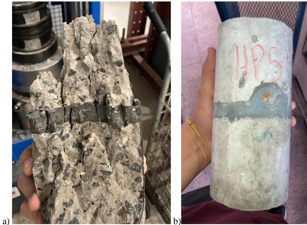
Figura 29 – Corpos de prova reparados submetidos ao ensaio de compressão axial
