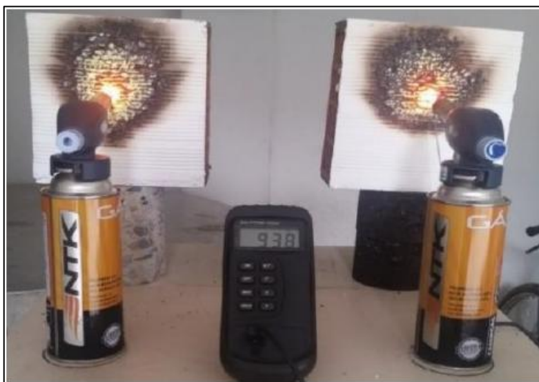
Figura 18: Aplicação da chama na superfície onde foi aplicada a tinta intumescente.
