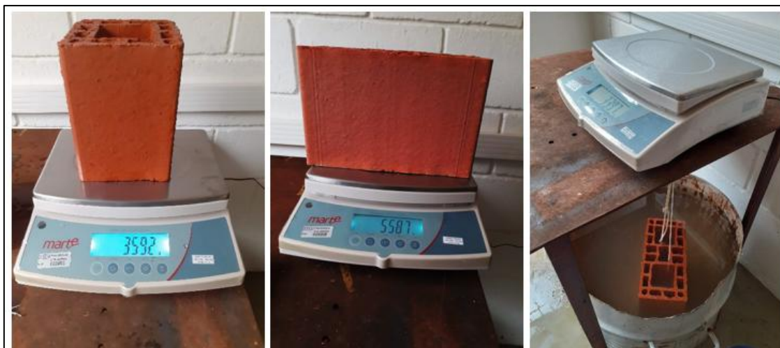
Figura 25: Etapas do ensaio para determinação das Áreas líquida e bruta
