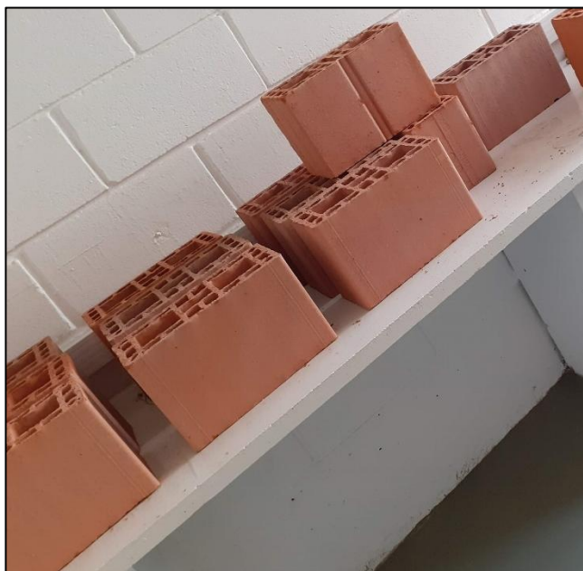
Figura 20: Blocos de cerâmica, de parede vazada, com resistência de 6Mpa
