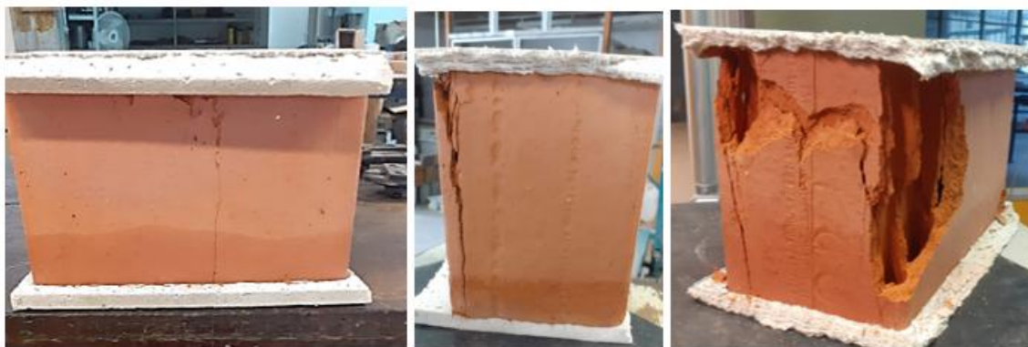
Figura 27: Ruptura dos blocos de alvenaria estrutural
