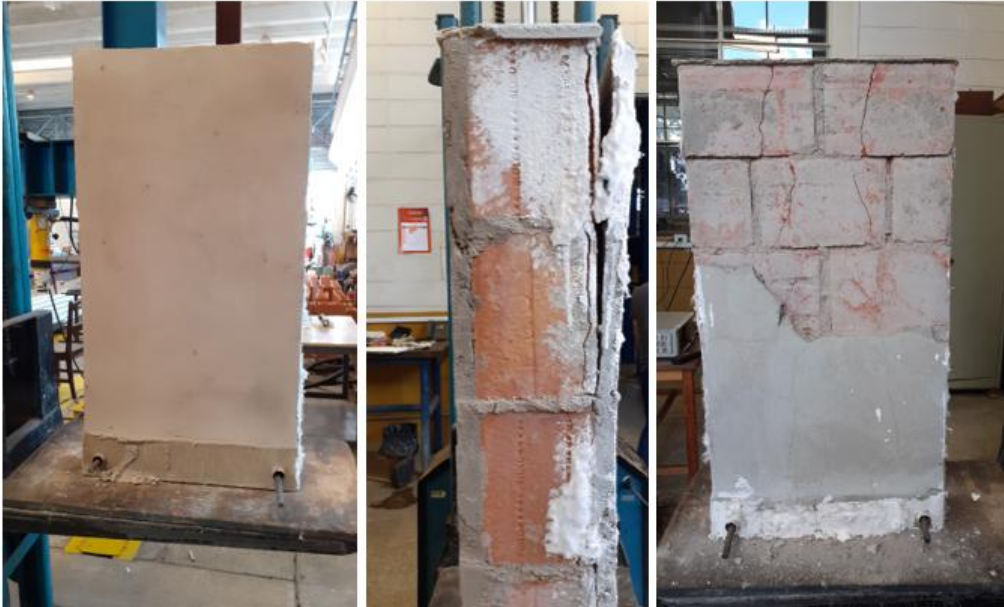
Figura 42: CONJUNTO DE ARGAMASSA COM ADIÇÃO DE FIBRAS DE POLIPIPILENO: À esquerda o lado que estava interno ao trio. As outras duas, a pequena parede depois de ensaiado quanto à resistência residual à compressão
