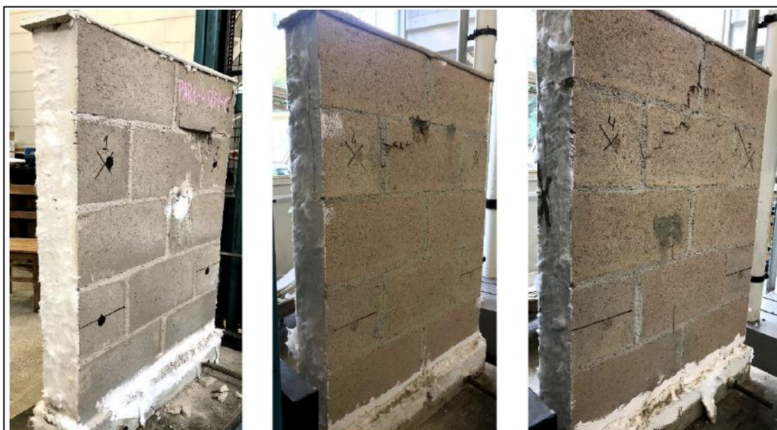
Figura 16: Modo de ruptura das paredes compartimentadas após o ensaio
