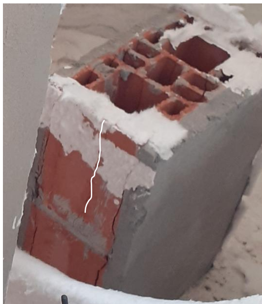
Figura 43: Prisma com argamassa com adição de fibra de polipropileno após o resfriamento.
