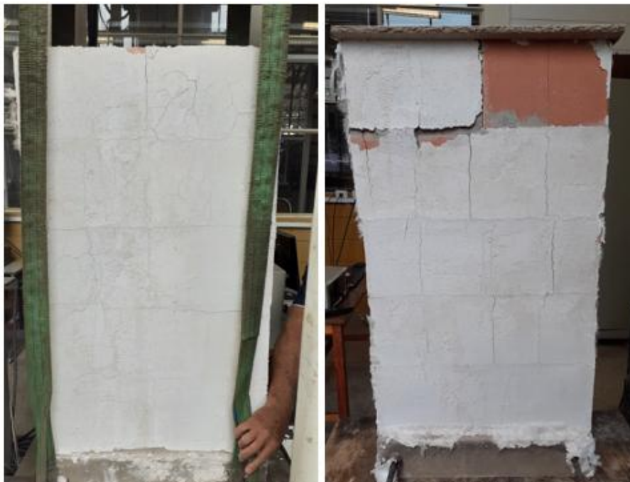
Figura 47: CONJUNTO DE ARGAMASSA DE GESSO E AREIA: À esquerda parede ao ser retirada do forno, depois do resfriamento. À Direita a parede depois de rompida para verificação da resistência residual
