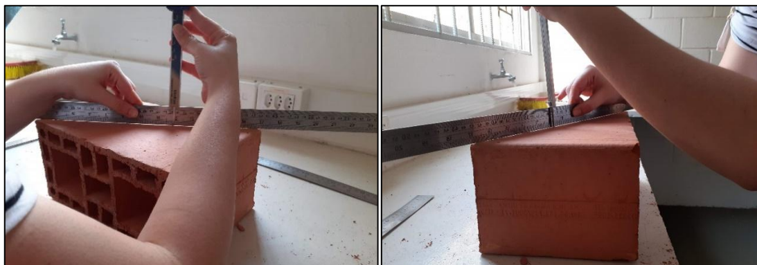
Figura 24: Ensaio para determinação da planeza das faces
