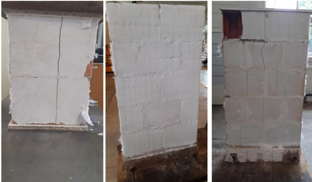
Figura 45: CONJUNTO COM TINTA INTUMESCENTE: À esquerda o prisma depois de rompido para verificação da resistência residual. Ao meio a parede ao ser retirada do forno, depois do resfriamento. À Direita a parede depois de rompida para verificação da resistência residual
