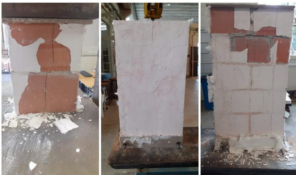
Figura 46: CONJUNTO DE ARGAMASSA DE GESSO COM VERMICULITA: À esquerda o prisma depois de rompido para verificação da resistência residual. Ao meio a parede ao ser retirada do forno, depois do resfriamento. À Direita a parede depois de rompida para verificação da resistência residual
