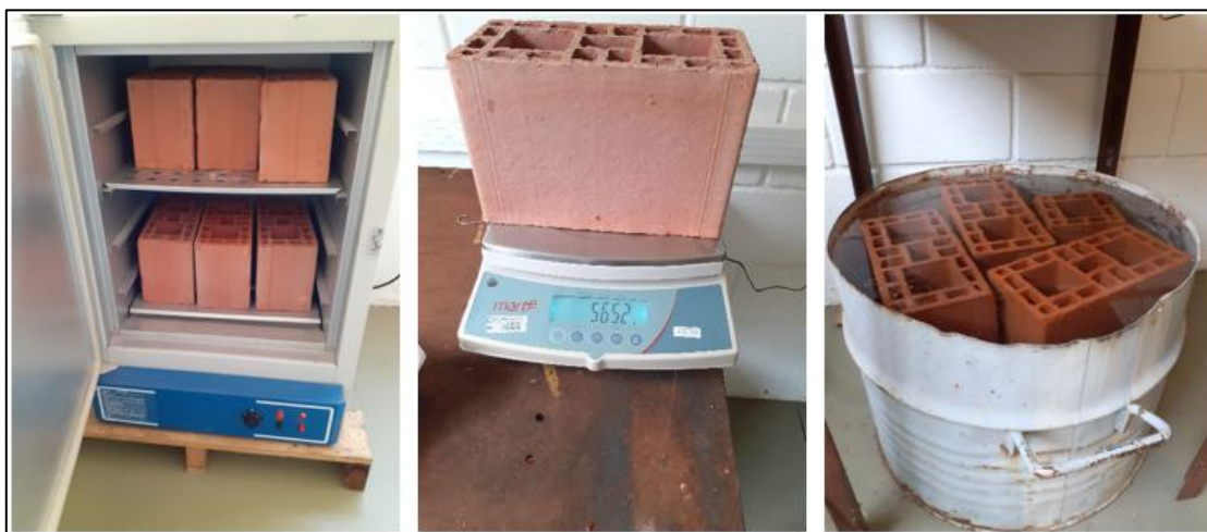
Figura 26: Secagem dos blocos em estufa, pesagem e submersão por 24 horas.
