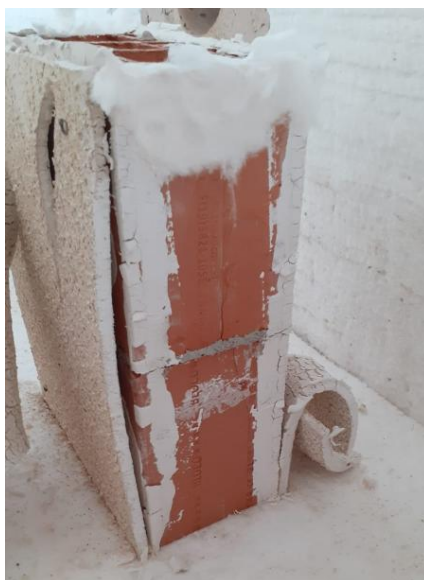
Figura 55: Prisma revestido de Drywall após o resfriamento
