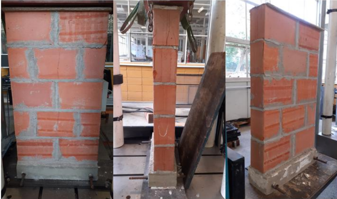
Figura 33: Modo de Ruptura das pequenas paredes
