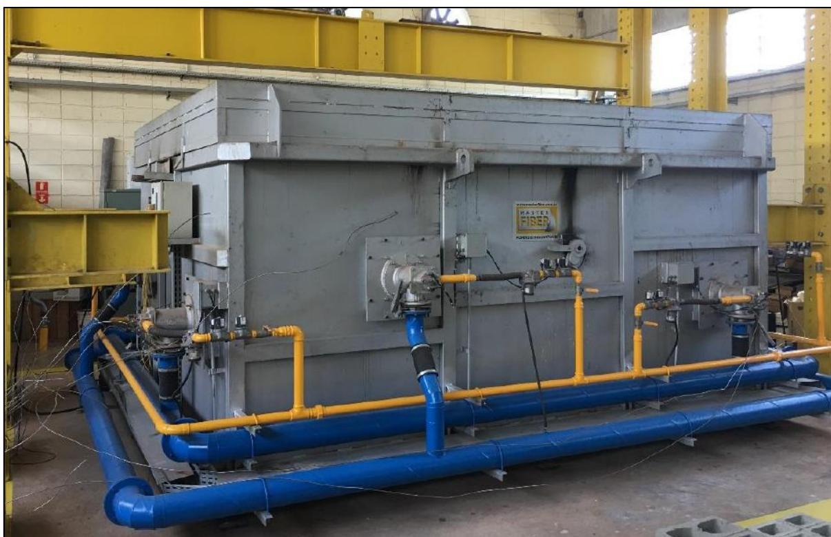
Figura 1: Forno a gás do Laboratório de Estruturas da EESC – USP.
