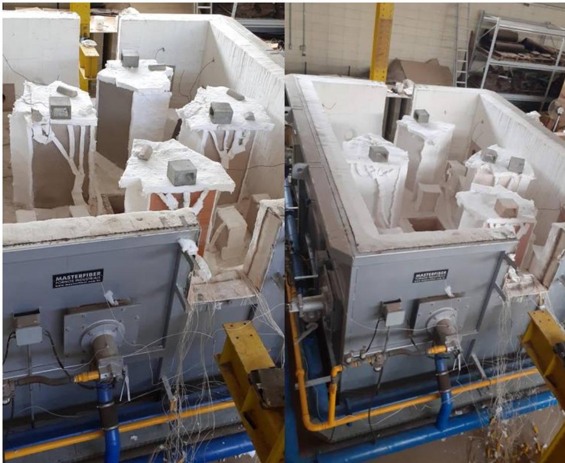
Figura 38: Disposição dos corpos de prova dentro do forno à esquerda a foto dos grupos da primeira fornada. À direita a foto dos grupos da segunda fornada.
