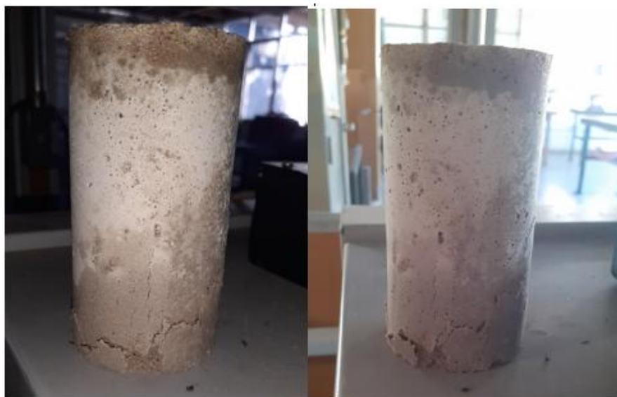
Figura 29: Corpo de prova de argamassa de assentamento rompido à compressão
