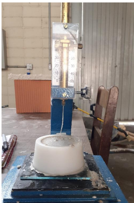
Figura 30: Ensaio se início e fim de pega da argamassa de gesso e areia
