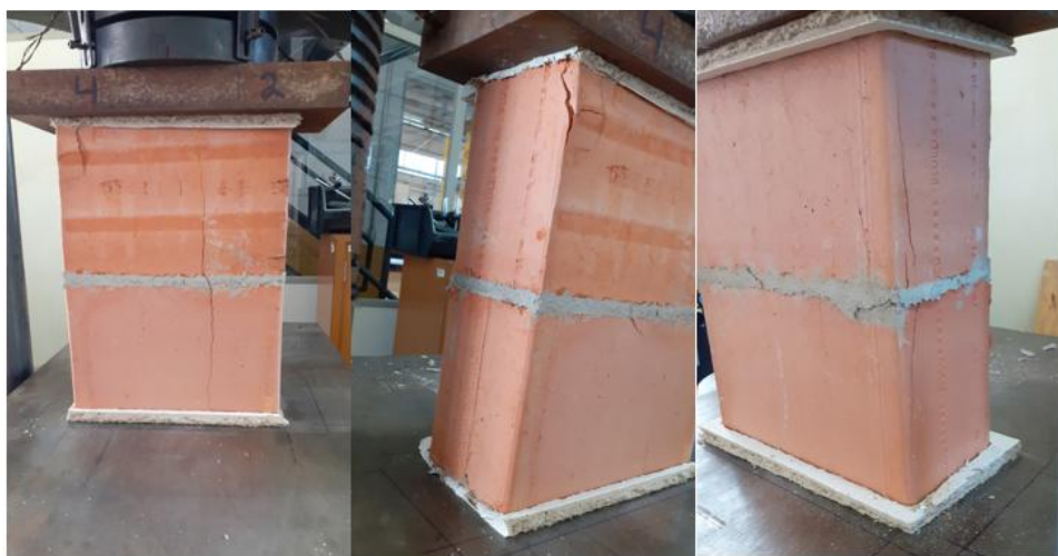
Figura 32: Modo de Ruptura dos prismas
