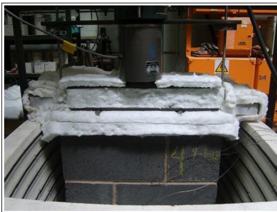
Figura 11: Pequena parede de alvenaria estrutural sob teste de compressão antes da elevação de temperatura
