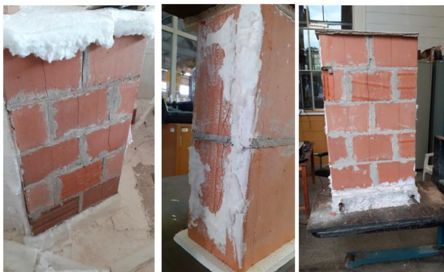
Figura 39: CONJUNTO SEM REVESTIMENTO - À esquerda a pequena parede ao ser resfriada. No meio o prisma ao sair do forno. À direita a parede depois do ensaio de resistência residual
