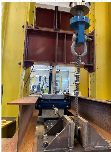
Figura 4-14 – Aparato experimental – Sistema de ancoragem do bloco e Sistema de cabo e polia
