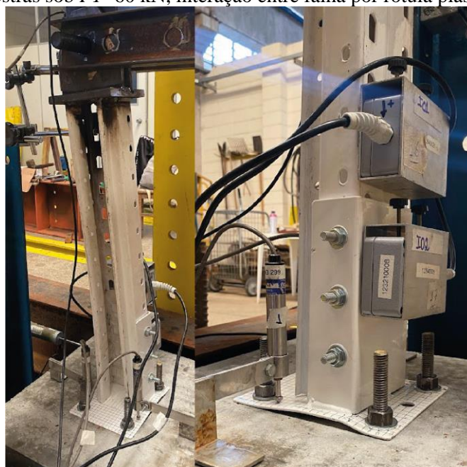
Figura 5-7 – Amostras sob FI=60 kN, interação entre falha por rótula plástica e instabilidade
