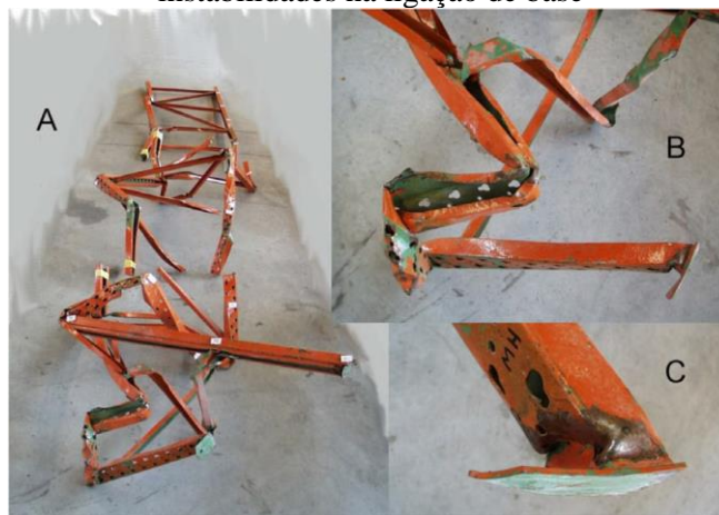
Figura 2-1 – Detalhes dos modos de falha dos componentes da estrutura porta-paleta que sofreram colapso, (a) flambagem lateral na coluna, (b) instabilidades na coluna conectada à base, (c) instabilidades na ligação de base
