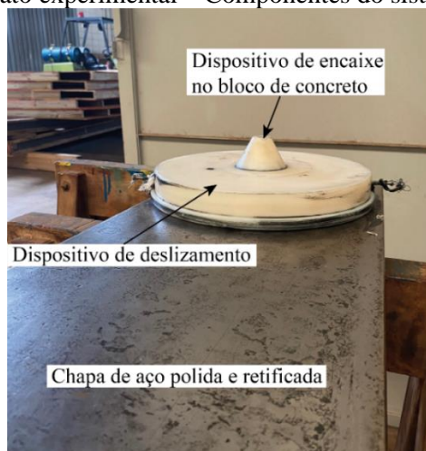
Figura 4-16 – Aparato experimental – Componentes do sistema de deslizamento
