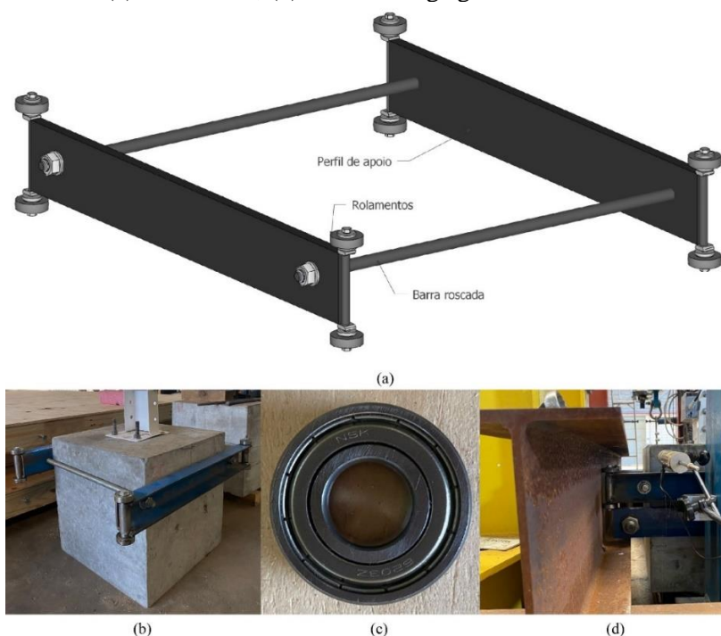
Figura 4-12 – Aparato experimental – Sistema guia com rolamentos (a) Perspectiva, (b) Amostra, (c) Rolamento, (d) Interface viga guia e rolamento
