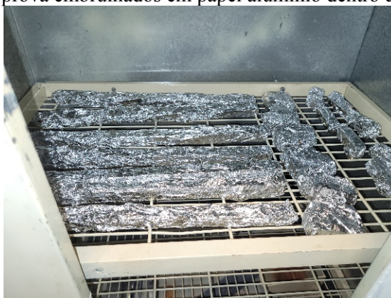
Figura 12 – Corpos de prova embrulhados em papel alumínio dentro da estufa à 60°C.
