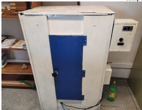
Figura 10 – Estufa utilizada para a secagem da madeira: a) a estufa; b) o painel de regulação da temperatura.
