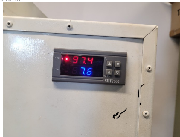
Figura 10 – Estufa utilizada para a secagem da madeira: a) a estufa; b) o painel de regulação da temperatura.
