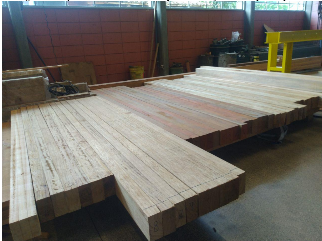
Figura 6: Peças de madeira utilizadas para confecção dos corpos de prova
