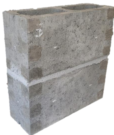
Figura 4.28: Aplicação da malha idealizada no ensaio de ultrassom em prisma de alvenaria
