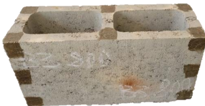
Figura 3.10: Aplicação da malha idealizada no ensaio de ultrassom em bloco de concreto
