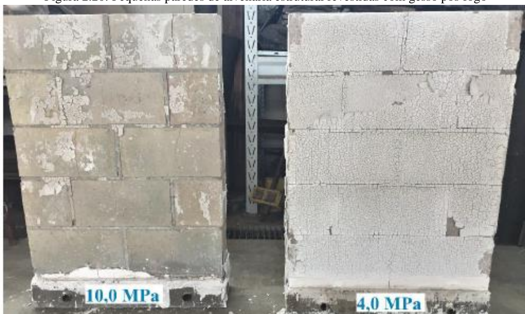
Figura 2.20: Pequenas paredes de alvenaria estrutural revestidas com gesso pós fogo
