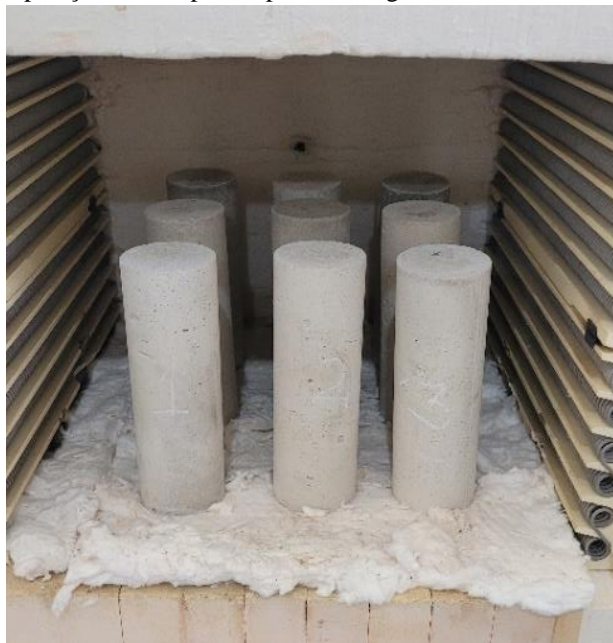
Figura 4.13: Disposição dos corpos de prova de argamassa durante os ensaios térmicos
