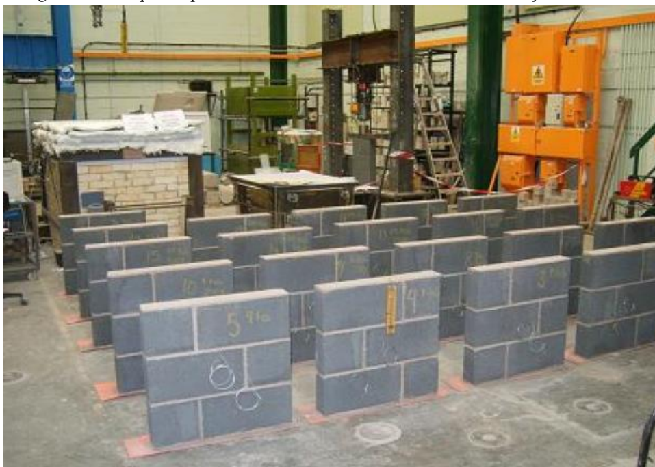
Figura 2.19: Pequenas paredes de alvenaria estrutural antes da realização dos ensaios
