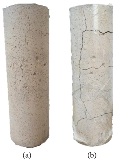
Figura 4.15: Evolução das fissuras em argamassas ensaiadas à 600 °C: (a) imediatamente após retirada do forno e (b) uma semana após retirada do forno
