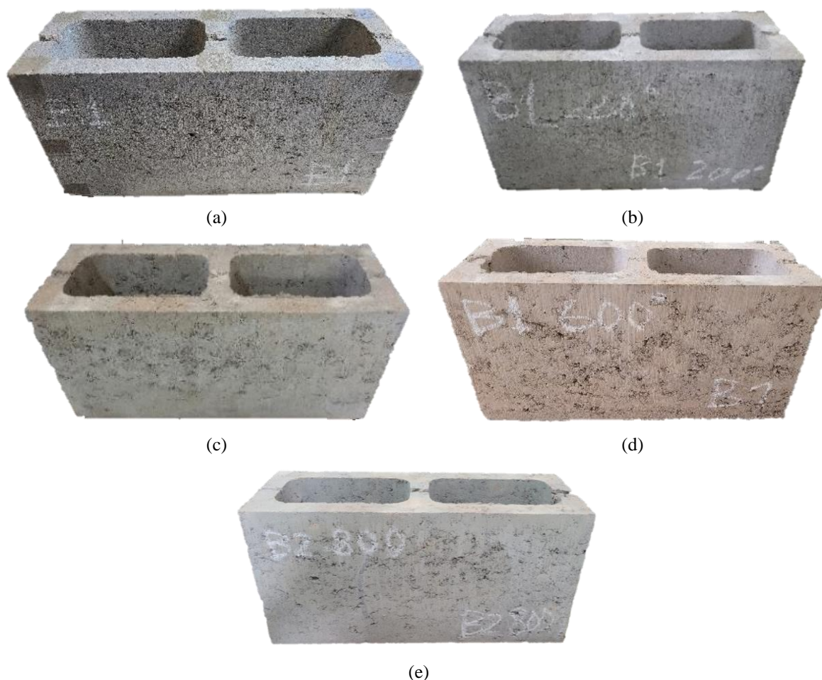
Figura 3.7: Blocos de concreto após ensaios em temperaturas elevadas: (a) Ambiente, (b) 200 °C, (c) 400 °C, (d) 600 °C e (e) 800 °C
