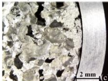
Figura 5.21 – Espuma de Alumínio Inserida em um Tubo
