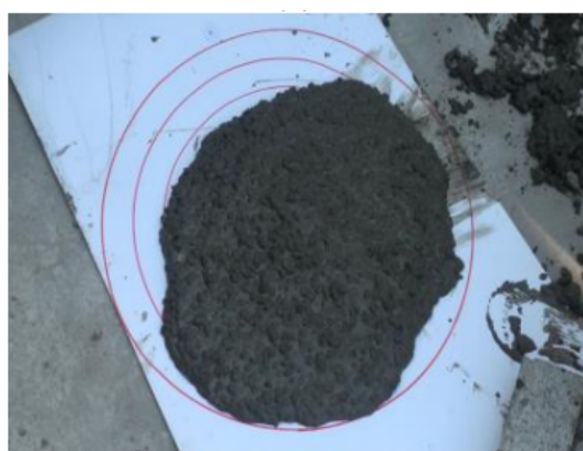
(b) Ensaio após espalhamento
