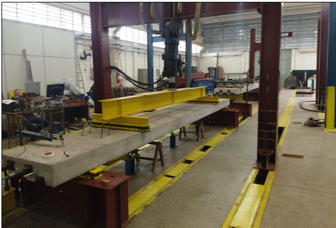
Figura 10.4 - Protótipo de laje mistas protendida LMP-01 no ensaio de flexão [2]
