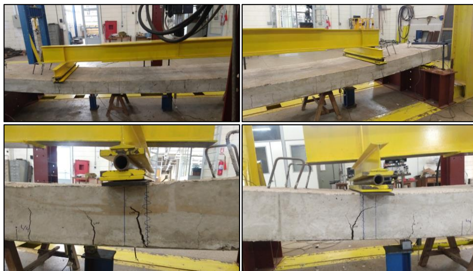
Figura 10.10 – Fissuras típica sob ponto de aplicação de carga na LMP-01 ensaio [2]
