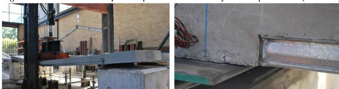
a) Laje mista no ensaio de flexão
