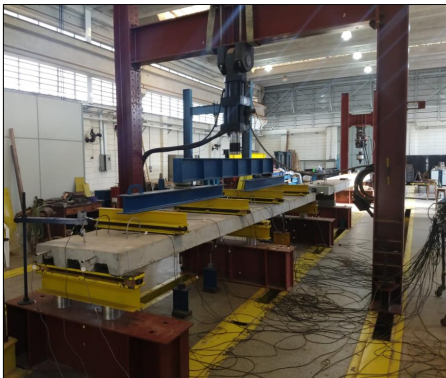
Figura 8.19 – Visão geral do protótipo de laje mistas usando concreto leve LMc-03 com continuidade entre dois vão adjacentes com vãos de 2 \times 2.800 mm
