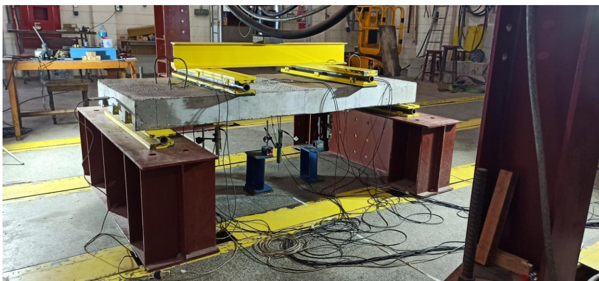
Figura 8.3 - Protótipo de laje mistas usando concreto leve LM-1 com vão livre de 1.800 mm
