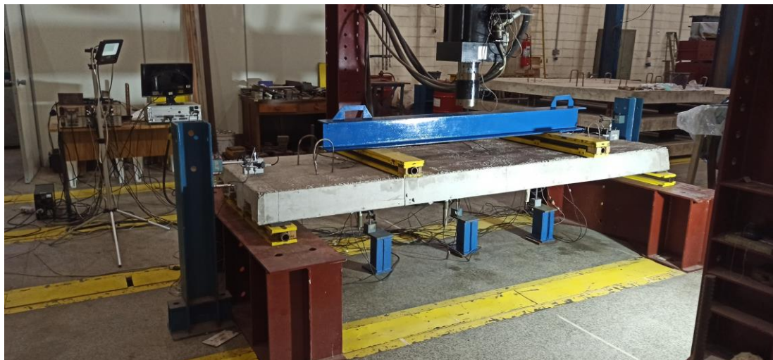
Figura 8.4 - Protótipo de laje mistas usando concreto leve LM-2 com vão de 2.800 mm
