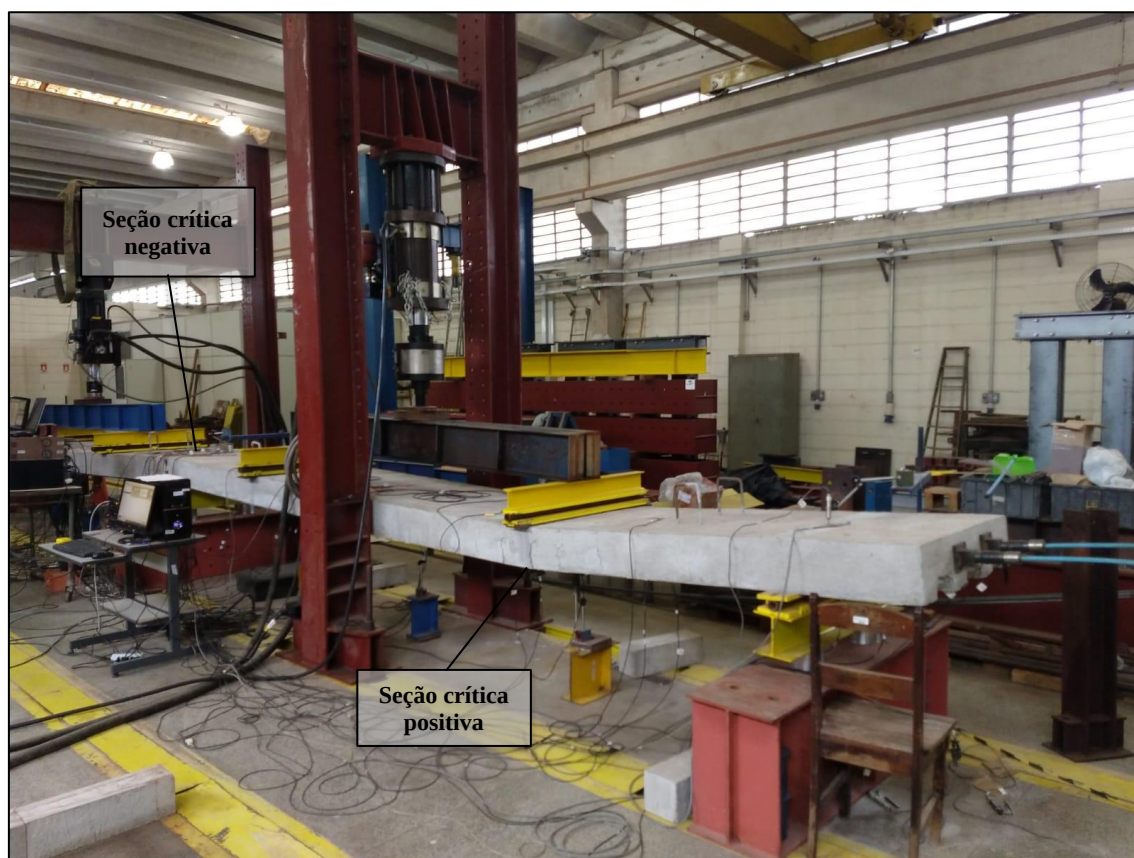
Figura 10.32 – Protótipo da LMPc-03 ao final do ensaio de flexão
