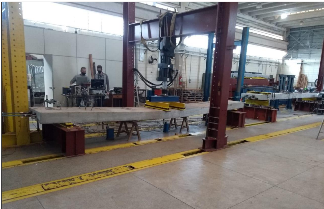
Figura 10.3 - Protótipo de laje mistas protendida LMP-01 no ensaio de flexão [1]
