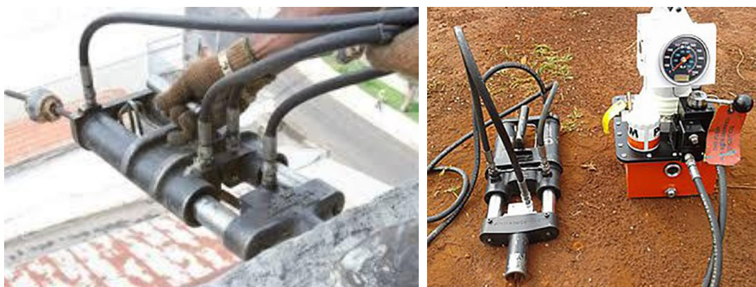
Equipamentos para protensão – macaco hidráulico do tipo monobloco e bomba
