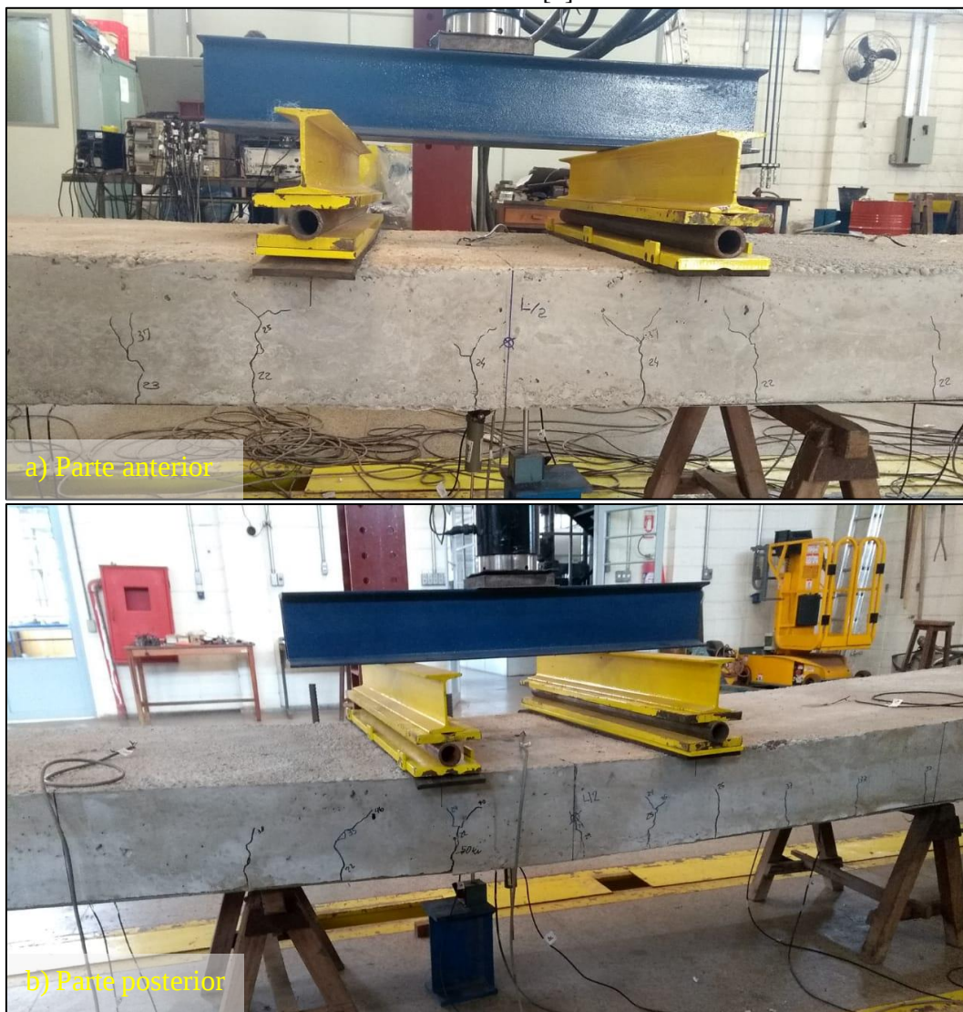
Figura 10.9 – Panorama geral da fissuração concentrado na região do meio do vão da LMP-01 ensaio [1]
