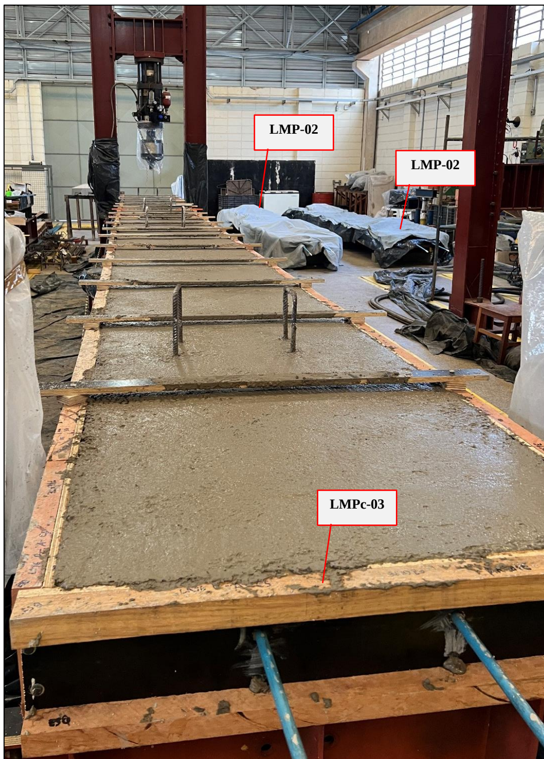
Figura 6.26 - Condição de acabamento superficial e cura úmida dos protótipos com recobrimento da superfície com lonas plásticas
