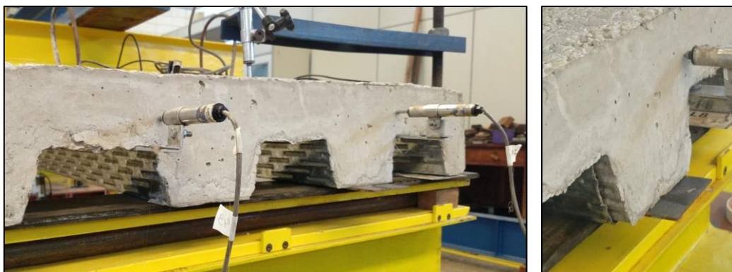
Figura 8.21 - Deslizamentos relativos de extremidade entre aço e concreto
