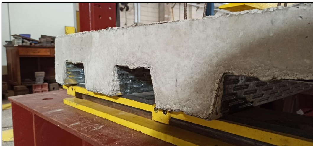
Figura 8.7 - Deslizamentos relativos de extremidade entre aço e concreto
