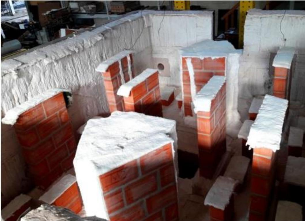
(b) Configuração das pequenas paredes isoladas e em trios para ensaio térmico.
