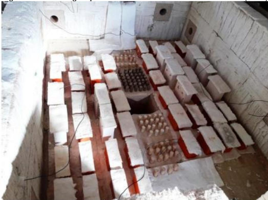
(a) Disposição dos componentes de alvenaria para ensaio térmico.
