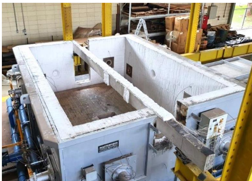
Figura 2.40 – Posicionamento das vigas no forno
