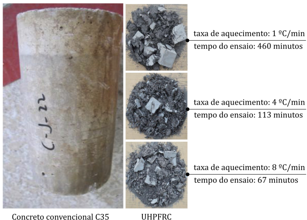
Figura 19 – Corpos de prova de concreto após serem submetidos ao ensaio térmico.
