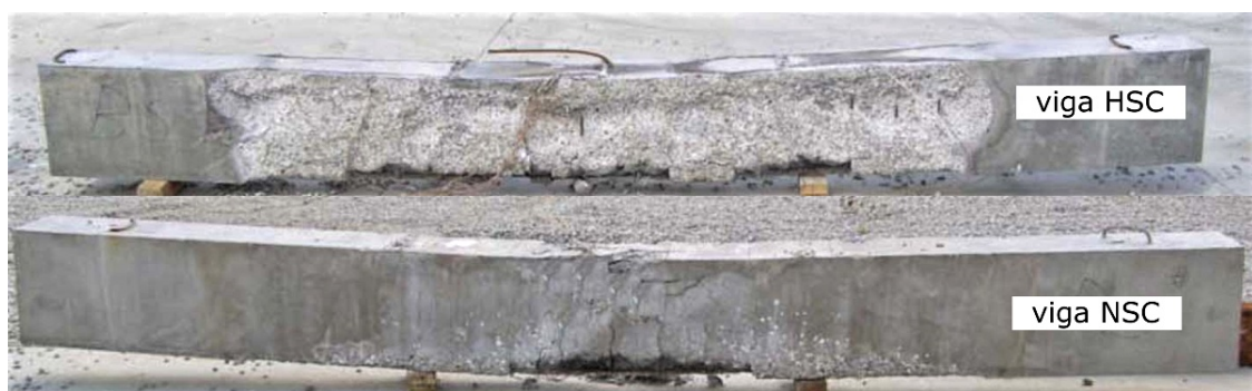
Figura 26 – Elementos de viga de concreto armado após ensaio termomecânico.
