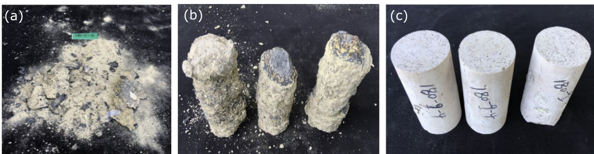
Figura 2 – Fenômeno de spalling explosivo do UHPC; (a) Sem fibras; (b) Com 1,5% de fibras de aço e 0,1% de fibras PVA em volume; (c) Com 1,5% de fibras de aço e 0,5% de fibras PVA em volume
