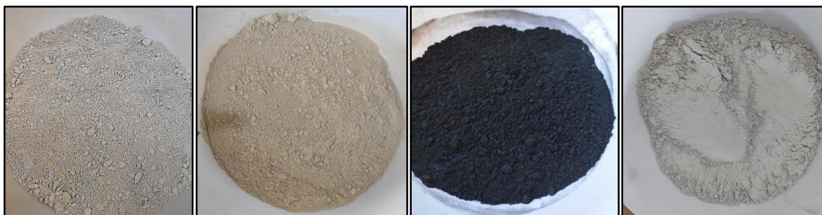
Figura AP.A.1- Adições Minerais utilizadas na produção dos concretos: (a) sílica ativa, (b) metacaulim, (c) cinza de casca de arroz e (d) fíler calcário
