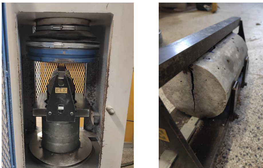
Figura 4.8– a) Ensaio de compressão diametral; b) Corpo de prova pós ruptura
