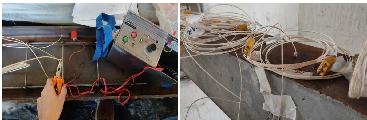
Figura 6.5 – Fixação dos termopares: (a) nos componentes de aço e (b) nas mesas da viga.
