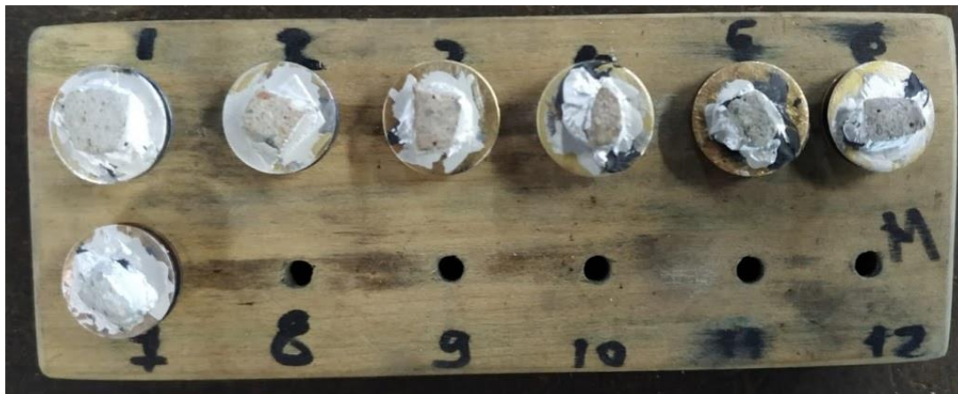
Figura 4.13 – Amostras fraturas (em temperatura ambiente) para realização do MEV
