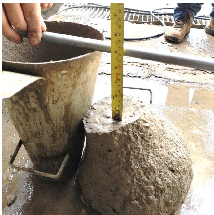
Figura 4.3 – Ensaio de abatimento de tronco de cone do traço MC-FC
