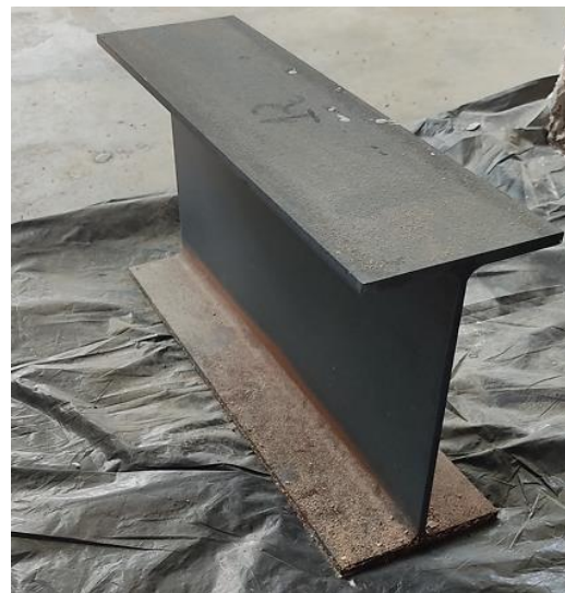
Figura 5.17 – CP12 após exposição ao fogo: a) lado 1; b) lado 2
