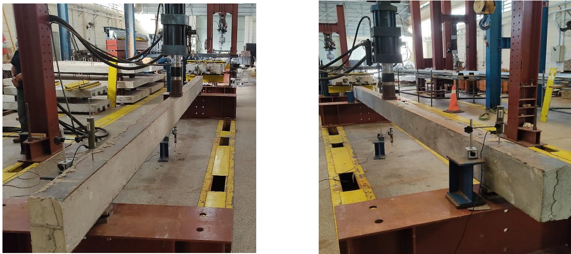
Figura 6.10 - Ensaio de flexão a três pontos das VMPR com concretos ecoeficientes: (a) VT-1 e (b) VQ-2
