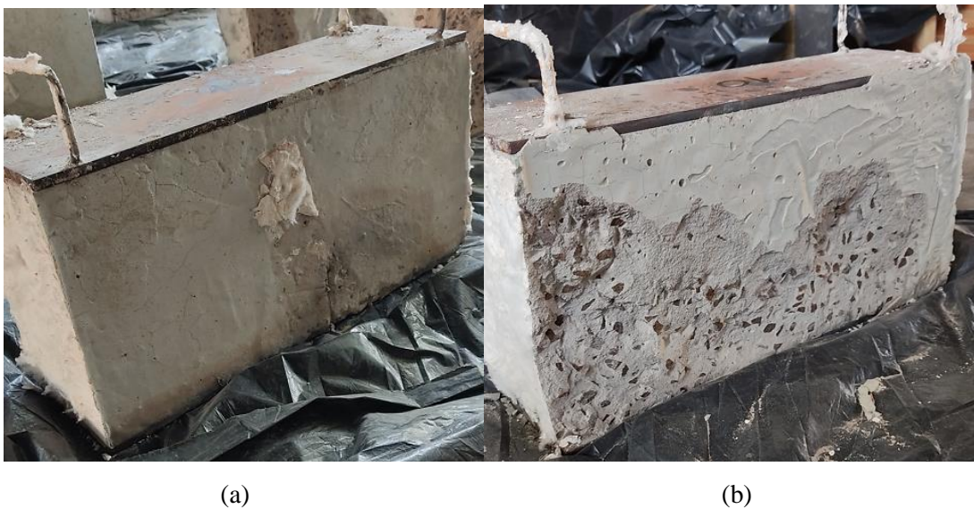
Figura 5.30 - CP10 após a exposição ao fogo: (a) lado 1 e (b) lado 2
