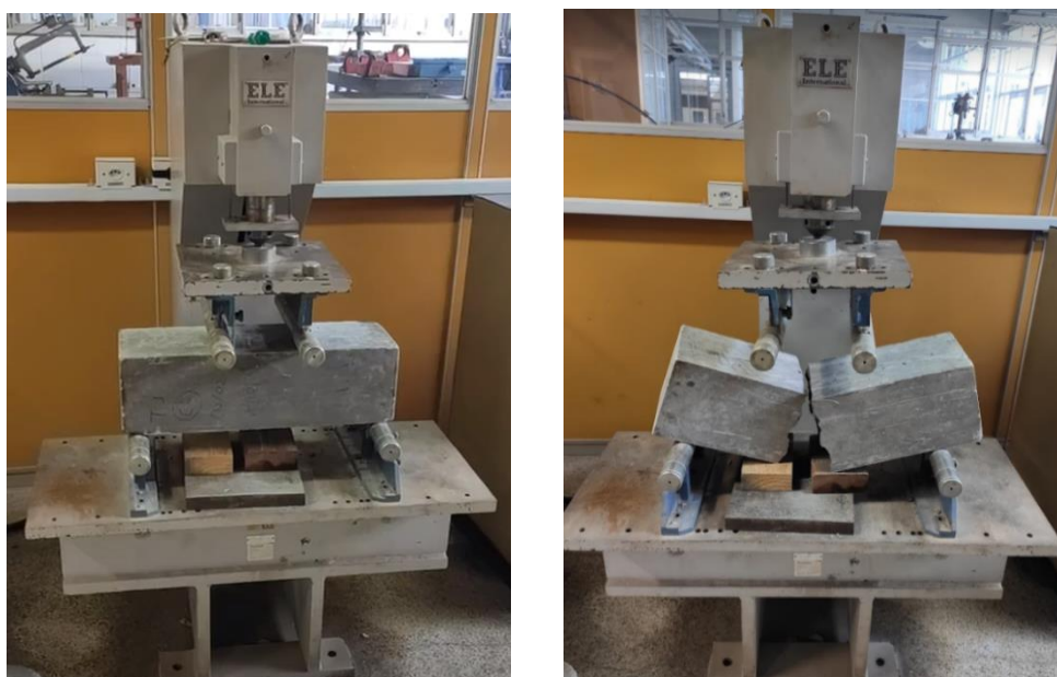
Figura 4.9 – a) Ensaio de flexão a quatro pontos; b) Ruptura do prisma
