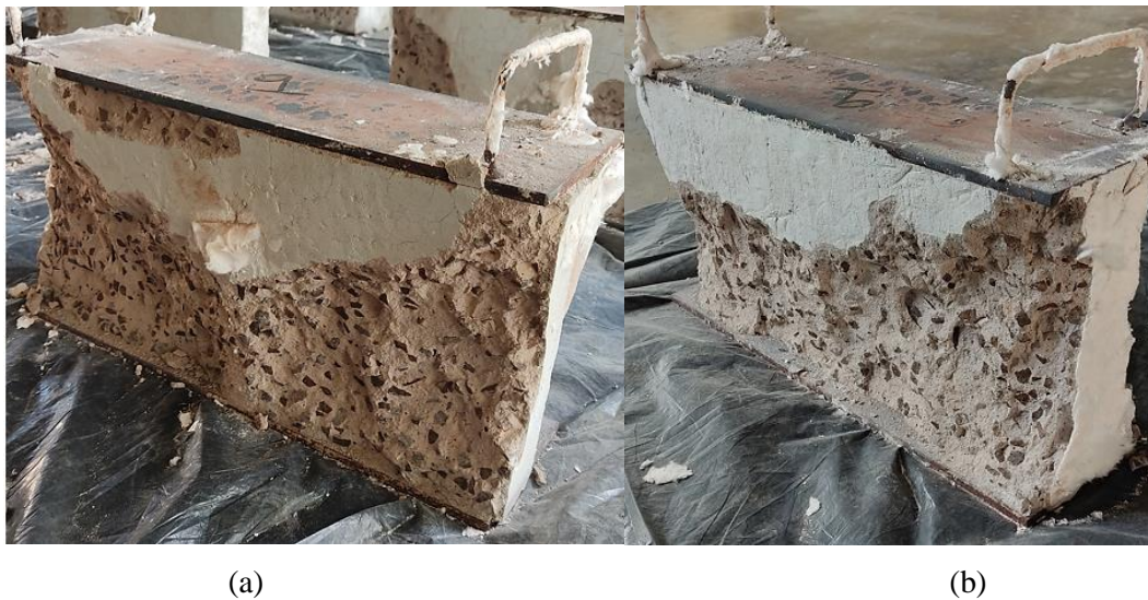
Figura 5.32 - CP9 após a exposição ao fogo: (a) lado 1 e (b) lado 2
