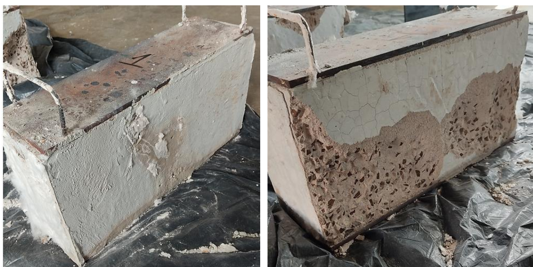
Figura 5.15 - CP1 após exposição ao fogo: (a) lado 1 e (b) lado 2
