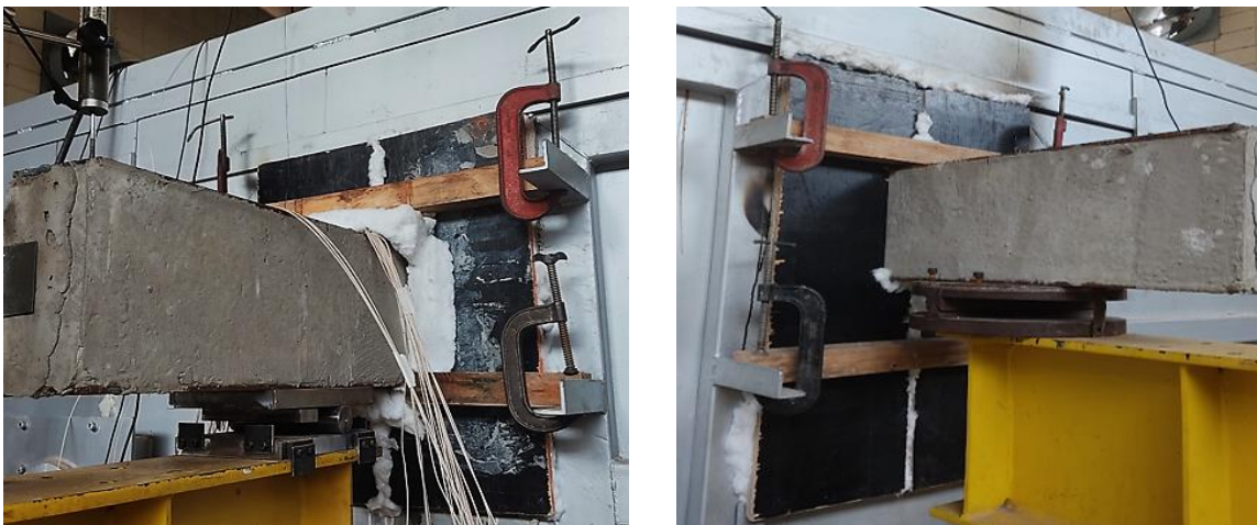
Figura 6.20 - Sistema de vedação nas laterais do forno
