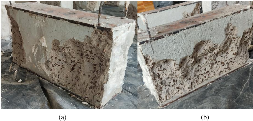
Figura 5.31 - CP8 após a exposição ao fogo: (a) lado 1 e (b) lado 2
