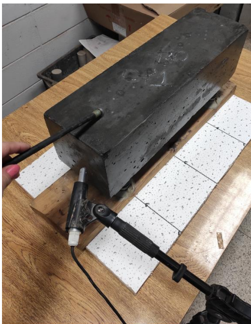
Figura 4.10 - Ensaio de módulo de elasticidade dinâmico
