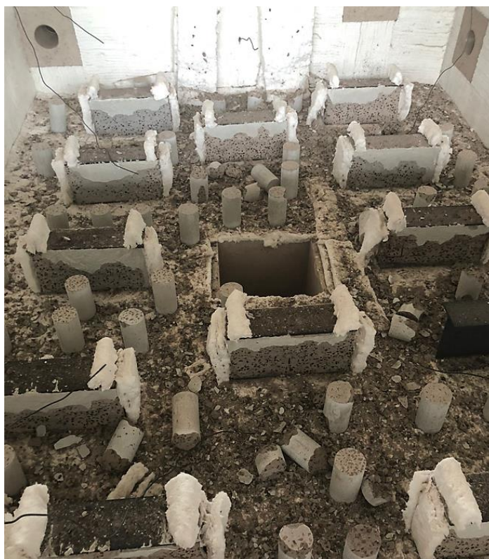
Figura 5.34 - Degradação dos corpos de prova cilíndricos pós-fogo
