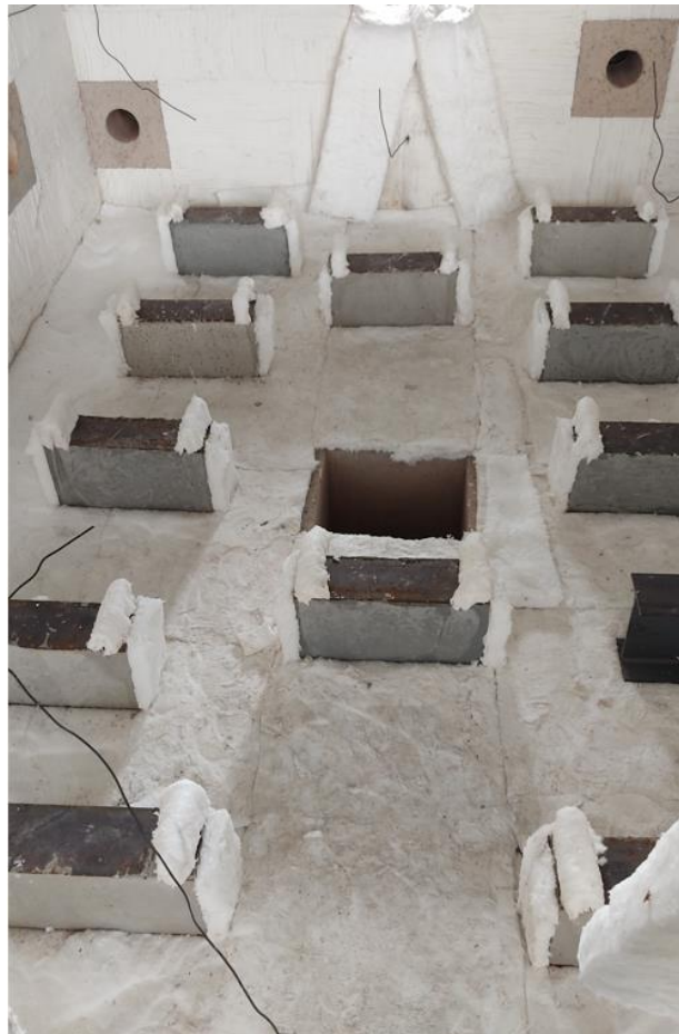
Figura 5.10 – Posicionamento real dos corpos de prova no forno
