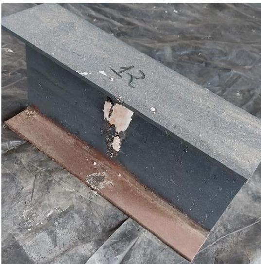
Figura 5.17 – CP12 após exposição ao fogo: a) lado 1; b) lado 2
