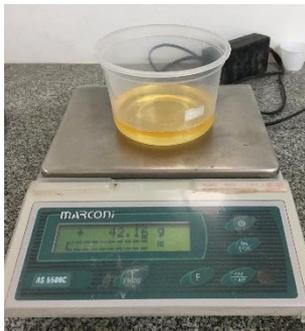
(a) Pesagem da resina epóxi bicomponente
