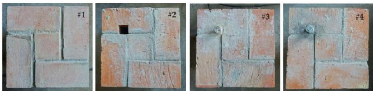
Figura 2.24 – Pilares defeituosos de alvenaria para ensaio tomográfico
