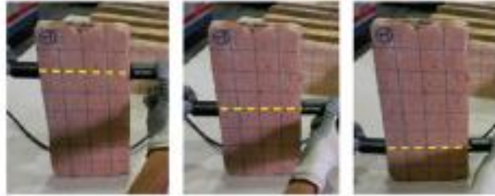
Figura 2.16 – Ensaio ultrassônico em tijolos cerâmicos
