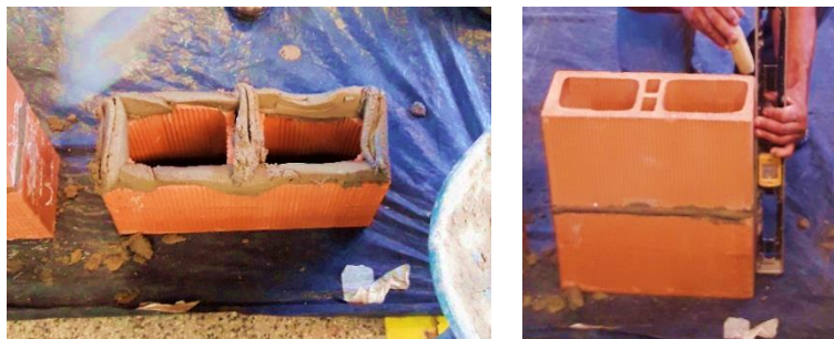
Figura 4.3 – Execução dos prismas de alvenaria estrutural
