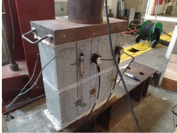
Figura 2.31 – Ensaio de acustoelasticidade em prisma de alvenaria estrutural
