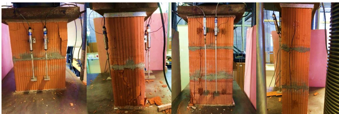
Figura 4.9 – Modo de ruptura dos prismas
