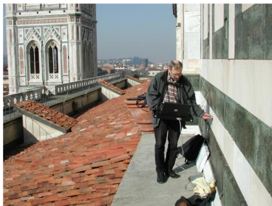
Figura 2.19 – Aplicação do ultrassom em alvenaria in situ
