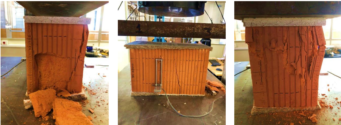
Figura 3.5 – Modo de ruptura dos blocos cerâmicos
