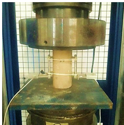
Figura 4.5 – Ensaio de resistência à compressão da argamassa de assentamento
