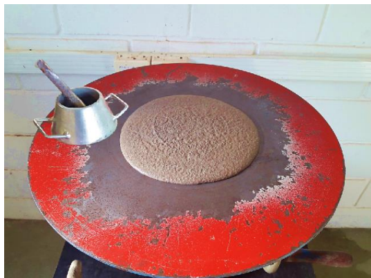
Figura 4.2 – Ensaio para obtenção do índice de consistência da argamassa
