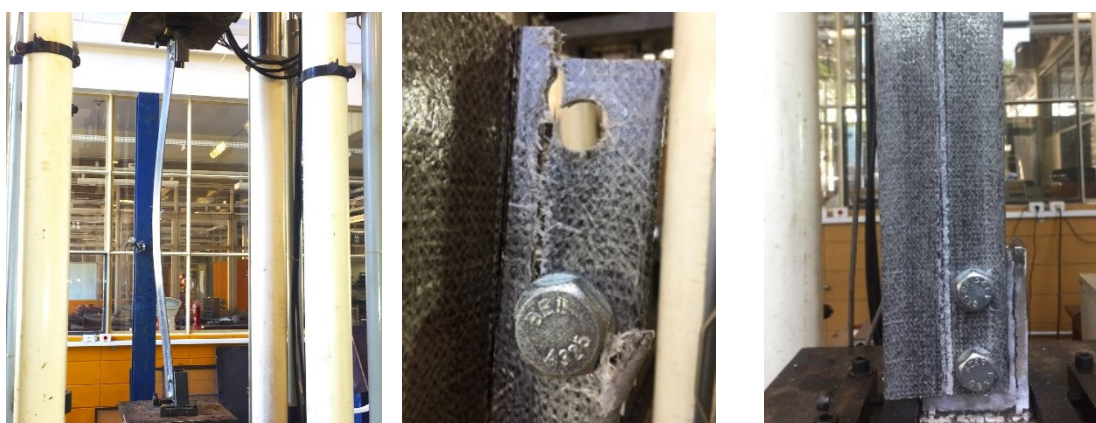
Figura 4.16 – Modos de ruptura das cantoneiras pPRFV conectadas por dois parafusos
