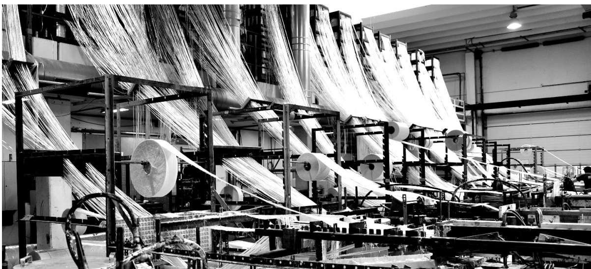
Figura 2.1 – Fabricação de perfis estruturais por pultrusão
