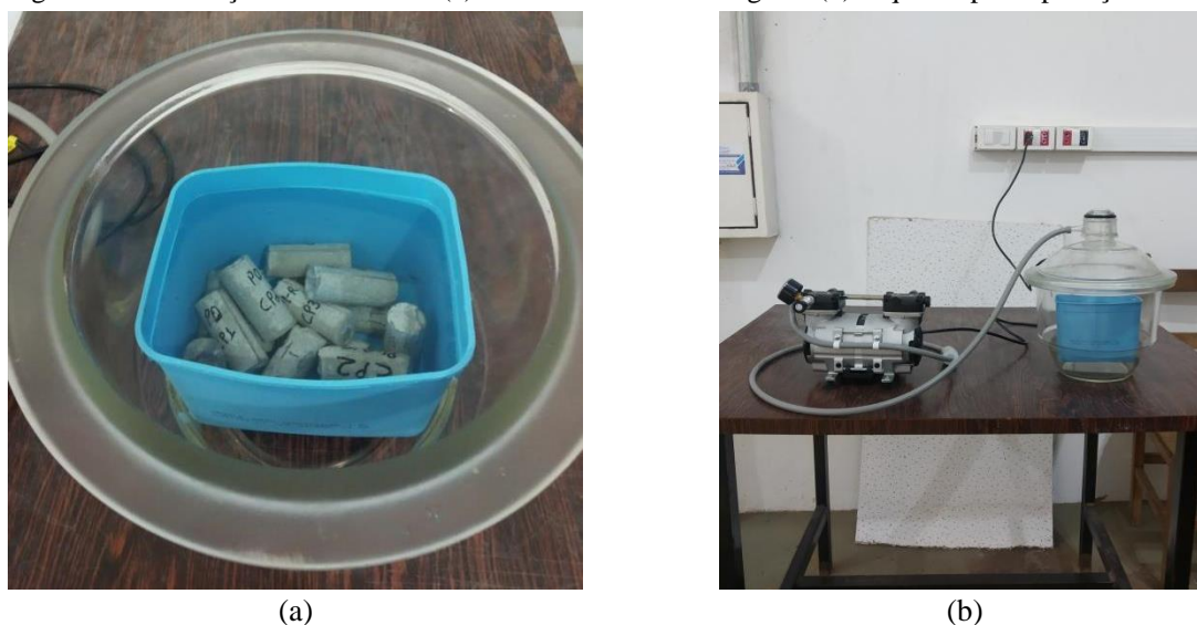
Figura 11 – Saturação das amostras: (a) amostras imersas em água e (b) esquema para aplicação de vácuo
