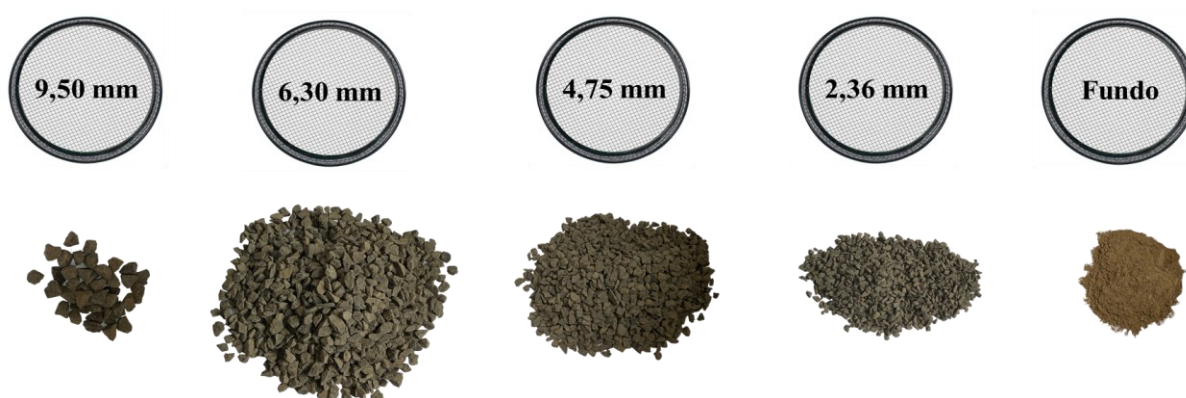
Figura 3.4 – Separação granulométrica do agregado graúdo natural
