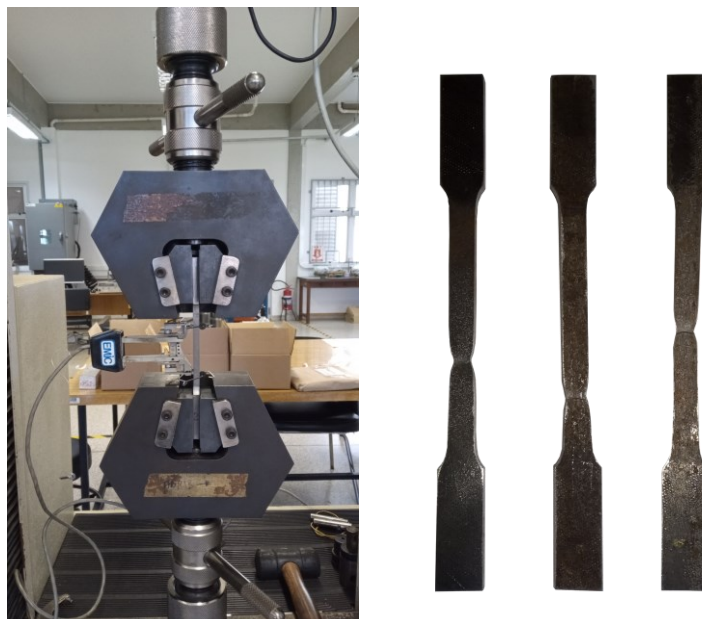
Figura 3.14 – Ensaio de caracterização do aço e ruptura dos corpos de prova
