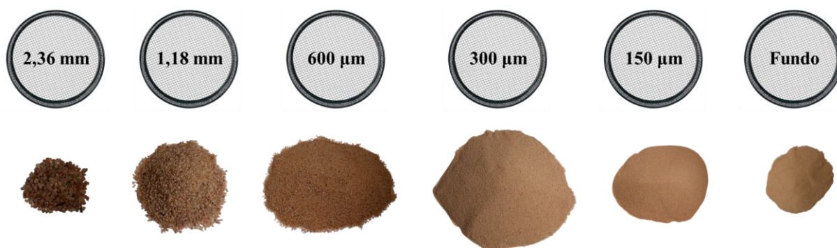
Figura 3.6 – Separação granulométrica do agregado miúdo natural
