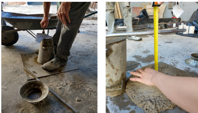
Figura 3.29 – Ensaio de abatimento de tronco de cone no CARC-50
