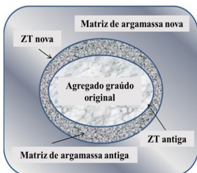
Figura 2.1 – (a) Diagrama esquemático do concreto de ARC (b) Microscopia das fases presentes no concreto reciclado
