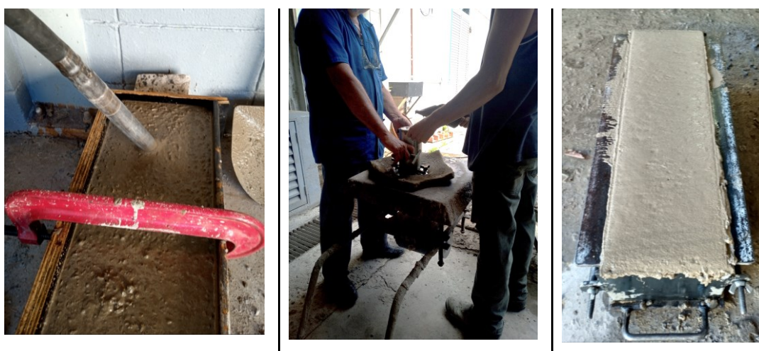
Figura 3.26 – Adensamento da VMPR e concretagem de corpos de prova
