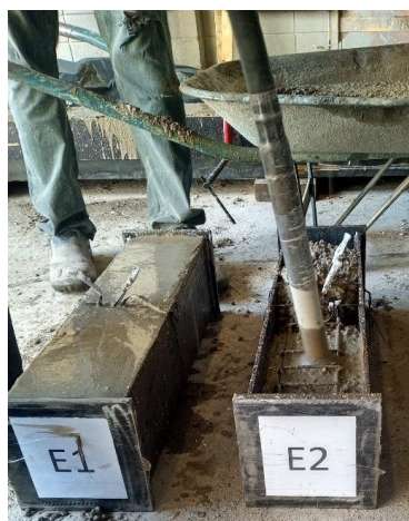
Figura 3.27 – Adensamento (a) por vibrador de agulha nos pilares e (b) por mesa vibratória nos corpos de prova de prova
