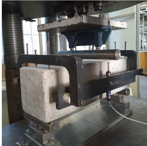
Figura 3.18 – Esquema de ensaio de flexão de prismas
