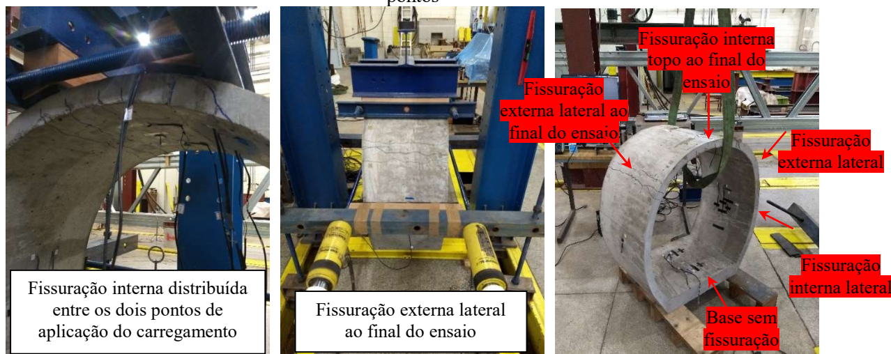
Figura 4.37 Padrão de fissuração no ensaio da galeria HPC com aplicação de carregamento vertical em 2 pontos
