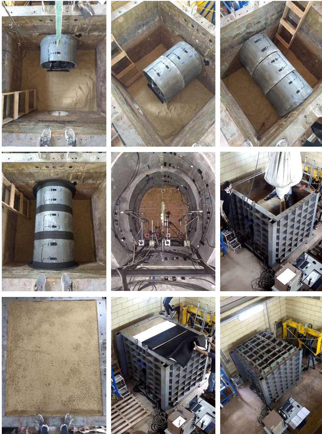
Figura 3.24 Montagem do ensaio na caixa de grandes dimensões
