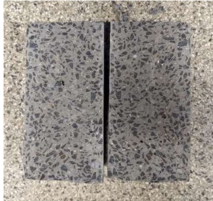
Figura 4.4 Ruptura na tração por compressão diametral do HPC
