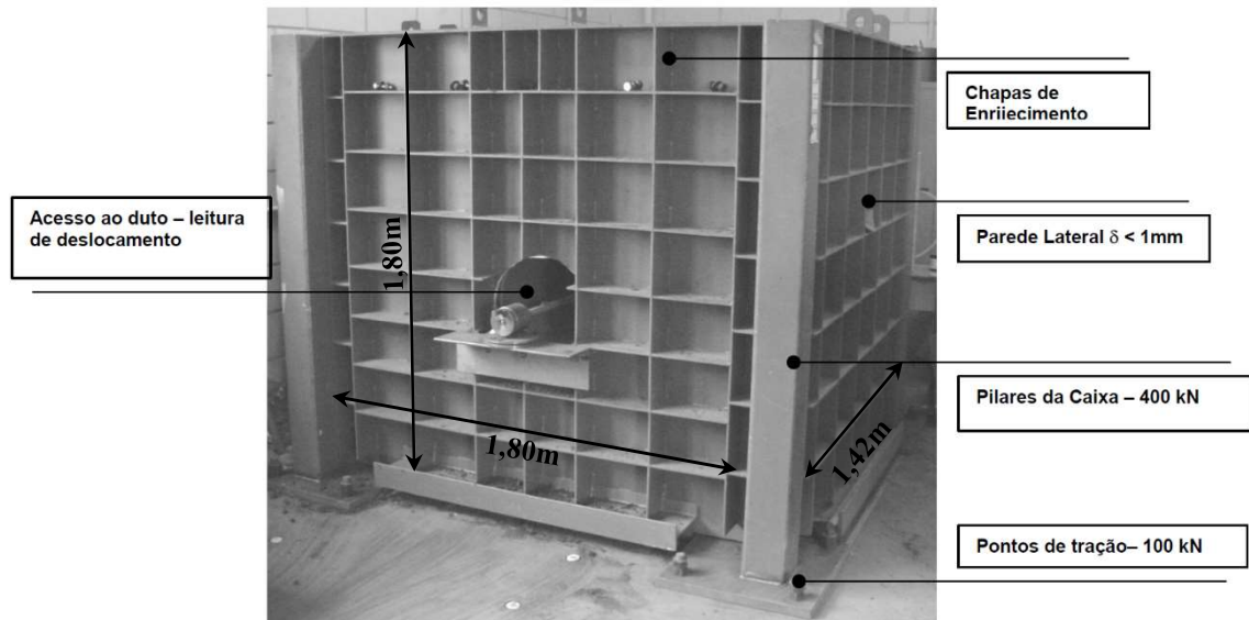
Figura 3.19 Caixa de teste de grandes dimensões
