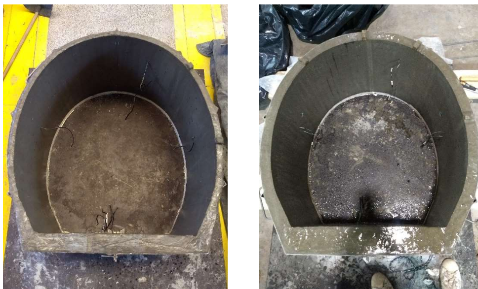
Figura 3.16 Desmoldagem e processo de cura para galeria de UHPC e HPC, respectivamente.
