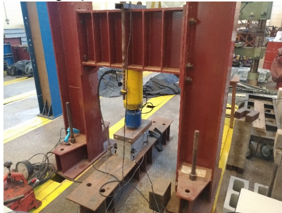
Figura 3.21 – Configuração do ensaio de acustoelasticidade realizado em blocos
