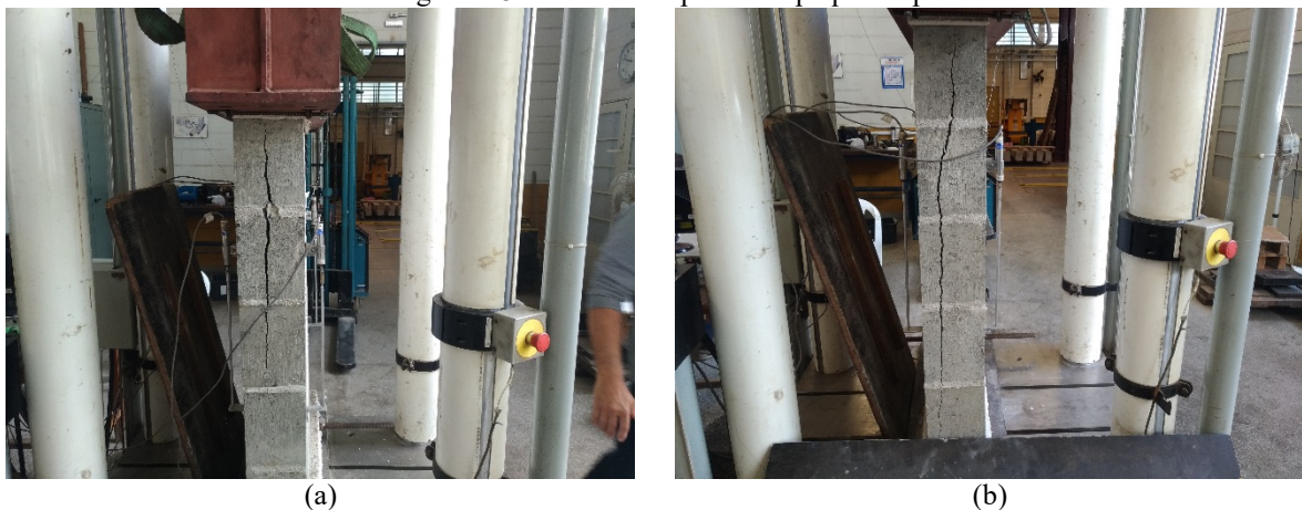
Figura 4.8 – Modo de ruptura das pequenas paredes
