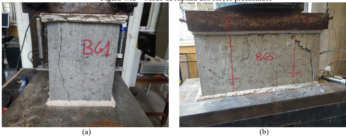
Figura 4.13 – Modo de ruptura dos blocos preenchidos
