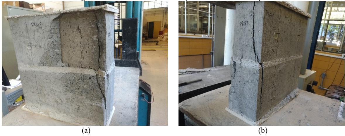
Figura 4.14 – Modo de ruptura dos prismas de dois blocos preenchidos
