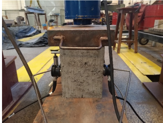
Figura 3.20 – Fixação dos transdutores
