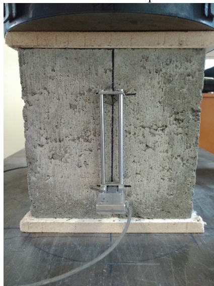
Figura 3.5 – Ensaio de resistência à compressão de um meio-bloco
