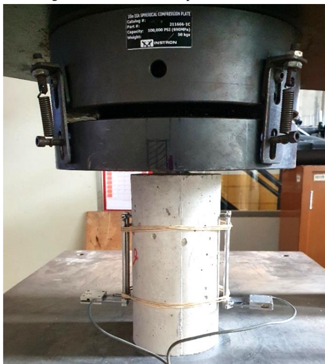
Figura 3.8 - Ensaio de compressão do concreto
