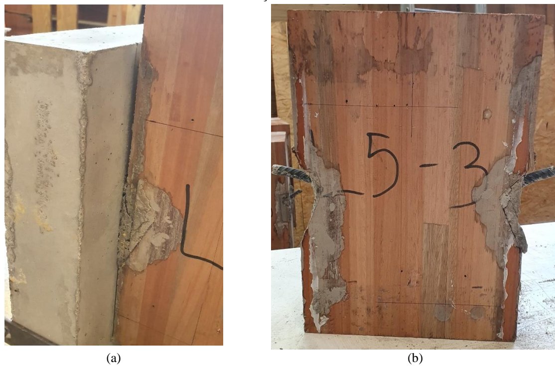
Figura 3.20 – Ruptura ligação L5: (a) Detalhe do cisalhamento do concreto no entalhe; (b) Flexão da barra de aço
