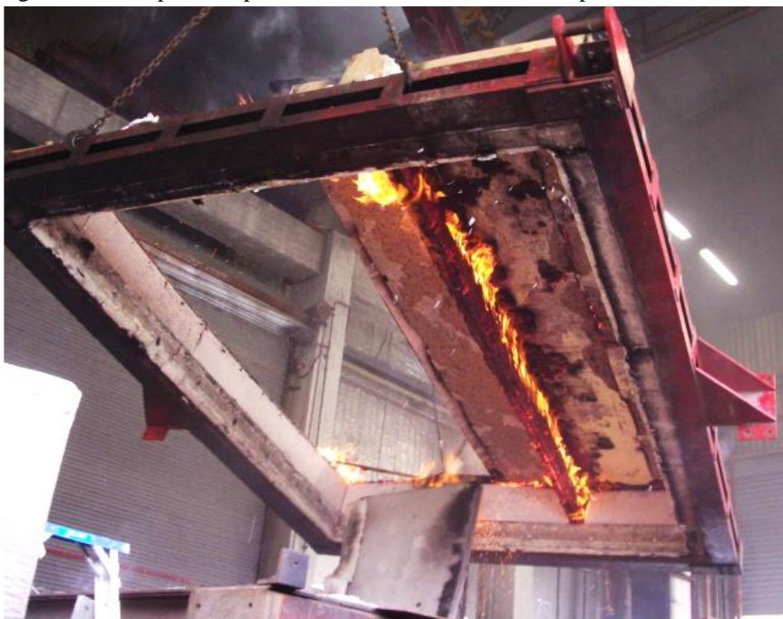
Figura 2.11 - Ruptura do piso misto de madeira e concreto após ensaio de incêndio
