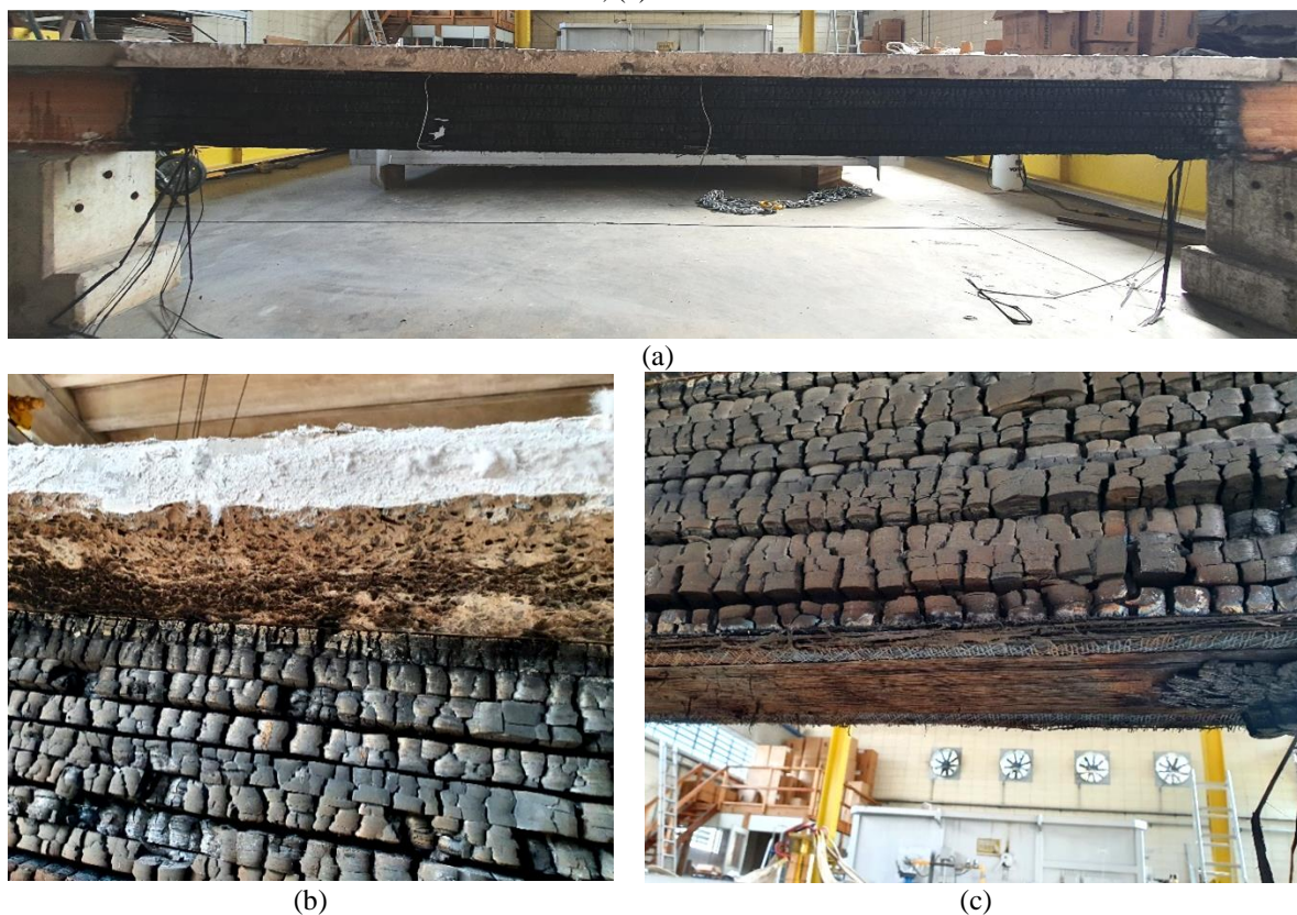
Figura 5.14 – Observações experimentais da viga E10-I-L2-R(P): (a) visão geral no pós ensaio; (b) spalling do concreto; (c) fibra de vidro
