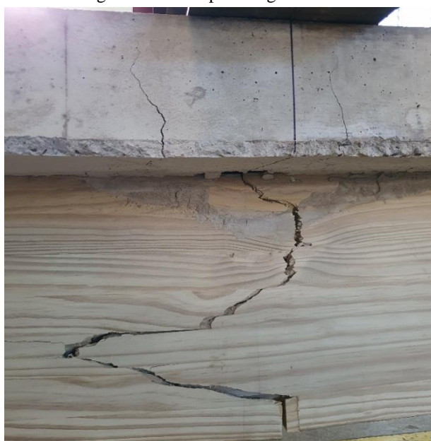
Figura 4.16 – Ruptura viga P1-A-L2
