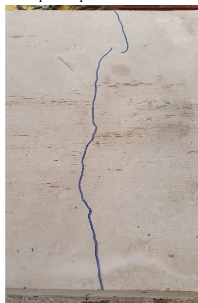
Figura 4.10 – Ruptura viga E1-A-L2: (a) tração da madeira; (b) fissura na parte superior da mesa de concreto
