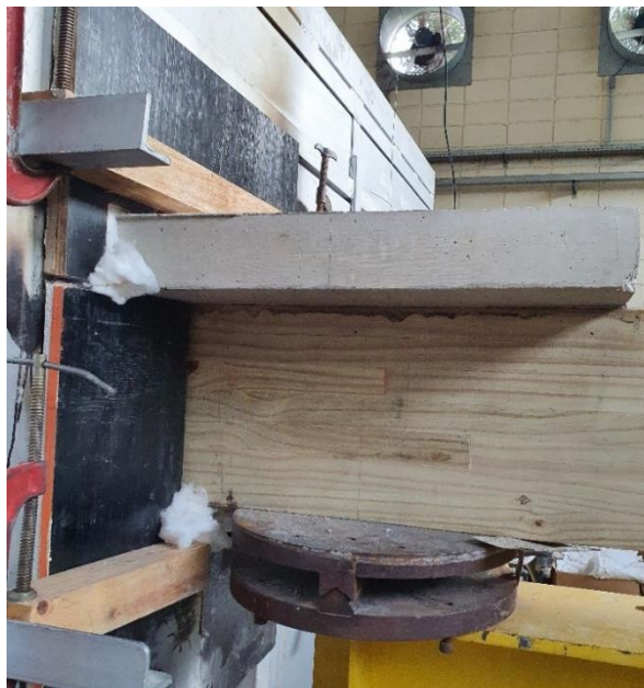
Figura 5.8 – Vedação lateral do forno
