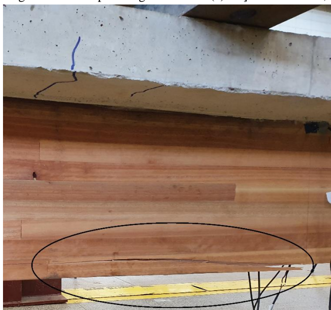
Figura 4.10 – Ruptura viga E1-A-L2: (a) tração da madeira; (b) fissura na parte superior da mesa de concreto
