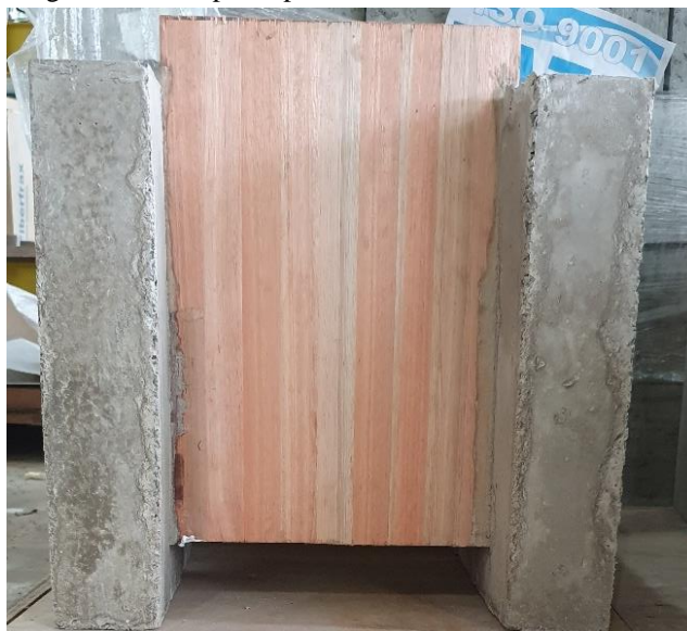
Figura A.6 –Corpo de prova misto de madeira e concreto
