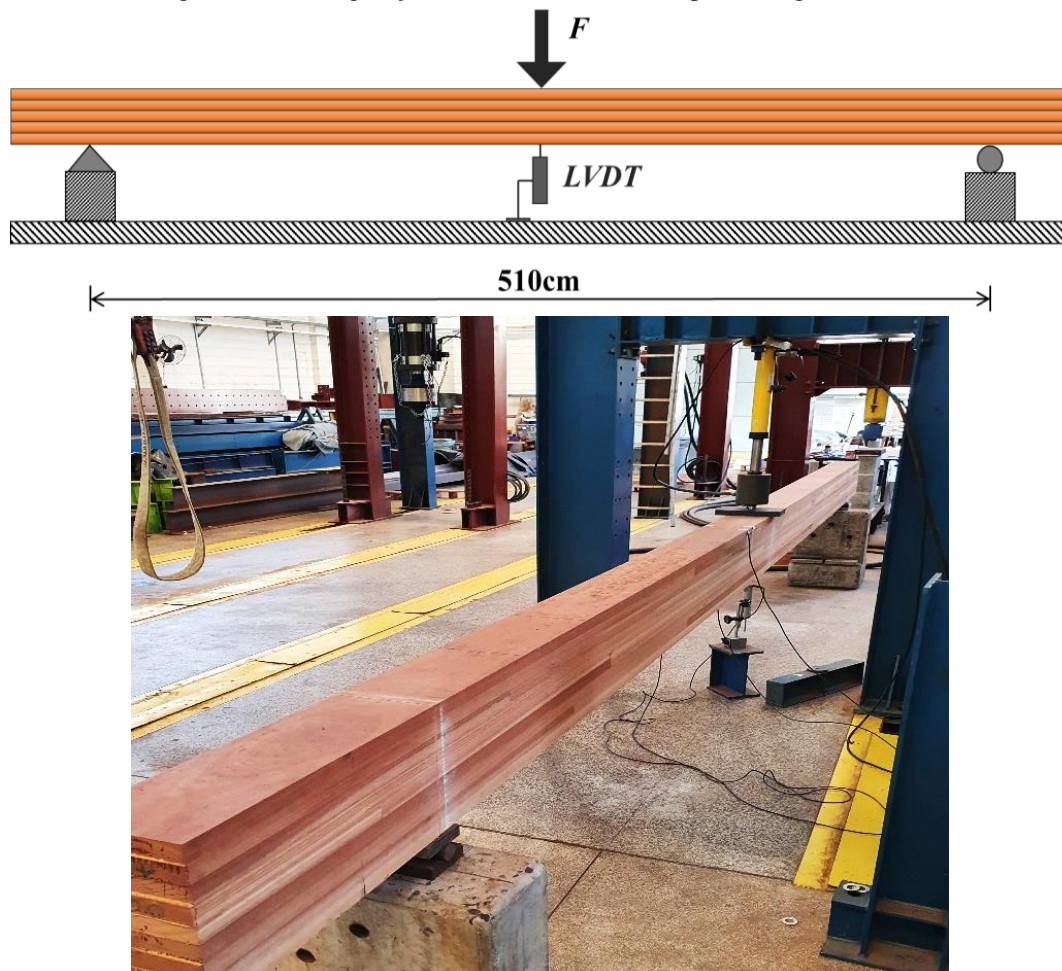
Figura 4.2 - Configuração do ensaio de flexão simples de vigas de MLC
