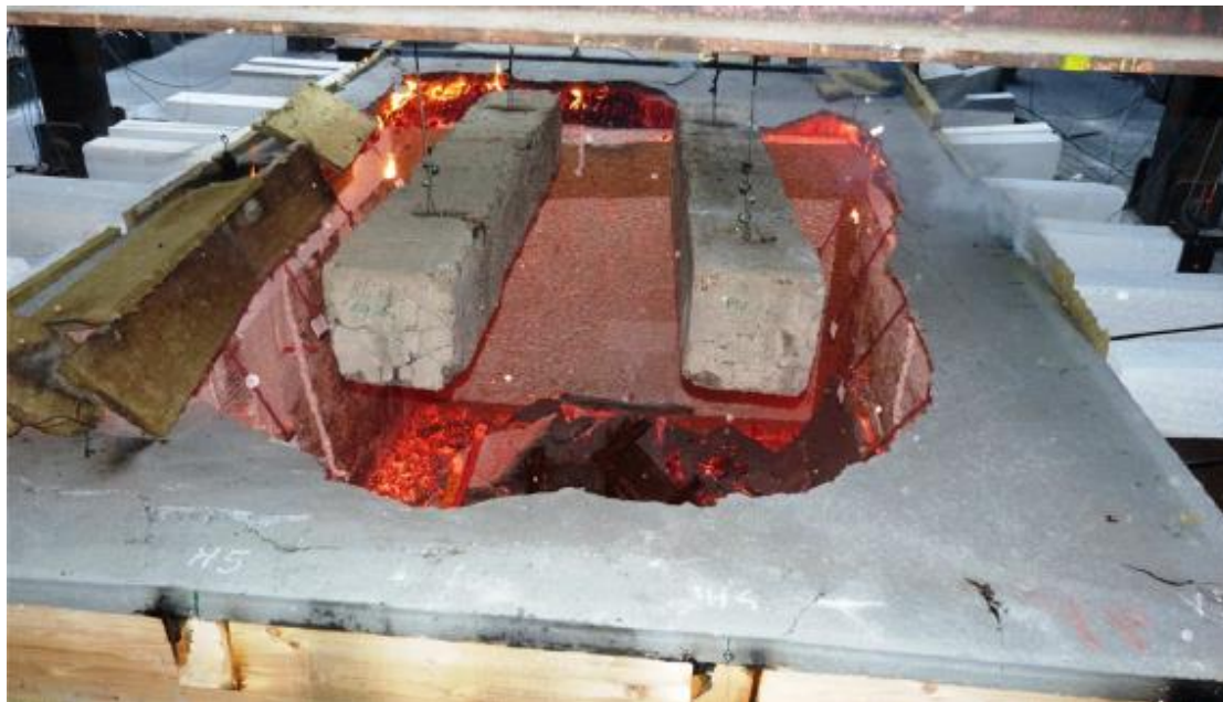
Figura 2.13 – Colapso de piso misto de madeira e concreto após ensaio de incêndio
