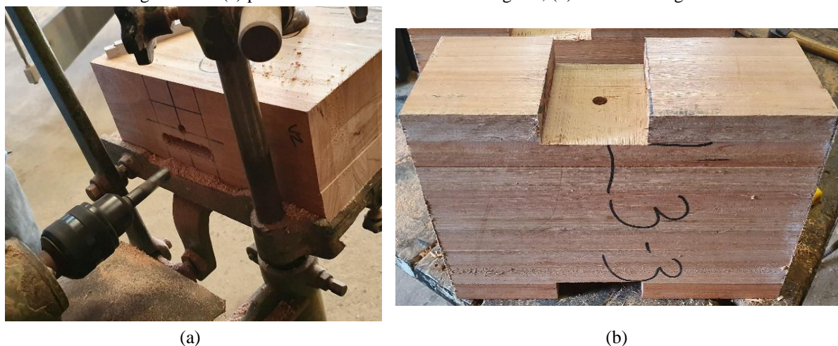
Figura A.2 - (a) processo de corte do entalhe retangular; (b) entalhe retangular.
