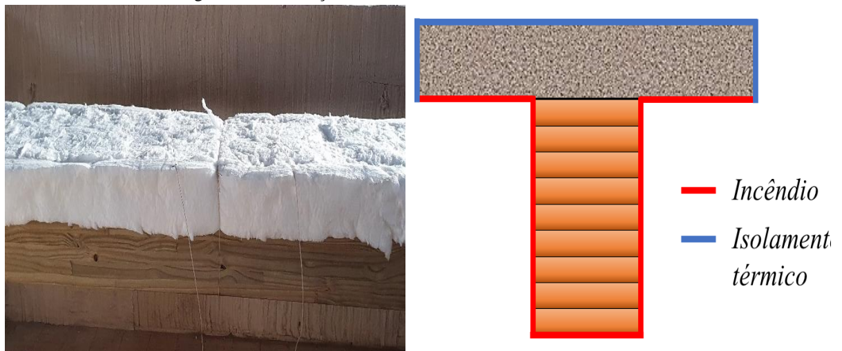
Figura 5.3 – Condições térmicas durante ensaio termoestructural
