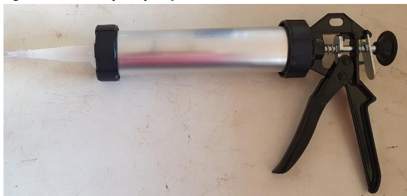
Figura A.3 – Pistola para aplicação do adesivo estrutural nos furos da madeira
