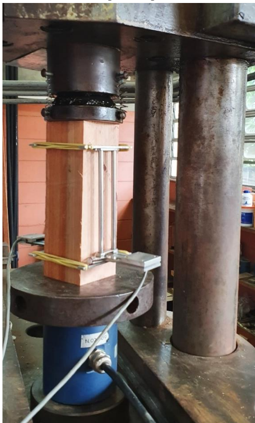
Figura 3.7 – Ensaios de compressão paralela às fibras da madeira
