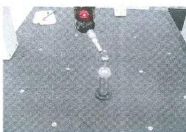
PARA ESTE TESTE FOI UTILIZADA A ESFERA PADRÃO CERTIFICADA DE PROPRIEDADE DA HEXAGON METROLOGY DE DIÂMETRO APROXIMADO DE 25mm, POSICIONADA NO CENTRO DA MÁQUINA, COMO MOSTRA A FOTO AO LADO.
