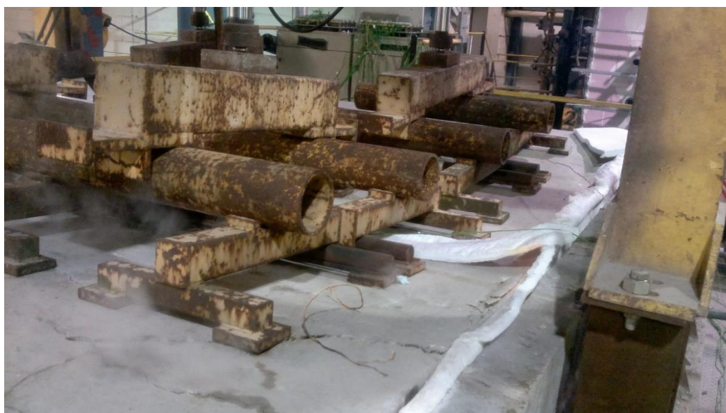
Figura 5.7 - Face não exposta da laje após duas horas de duração do ensaio (Protótipo 1)
