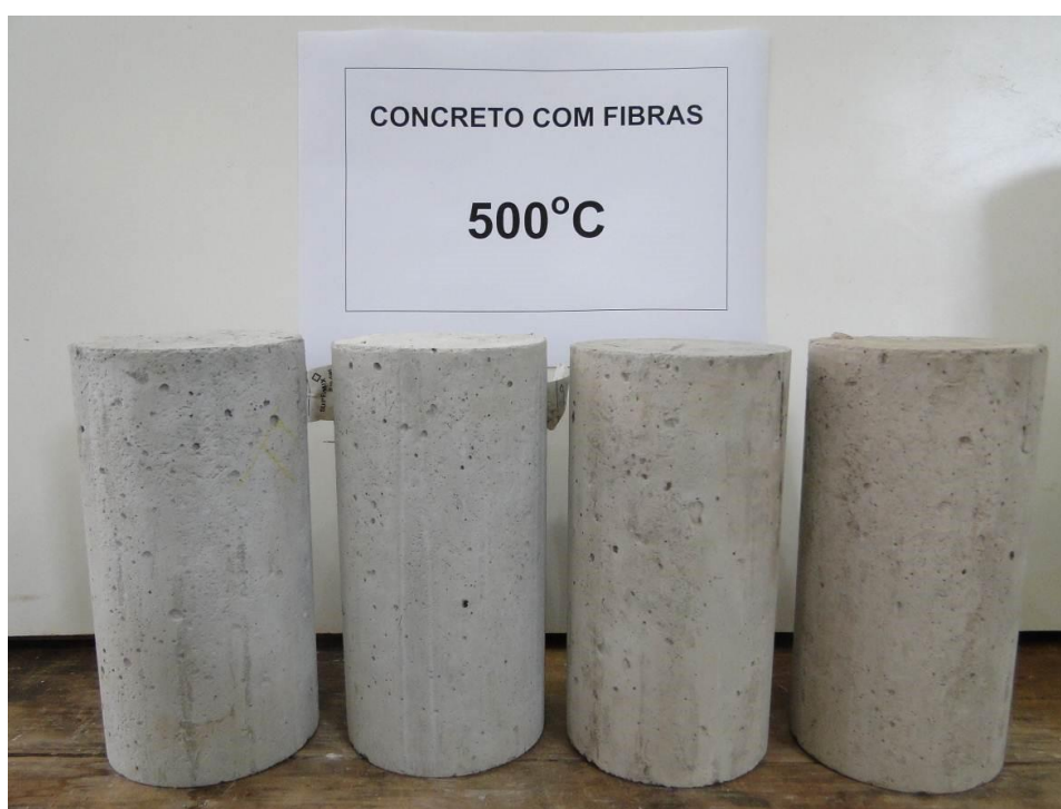
Figura 4.23 - Detalhe dos corpos-de-prova de concreto, com adição de fibras de aço, após aquecimento até a temperatura máxima de 500°C e posterior resfriamento (direita), comparados aos sem aquecimento (esquerda)
