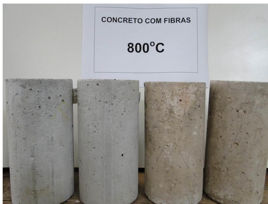
Figura 4.25 - Detalhe dos corpos-de-prova de concreto, com adição de fibras de aço, após aquecimento até a temperatura máxima de 800°C e posterior resfriamento (direita), comparados aos sem aquecimento (esquerda)
