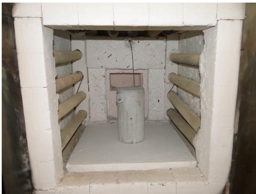
Figura 4.4 - Detalhe do interior do equipamento (Forno) de ensaio para aquecimento dos corpos de prova e posicionamento, dentro do forno, de um corpo-de-prova de concreto antes do aquecimento
