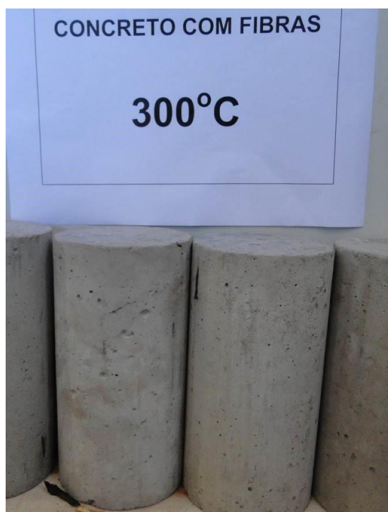
Figura 4.21 - Detalhe dos corpos-de-prova de concreto, com adição de fibras de aço, após aquecimento até a temperatura máxima de 300°C e posterior resfriamento lento
