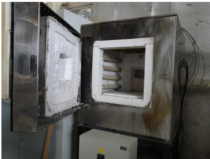
Figura 4.2 - Equipamento para aquecimento (Forno) dos corpos de prova em utilização no Laboratório de Estruturas e Materiais de Construção da FEC – UNICAMP
