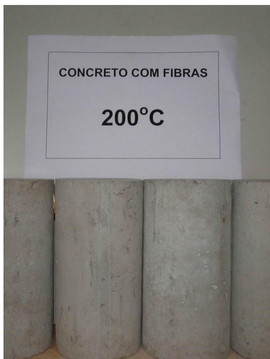
Figura 4.20 - Detalhe dos corpos-de-prova de concreto, com adição de fibras de aço, após aquecimento até a temperatura máxima de 200°C e posterior resfriamento lento
