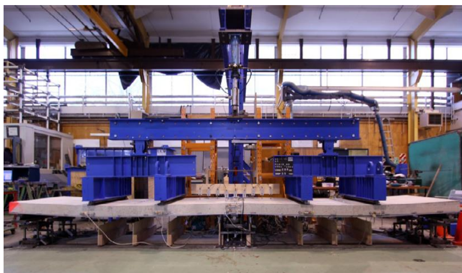
Figura 2.25 - Vista da configuração de ruína do ensaio
