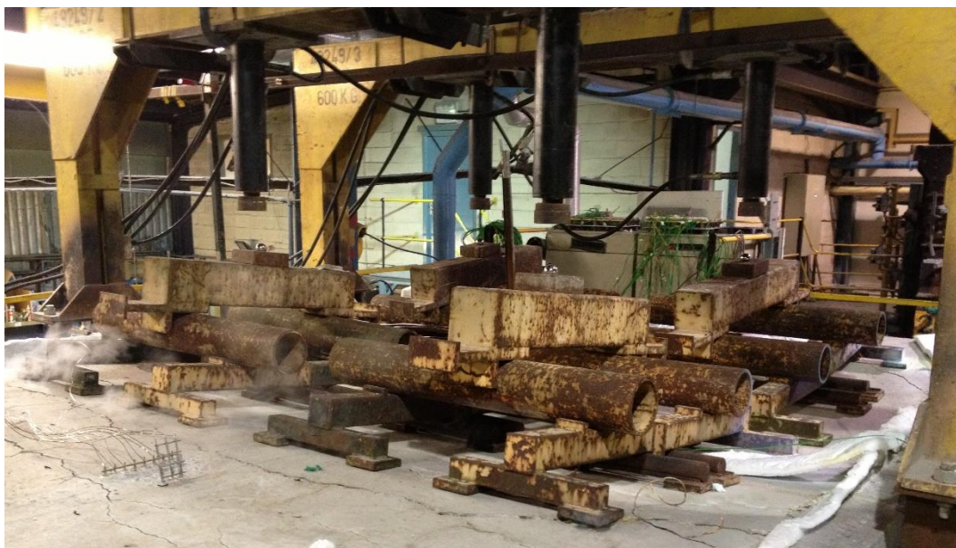
Figura 5.8 - Face não exposta da laje logo após a interrupção do ensaio (Protótipo 1)
