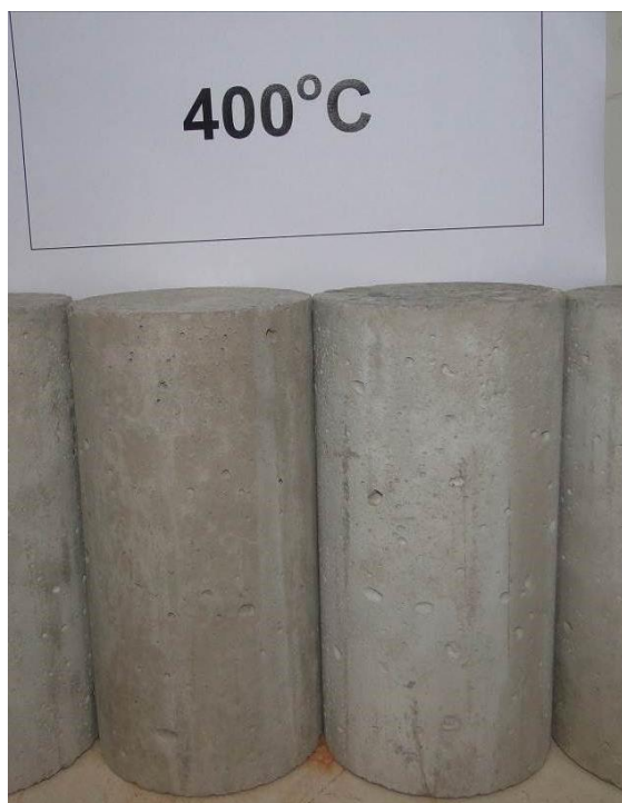
Figura 4.22 - Detalhe dos corpos-de-prova de concreto, com adição de fibras de aço, após aquecimento até a temperatura máxima de 400°C e posterior resfriamento lento
