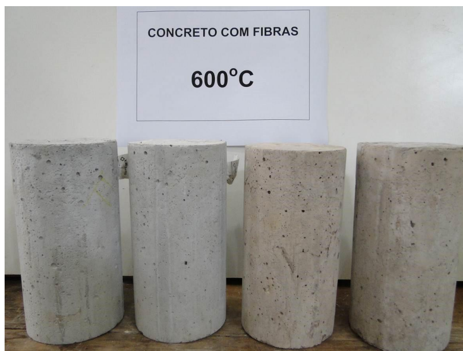
Figura 4.24 - Detalhe dos corpos-de-prova de concreto, com adição de fibras de aço, após aquecimento até a temperatura máxima de 600°C e posterior resfriamento (direita), comparados aos sem aquecimento (esquerda)
