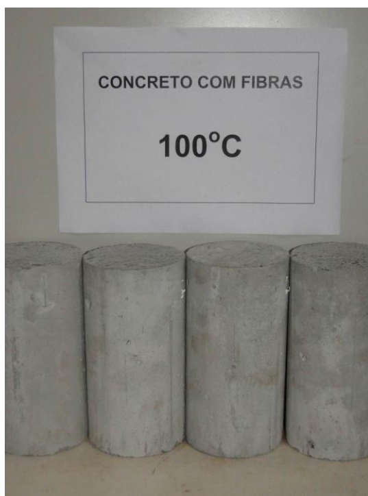
Figura 4.19 - Detalhe dos corpos-de-prova de concreto, com adição de fibras de aço, após aquecimento até a temperatura máxima de 100°C e posterior resfriamento lento
