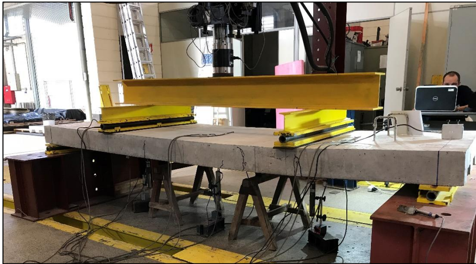
Figura B.3 – Laje 1 ao final do ensaio
