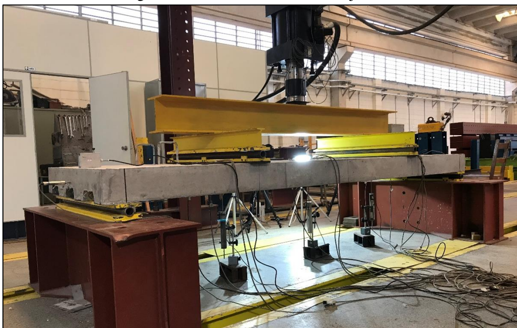
Figura 6.23 – Ensaio de flexão da laje mista
