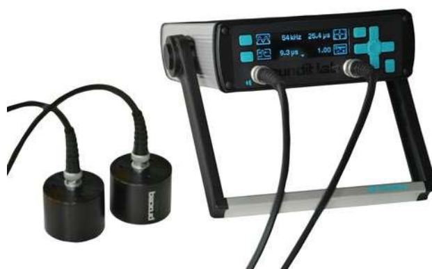
Figura 3.7 - Equipamento para ensaios ultrassônicos Pundit Lab+
