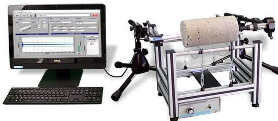
Figura 3.14 - Solução Sonelastic® para ensaio de ressonância acústica
