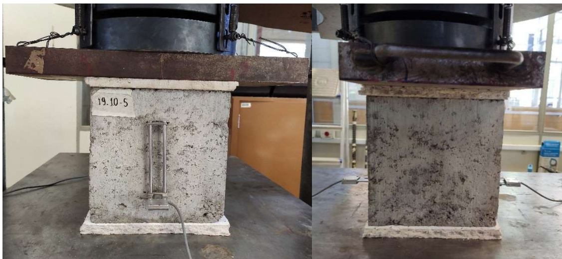
Figura 3.5 - Arranjo de extensômetros para ensaio de compressão (unidades de concreto)
