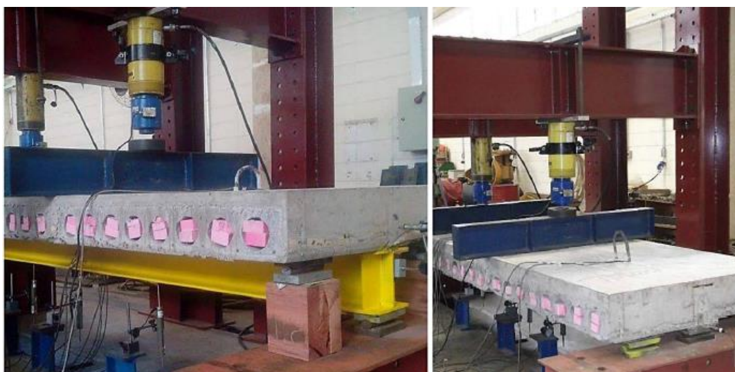
Figura 2.27: Modelo ensaiado por Souza (2016)
