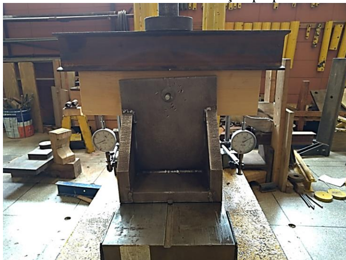
Figura 11 – Ensaio de embutimento na direção perpendicular às fibras.
