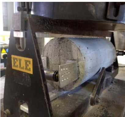
(a) Corpo de prova após a ruptura
