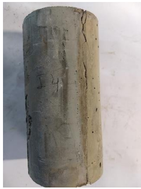
(a) Corpo de prova após a ruptura
