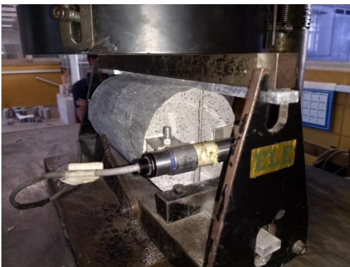
(a) Corpo de prova após a ruptura
