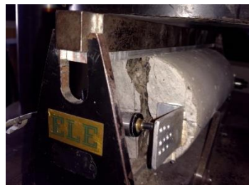
Figura 4.6.8 - Imagem típica do corpo de prova monolítico CAR após a ruptura
