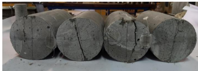
(b) Corpo de prova rompido
