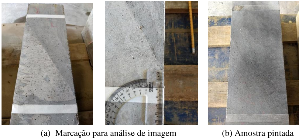
Figura 3.7.12 - Corpo de prova tratado para análise de imagem
