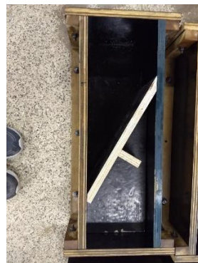
(a) Divisória montada na fôrma
