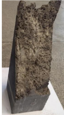
(b) Ruptura no UHPC
