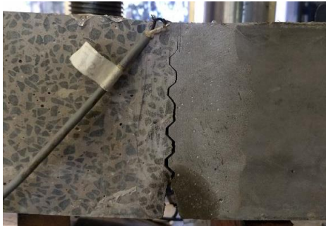
Detalhe da ruptura
