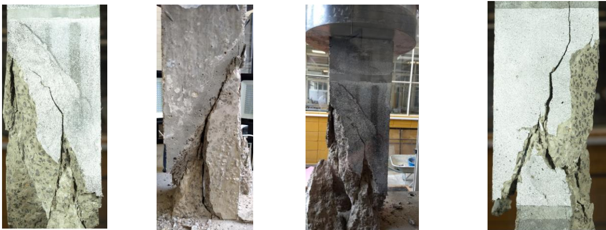
Figura 4.5.8 - Imagem típica da interface Tela (T) que rompeu no CAR
