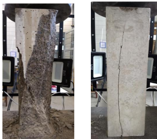
Figura 4.5.11- Imagem típica do corpo de prova monolítico CAR após ruptura
