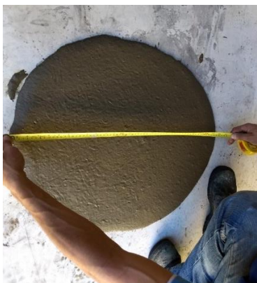
Figura 3.1.5 - Medição do espalhamento do UHPC
