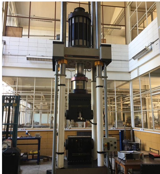
Figura 3.16 - Máquina servo-hidráulica Instron 8506 do Laboratório de Estruturas da EESC
