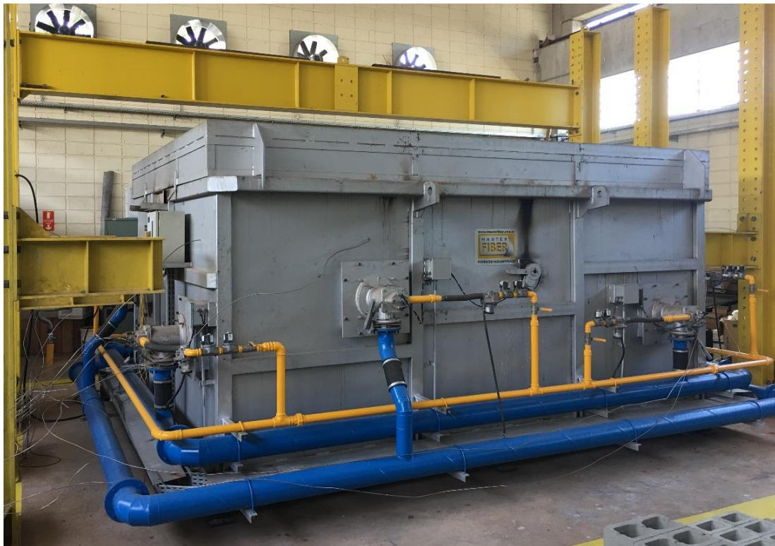
Figura 4.1 - Forno a gás do Laboratório de Estruturas da EESC
