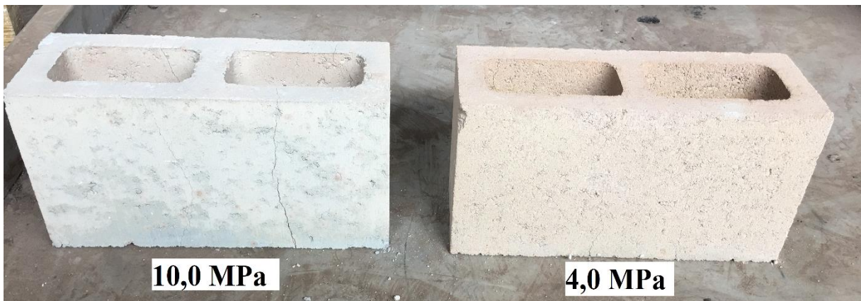
Figura 4.40 - Coloração dos blocos alterada pela ação térmica
