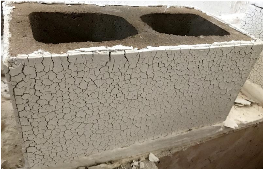
Figura 4.43 - Situação dos blocos de 4,0 MPa antes do ensaio de compressão simples pós-fogo
