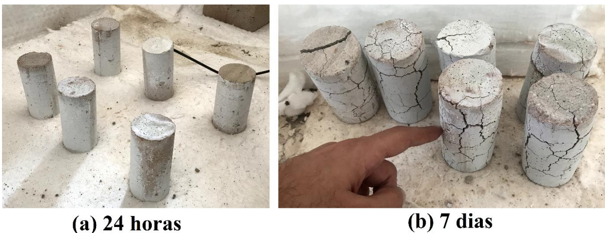
Figura 4.25 - Situação dos corpos de prova de argamassa pós-fogo
