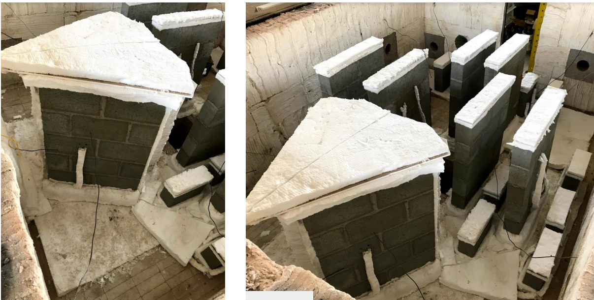
Figura C.6 - Preparação da primeira fornada (posicionamento dos corpos de prova)
