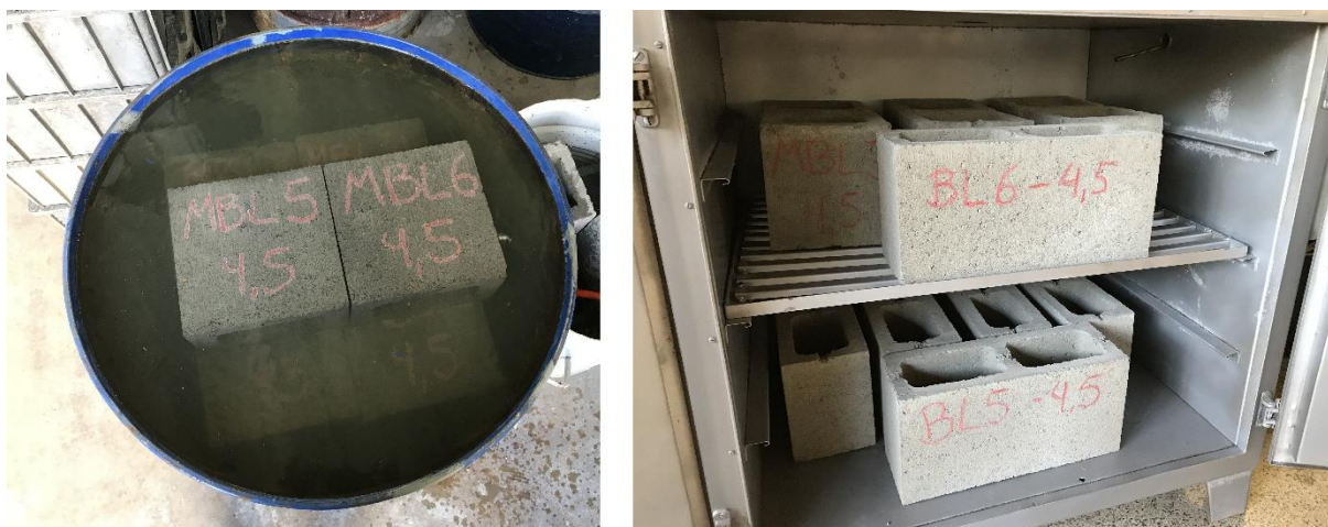
Figura 3.6 - Procedimento de saturação e secagem em estufa, para determinação do índice de absorção
