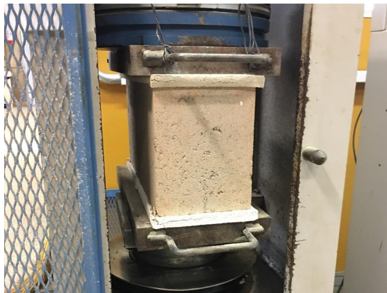
Figura 4.26 - Ensaio de compressão pós-fogo dos blocos
