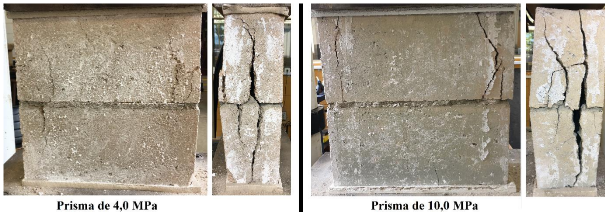
Figura 4.44 - Modo de ruptura dos prismas com revestimento de gesso (2ª Fornada)
