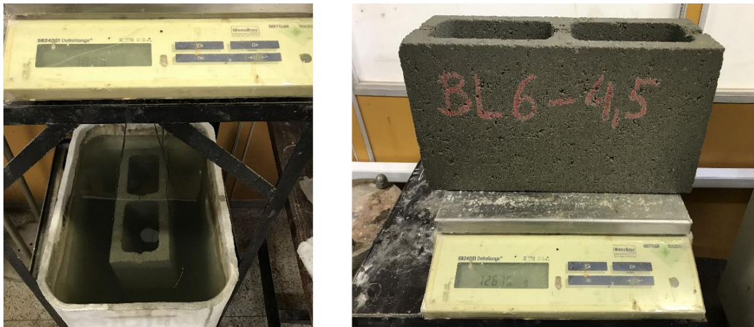
Figura 3.5 - Determinação da massa aparente e massa saturada
