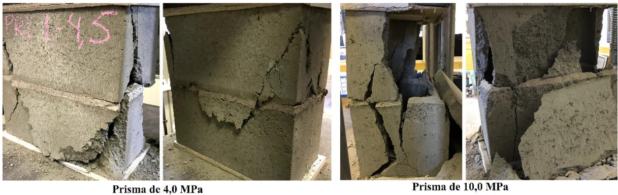
Figura 3.19 - Modo de ruptura dos prismas de 4,0 MPa
