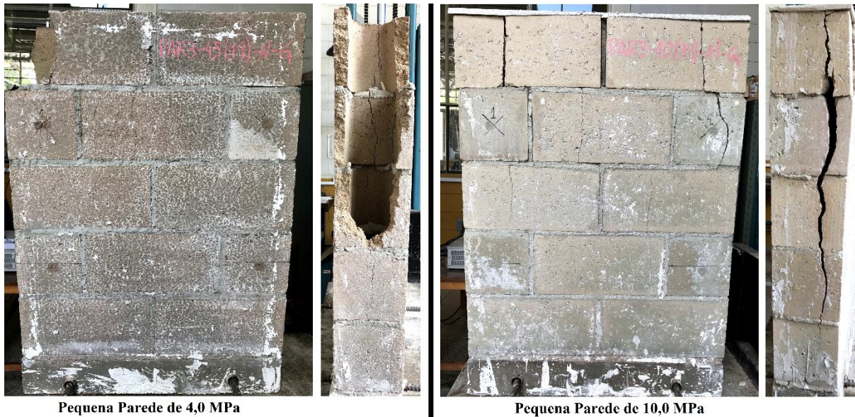
Figura 4.45 - Modo de ruptura das pequenas paredes pós-fogo (2ª Fornada)
