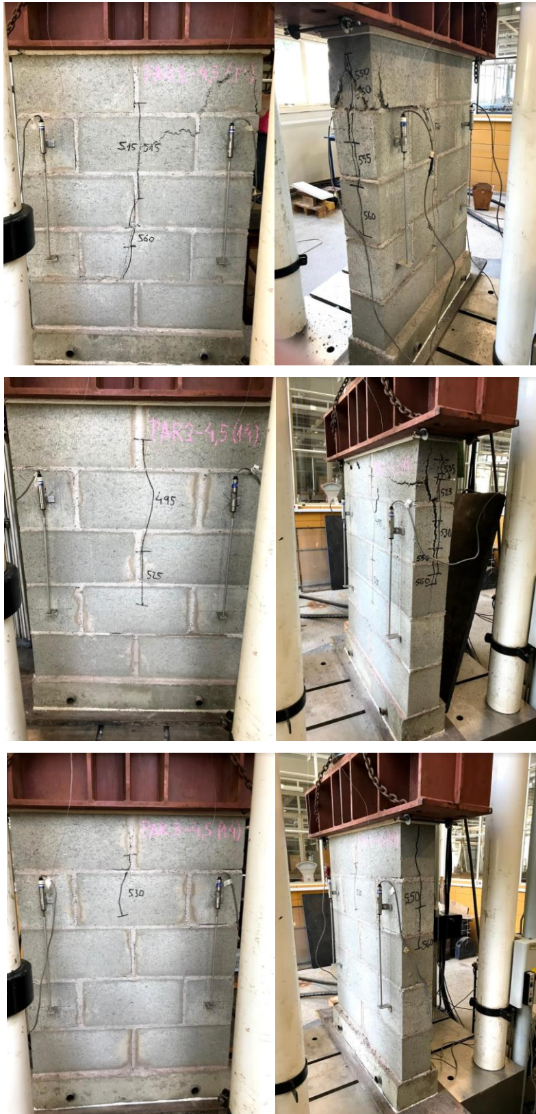
Figura B.5 – Ensaio de compressão das pequenas paredes de 4,0 MPa e 140 mm
