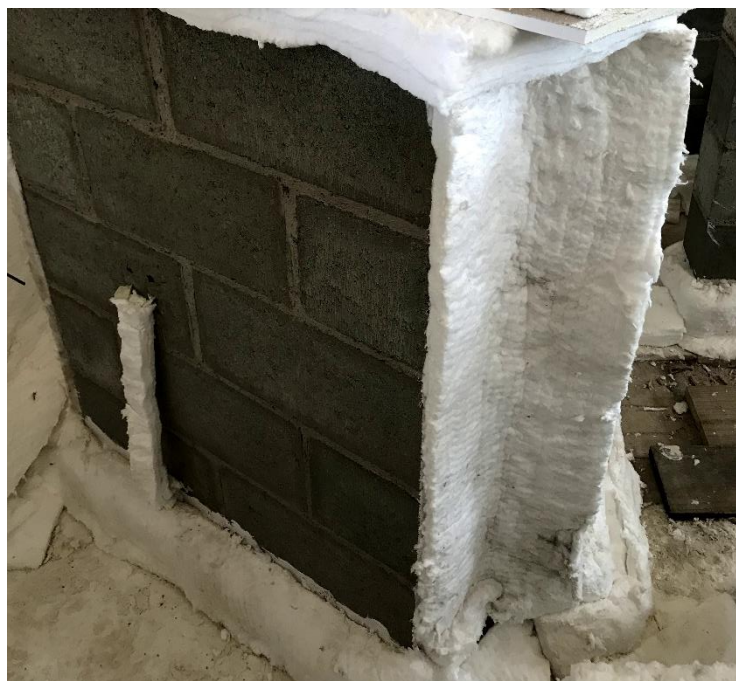
Figura 4.14 - Isolamento lateral do trio de pequenas paredes com manta cerâmica
