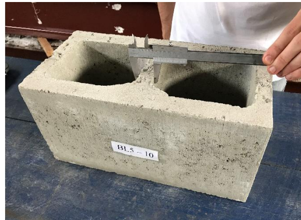
Espessura do septo
