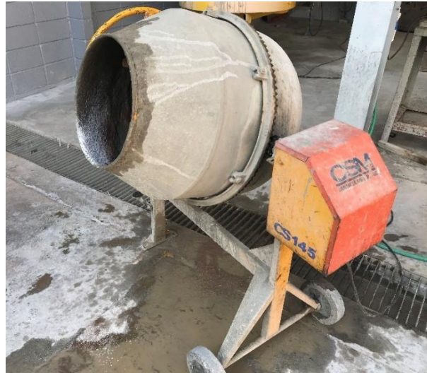
Figura 3.10 - Misturador mecânico de eixo inclinado utilizado na confecção da argamassa
