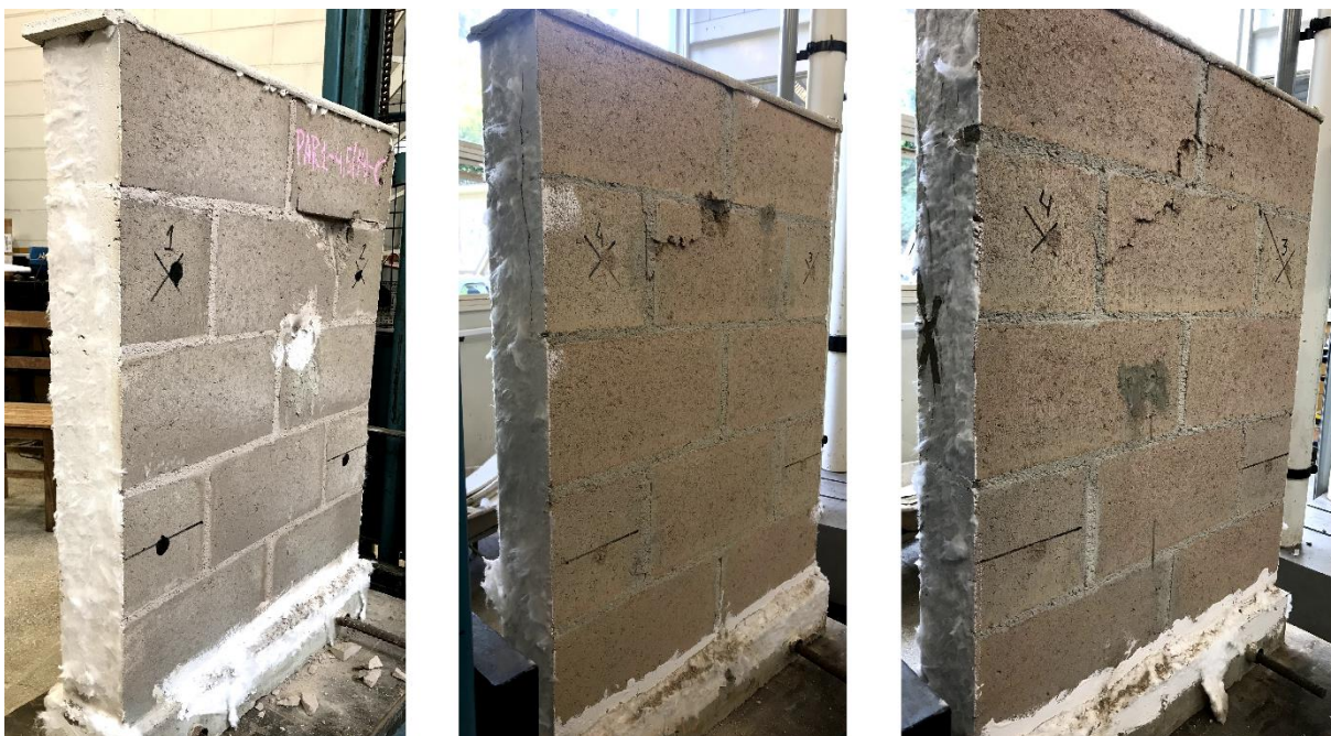
Figura 4.31 - Modo de ruptura das pequenas paredes compartimentadas da 1ª Fornada
