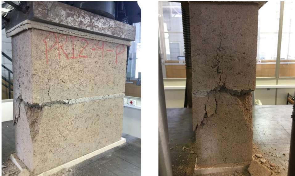
Figura 4.28 - Ruptura dos prismas após ação do fogo (1ª fornada)
