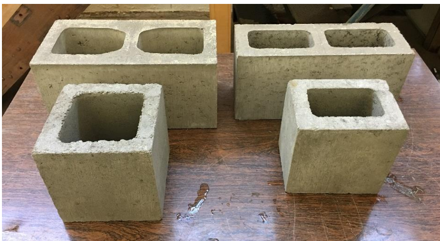
Figura 3.1 - Variações de blocos e meios-blocos para a resistência de 10,0 MPa.
