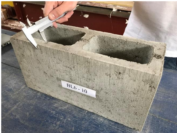
Espessura da parede longitudinal
