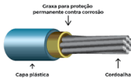
Figura 7 – Cordoalha engraxada, utilizada na pós-tração sem aderência. Representação da bainha de PEAD, da graxa inerte e da cordoalha. Fonte: Impacto Protensão (2019).
