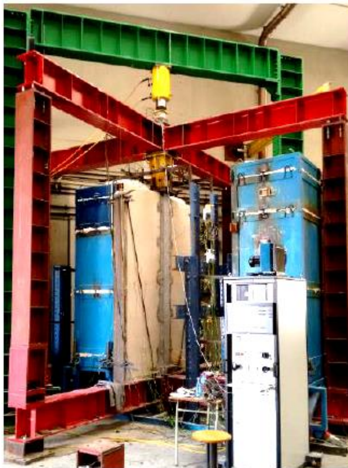
Figura 2.20- Sistema completo utilizado por Rocha (2016) em seu ensaio experimental de um pilar em contato com paredes
