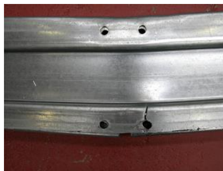
(b) Ruptura da mesa tracionada da luva.
