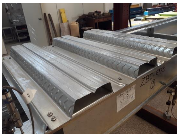
Foto 3.5 – Travamentos de steel deck.
