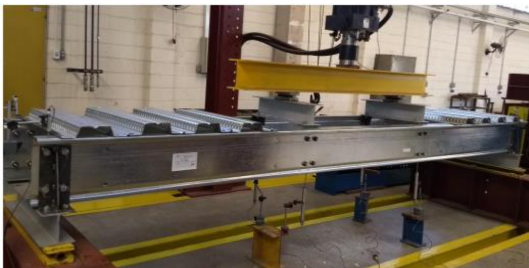
(b) Ensaio de flexão de quatro pontos – Análise de momento fletor.
