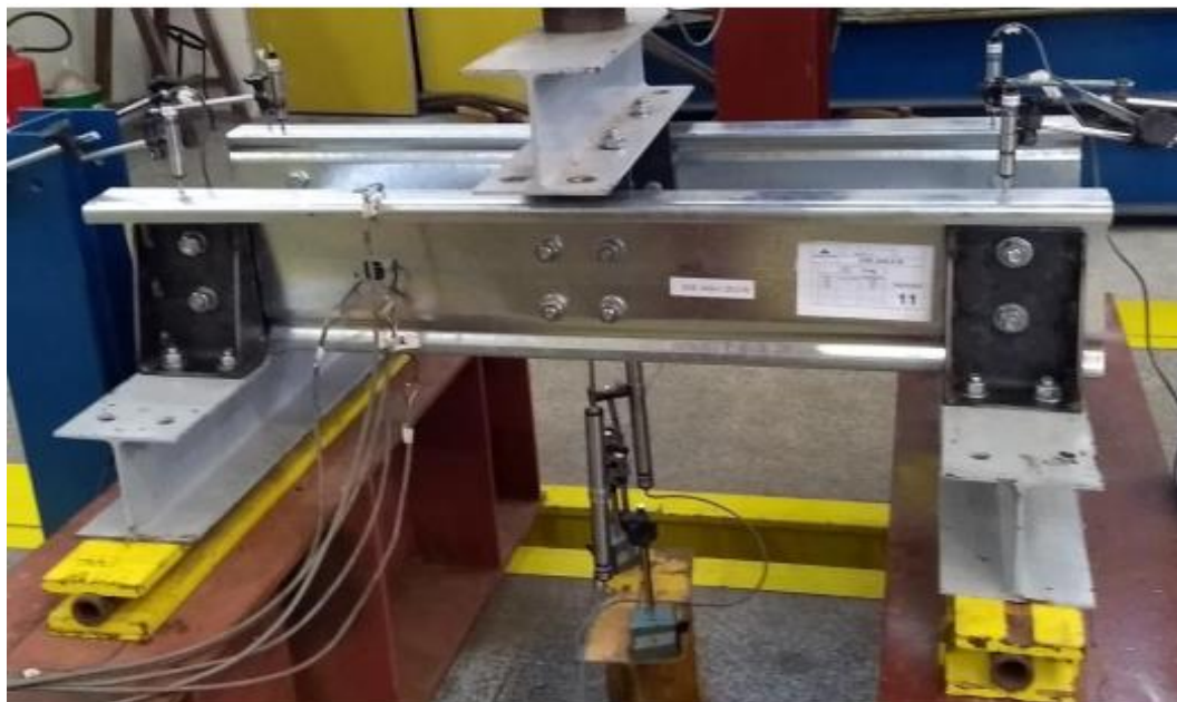
(a) Ensaio de flexão de três pontos – Análise de força cortante e interação M-V.
