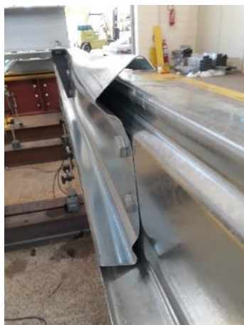
(a) Início da falha com distorção no final da luva (ZAL – 86125).
