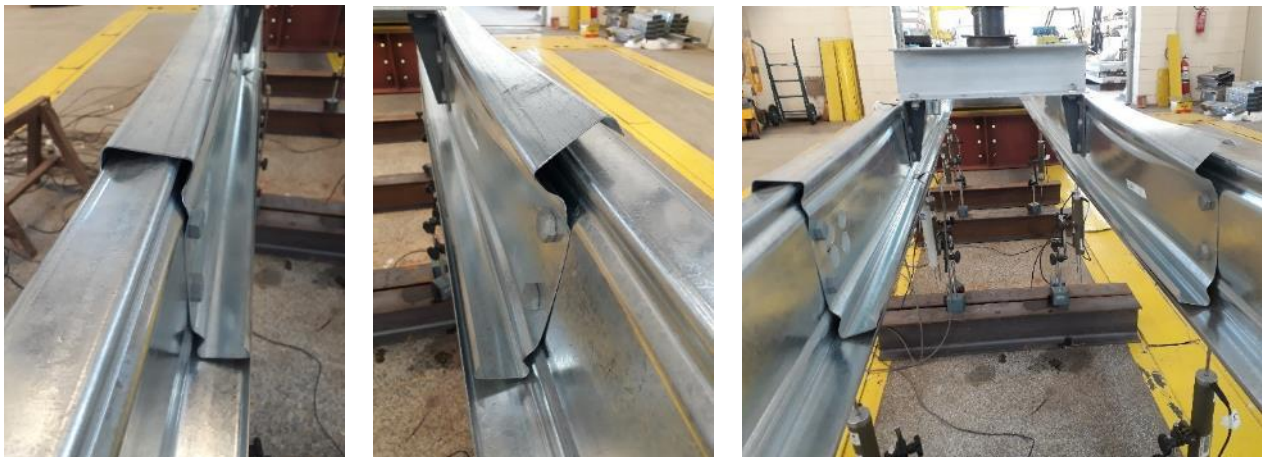
(b) Depois do ensaio (perfil do lado esquerdo e direito) e visão geral.
