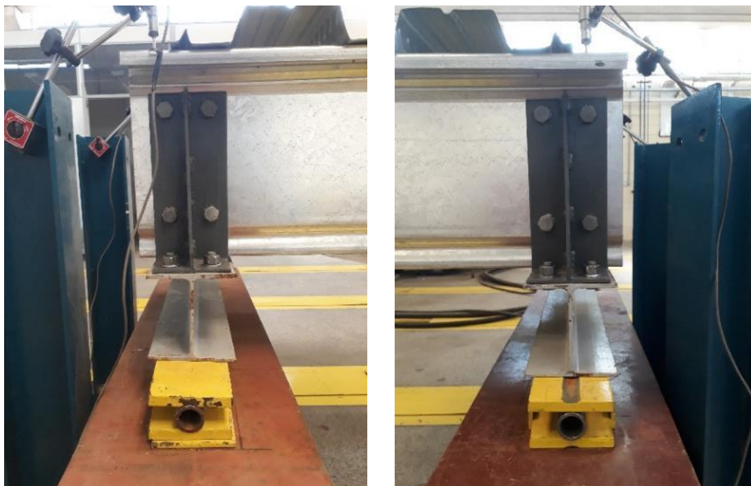
Foto 3.4 – Montagem dos apoios.
