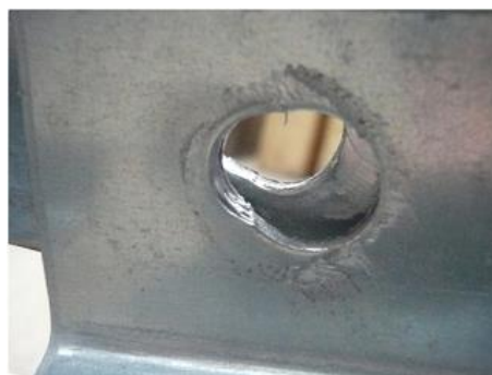
(d) Deformação da parede do furo.
