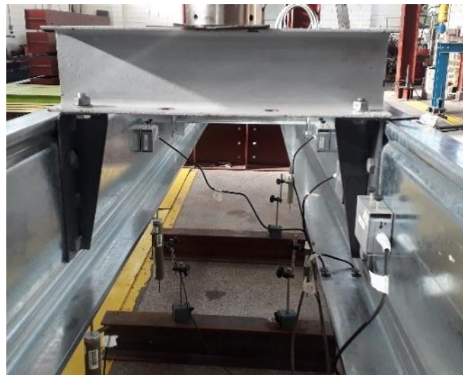
Foto 3.2 – Montagem da aplicação da força.
