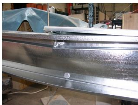
(a) Instabilidade local na alma da terça.
