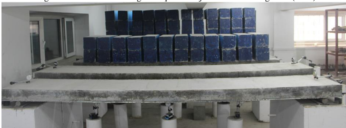
Figura 2.17 – Ensaio de longa duração das lajes mistas de Wang et al. (2016)
