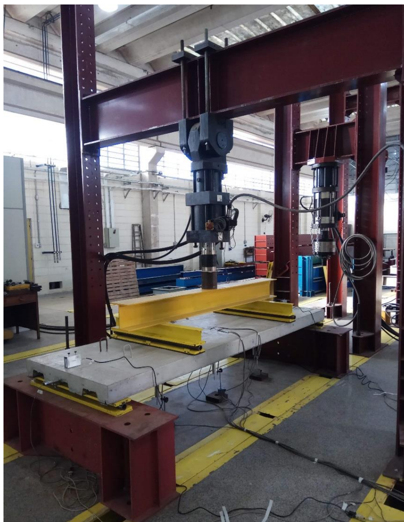
Figura 7.22 – Ensaio da laje mista L3-MD125-ST
