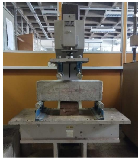
(b) Ensaio de tração na flexão
