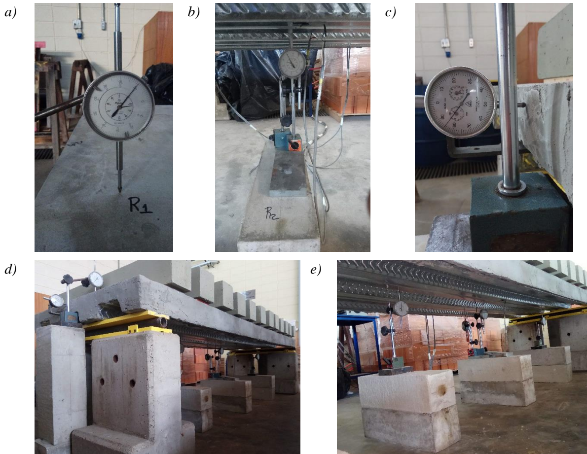
(a) Relógio comparador R1=R4 (sobre apoio); b) Relógio R2=R3 (meio do vão); c) Relógio R5=R6 (deslizamento de extremidade); d) Perspectiva dos relógios comparadores pelo lado esquerdo; e) Linha de relógios comparadores para medição dos deslocamentos verticais.
