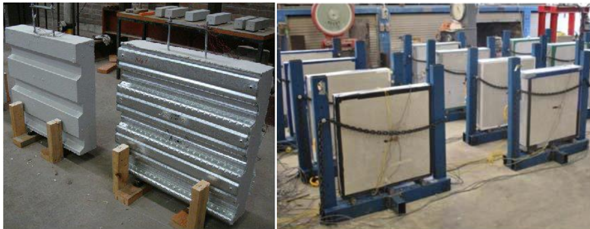
Figura 2.6 – Visão do ensaio de monitoramento da retração
