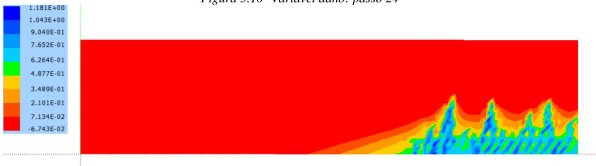
No último passo de carga, Figura 5.11, a estrutura encontra-se extremamente danificada. É interessante notar que as regiões de aplicação da força e do apoio também foram danificadas. Uma última observação relevante é o comportamento das fissuras próximas ao apoio. Nesta região, a danificação foi inclinada de, aproximadamente,  $45^\circ$ . Esse comportamento é característico de fissuras por cisalhamento e a representação obtida é compatível com o comportamento esperado em um ensaio experimental.
