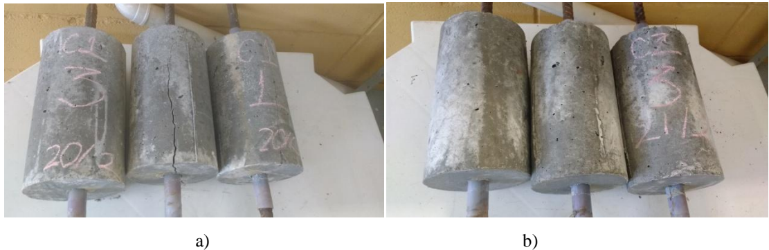
Figura 70-Tipos de ruptura: a) Fendilhamento (modelo C-D8) b) Arrancamento (modelo CF-D8)
