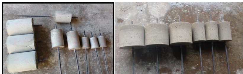
Figura 57- Modelos do ensaio piloto e ensaio definitivos desformados
