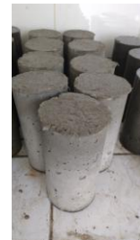
Figura 30-Corpos-de-prova de concreto com fibras armazenados na câmara úmida
