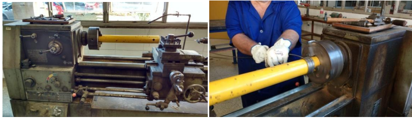
Figura 48-Confeccção das armaduras com auxílio do torno
