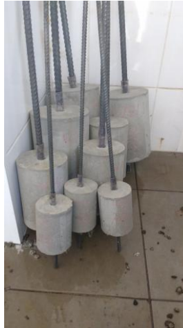
Figura 58-Cura dos modelos na câmara úmida
