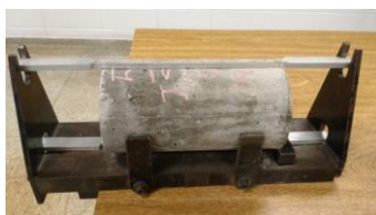
Figura 33-Aparato utilizado para determinação da resistência à tração
