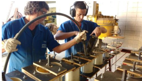
Figura 55-Adensamento dos modelos feito com vibrador de imersão
