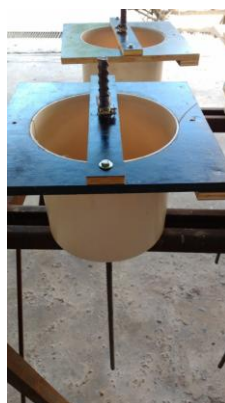
Figura 52-Modelos travados pela abraçadeira metálica
