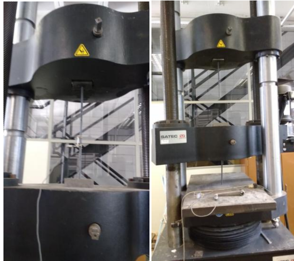
Figura 37-Ensaio de resistência à tração das barras
