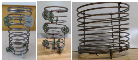
Figura 49-Armadura transversal para os corpos-de-prova de diâmetro a) 8 \phi , b) 9 \phi e c) 15 \phi
