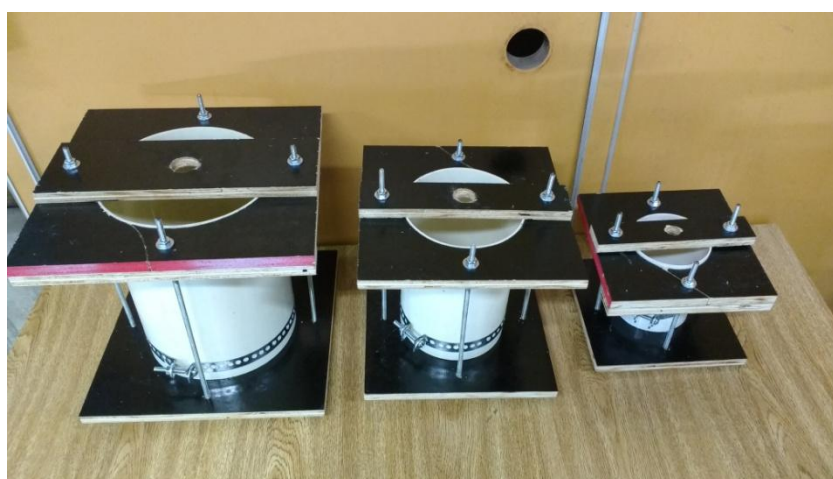
Figura 43- Fôrmas para os modelos do ensaio piloto
