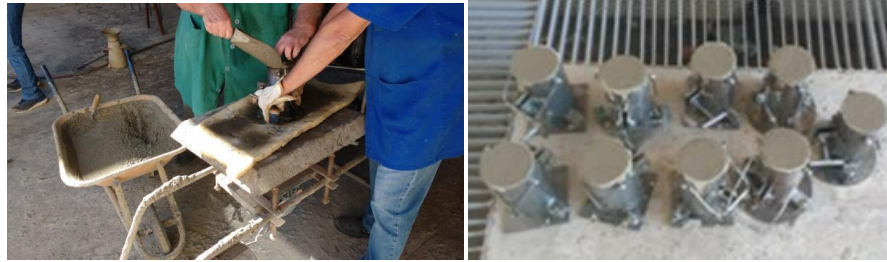
Figura 28- Moldagem e adensamento dos corpos-de-prova em mesa vibratória
