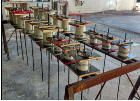
Figura 53-Modelos do ensaio piloto posicionados para serem concretados
