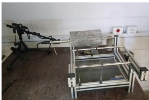
Figura 36- Ensaio de determinação do módulo de elasticidade dinâmico com o Sonelastic
