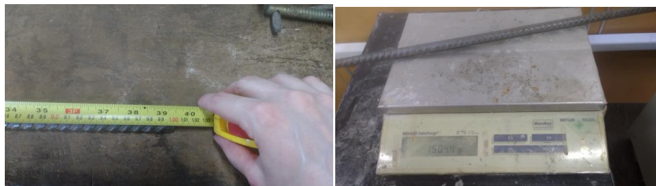
Figura 39-Aferição do comprimento e massa da barra
