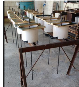
Figura 54- Parte dos modelos do ensaio definitivo posicionados para serem concretados
