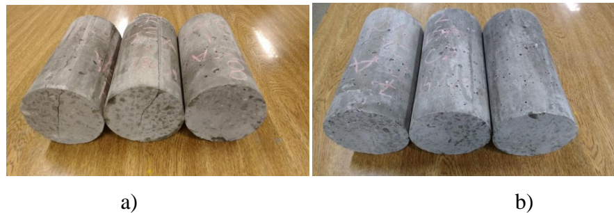
Figura 35-Corpos-de-prova de concreto após o ensaio de resistência à tração, sendo a) sem fibras e b) com fibras
