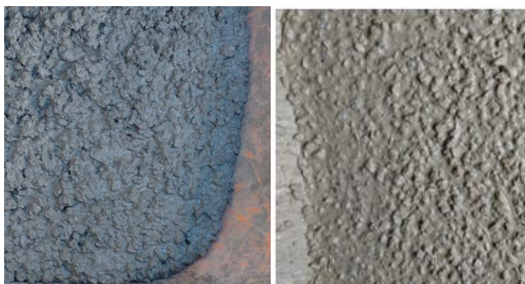
Figura 24-Concreto sem fibras e concreto com fibras
