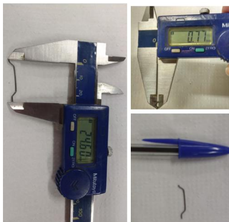
Figura 23- Caracterização da fibra metálica
