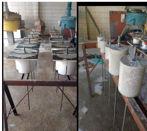
Figura 56- Modelos já concretados e parte desformados
