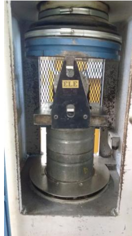
Figura 34-Aplicação do carregamento para determinação da resistência à tração
