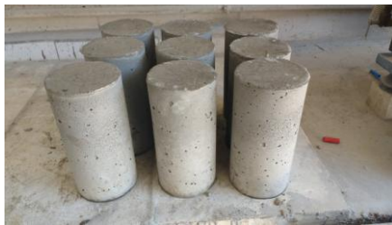
Figura 29-Desmoldagem dos corpos-de-prova de concreto sem fibras
