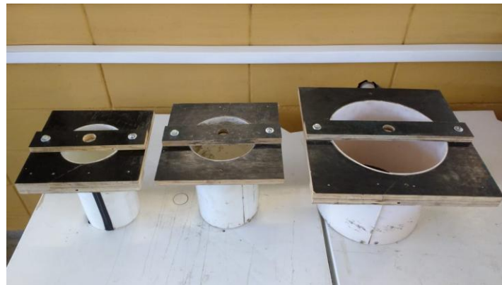
Figura 45-Fôrmas para os modelos do ensaio definitivo
