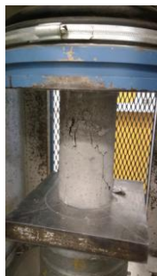
Figura 31-Aplicação do carregamento uniaxial para determinação da resistência à compressão
