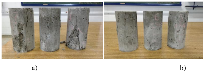
Figura 32-Corpos-de-prova de concreto após o ensaio de resistência à compressão, sendo a) sem fibras e b) com fibras
