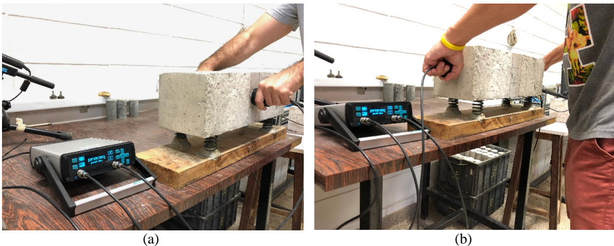
Figura 14 – Esquema de ensaio de velocidade ultrassônica: (a) medida transversal; (b) medida longitudinal.
