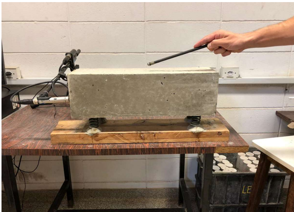
Figura 3.28 – Exemplo do método de obtenção do módulo de elasticidade a partir de vibração flexional.
