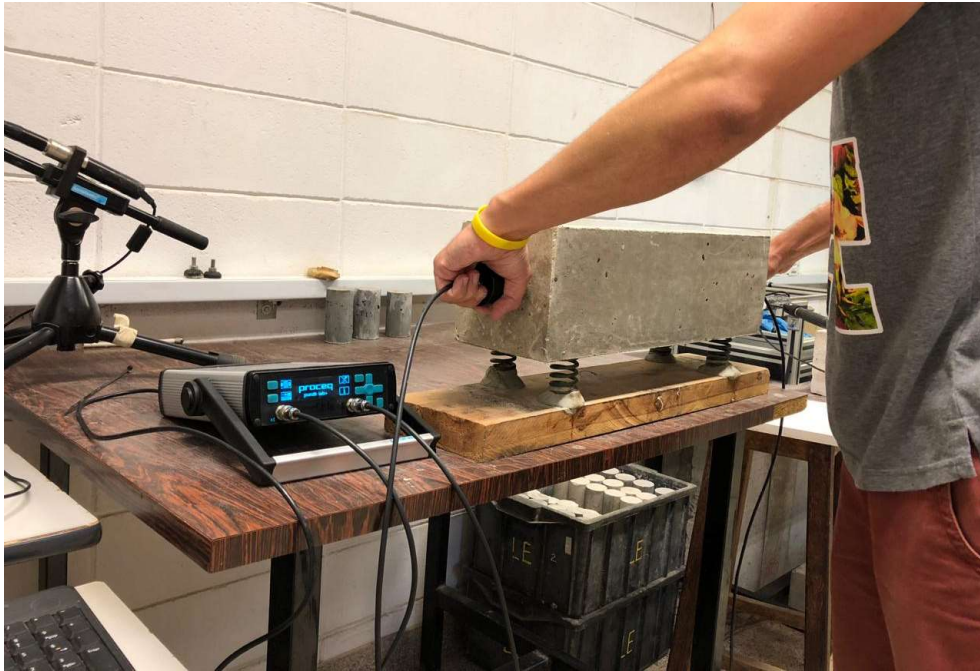
Figura 3.30 – Exemplo do método de obtenção de velocidades para pulso ultrassônico na direção longitudinal de prisma de concreto.
