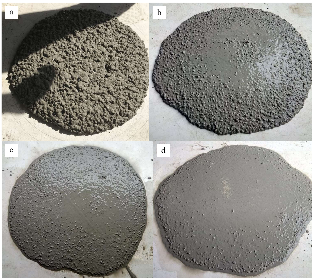
Figura 4.4 – Concreto classe C25 – Compilado dos espalhamentos obtidos para os diferentes volumes de pasta considerados: 36% (a), 38% (b), 40% (c) e 42% (d).
