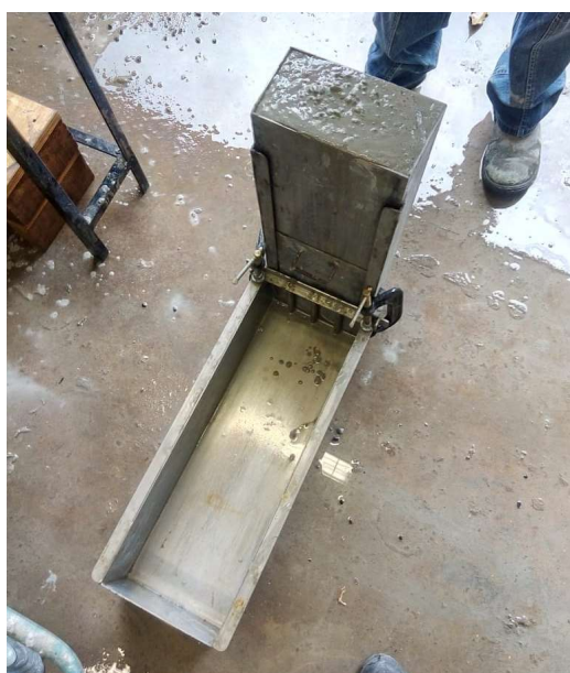
Figura 3.20 – Exemplo do ensaio de Caixa L em andamento antes da abertura da comporta.
