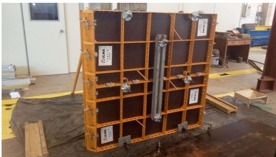
Figura 3.34 – Vista frontal do posicionamento das fôrmas em laboratório.
