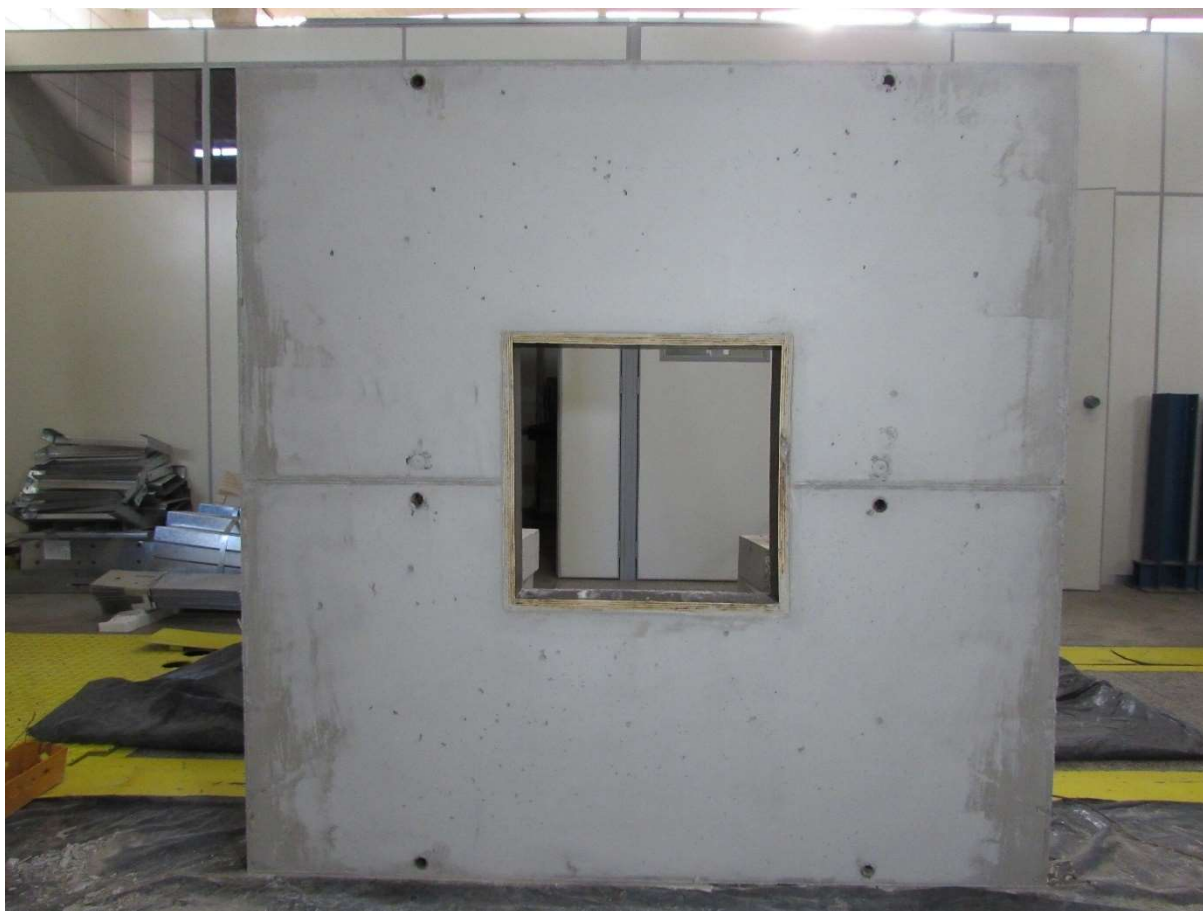
Figura 4.24 – C40 9% – Parede concretada.
