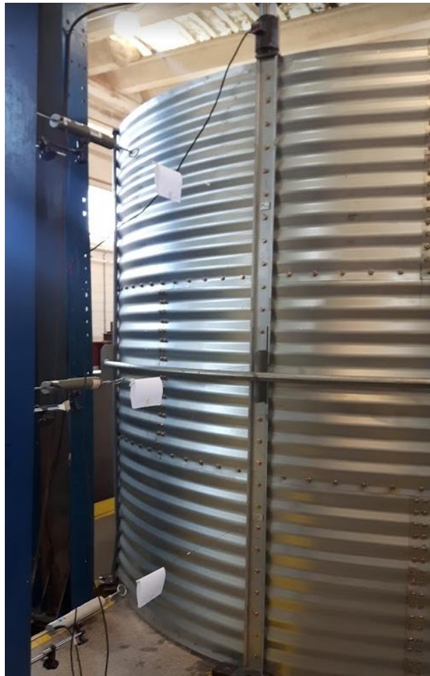
Figura 5.22 – Montagem do anel de vento
