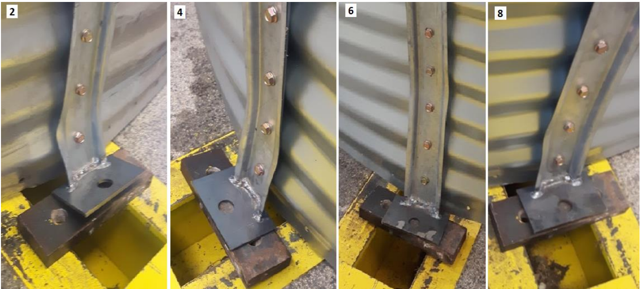
Figura 6.7 – Montantes pares após ensaio
