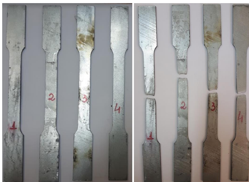
Figura 6.5 – Modos de ruptura dos corpos de prova
