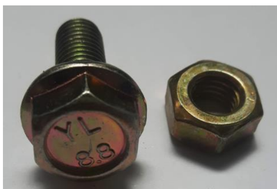
Figura 5.12 – Parafuso e porca usados na ligação das chapas e montantes
