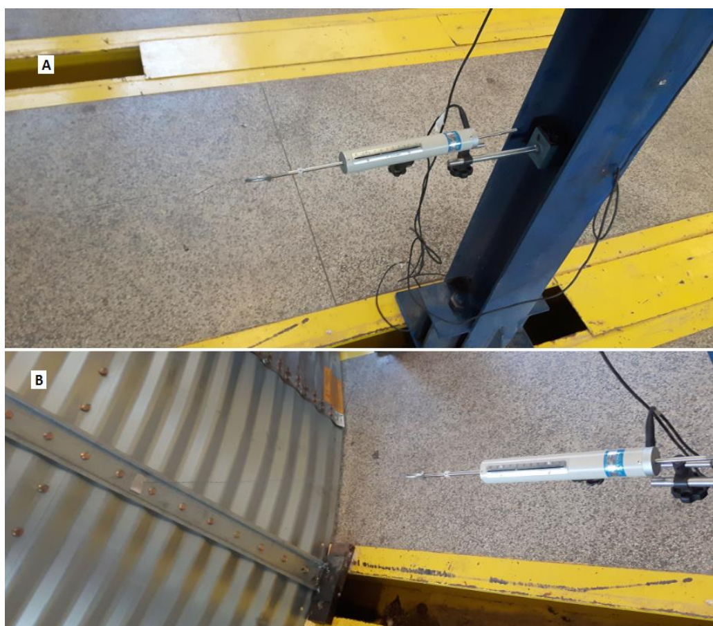
Figura 5.18 – Instrumentação dos transdutores
