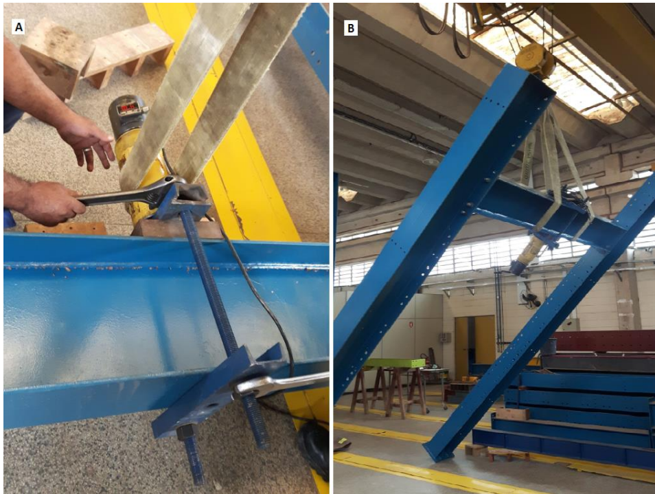
Figura 5.16 – Fixação da célula de carga e içamento do pórtico
