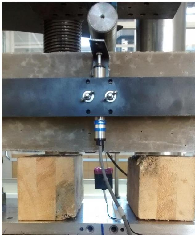
Figura 3.12 – Fixação do Clip Gage para controle da abertura de fissura na extremidade inferior do entalhe
