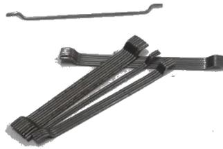
Figura 3.2 – Fibras de aço utilizadas
