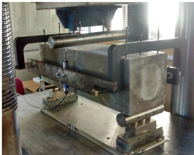
Figura 3.11 – Ensaio de flexão em três pontos com entalhe
