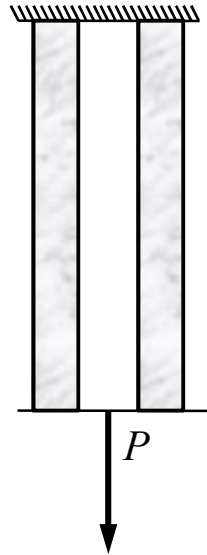
Figura 4: Exemplo de sistema estrutural com elementos associados em paralelo e redundância ativa.
