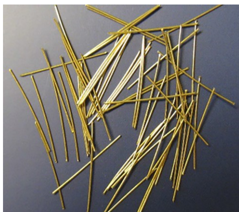
Figura 2.3 – Fibras de aço lisas e curtas geralmente utilizadas no UHPFRC
