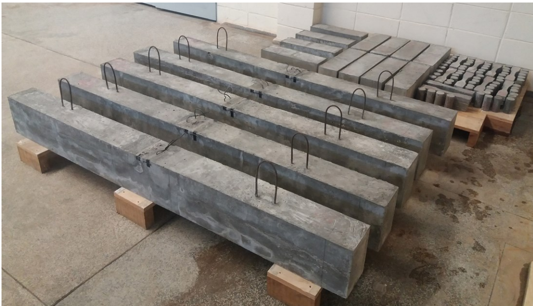
Figura 3.8 – Vigas e corpos de provas de UHPC e UHPFRC produzidos para os ensaios de flexão e de caracterização, respectivamente
