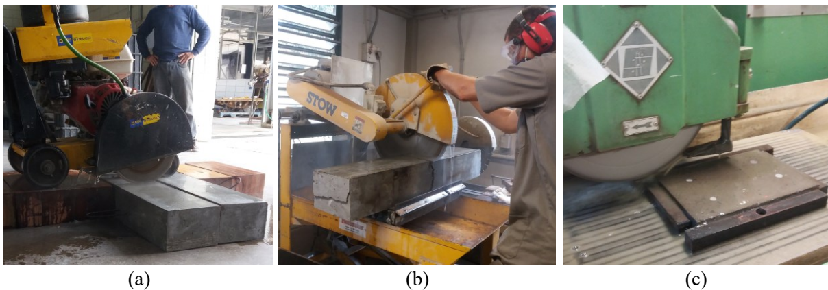
Figura 4.2 – Obtenção dos planos de corte: (a) corte das extremidade das vigas, (b) corte dos planos próximos ao de fissuração principal e (c) polimento da superfície de corte
