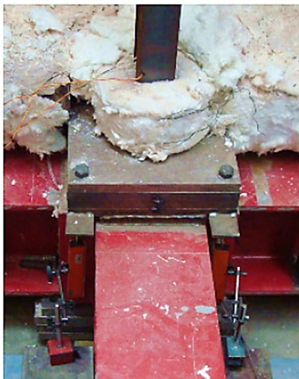
Figura 4.17 - Posicionamento dos transdutores de deslocamento no ensaio experimental
