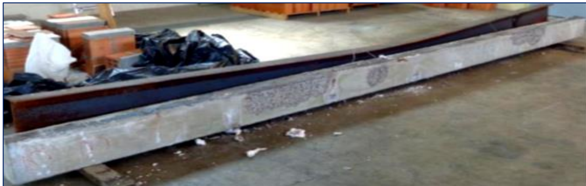
Figura 3.32 – Configuração final das vigas de aço isolada e viga mista de aço e concreto parcialmente revestida após submetida ao ensaio em temperatura elevada
