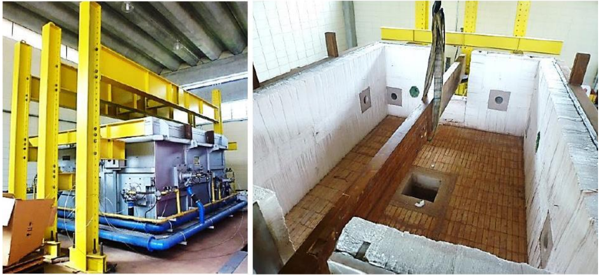
Figura 3.21 – Forno horizontal a gás alocado nas dependências do Laboratório de Engenharia de Estruturas da EESC/USP
