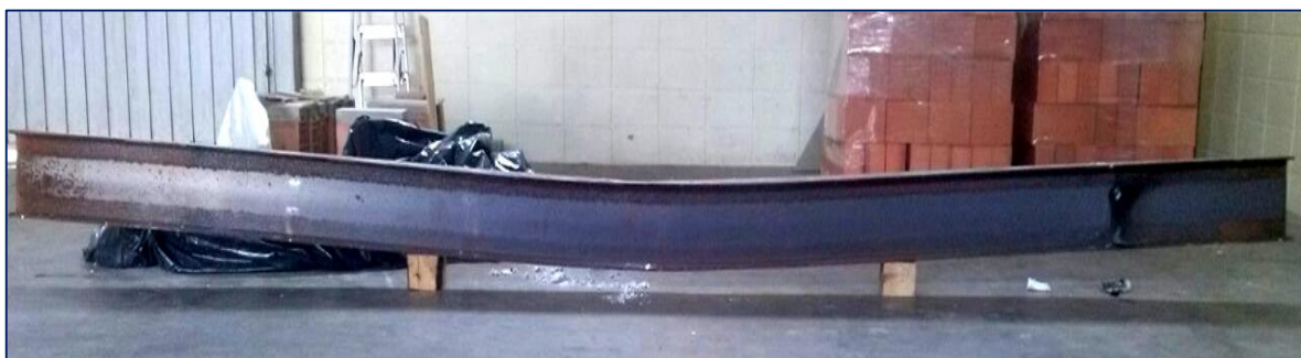
Figura 3.31 – Configuração final da viga de aço isolada após submetida ao ensaio em temperatura elevada
