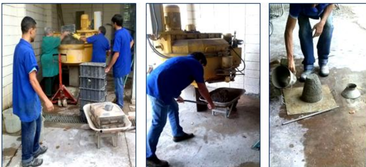
Figura 3.3 – Produção do concreto e teste de abatimento do tronco de cone
