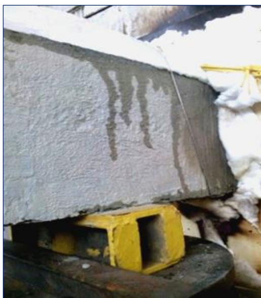
Figura 3.33 – Liberação de água do concreto devido à alta temperatura
