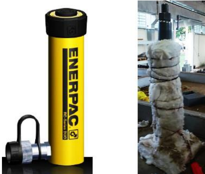
Figura 3.12 – Cilindro hidráulico e prolongador protegido com manta cerâmica
