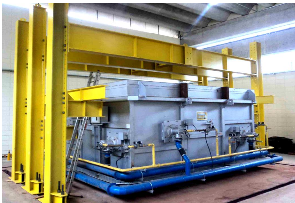
Figura 1.1 – Forno horizontal alimentado a gás da EESC/USP
