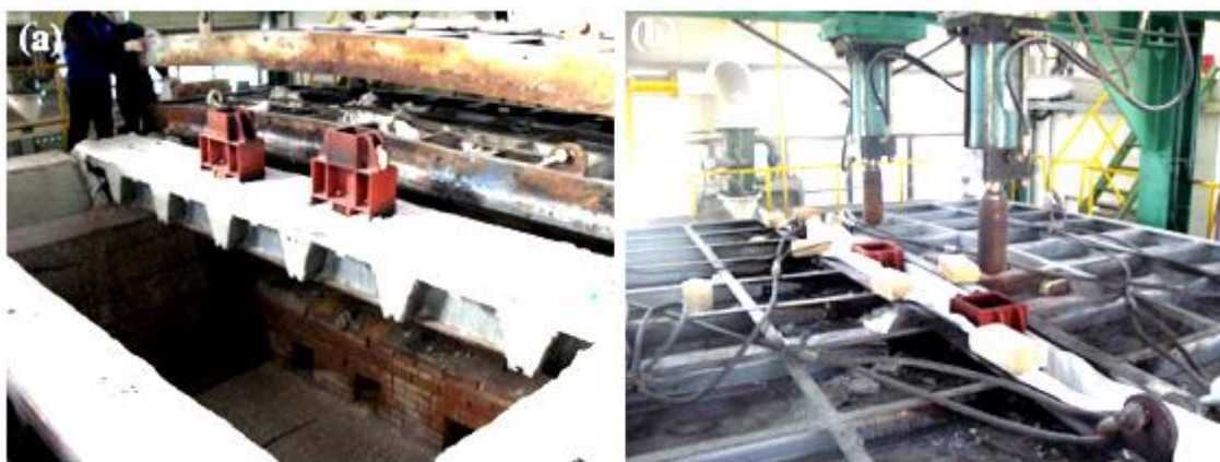
Figura 2.17 - Ensaios termoestruturais em vigas slim floor, Kim et al. (2011).
