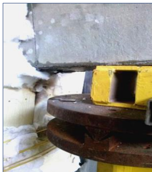
Figura 3.33 – Liberação de água do concreto devido à alta temperatura
