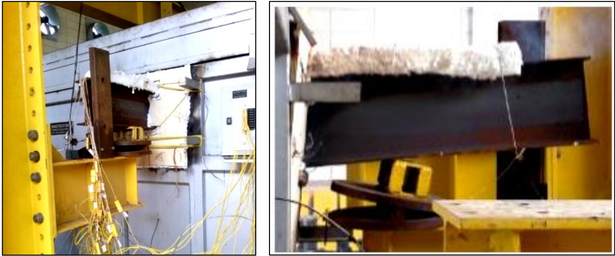
Figura 3.22 – Fechamento lateral do forno e rotação excessiva em um dos apoios
