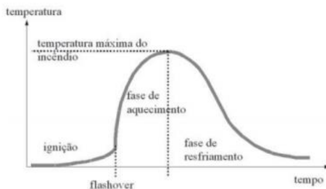
Figura A.2 – Curva temperatura-tempo de um incêndio real Fonte: Silva et al. (2010)
