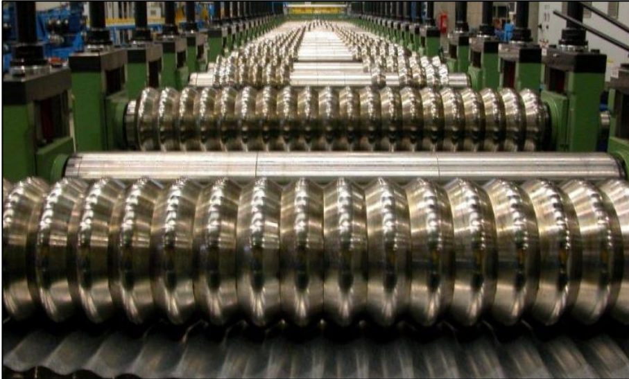
Figura 2 - Processo de perfilação da chapa corrugada
