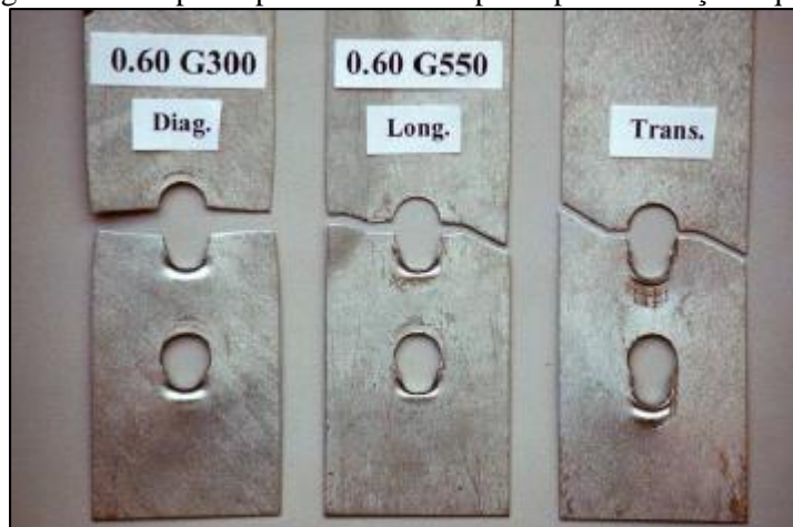
Figura 15 - Corpo de prova com falha por ruptura da seção líquida
