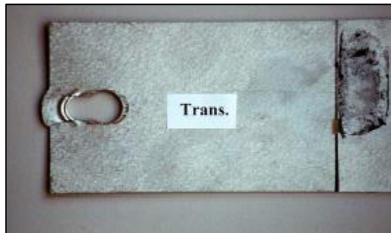
Figura 9 - Corpo de prova com falha por rasgamento
