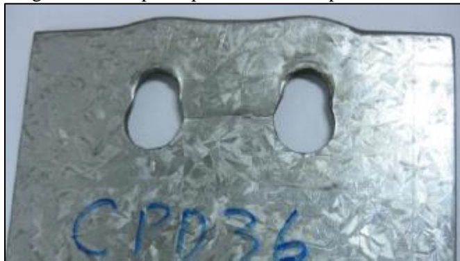
Figura 19 - Corpo de prova com falha por block shear
