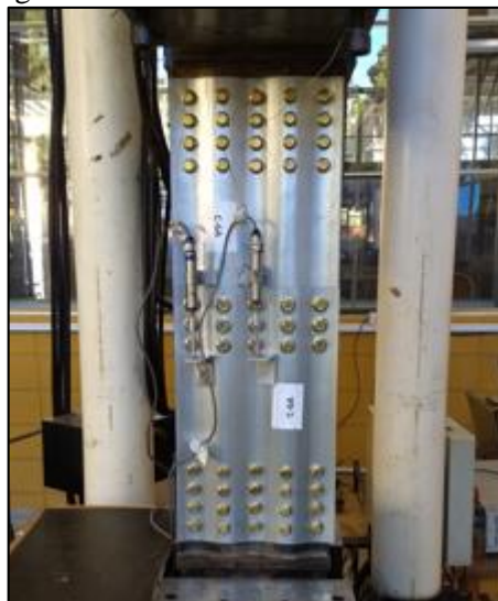
Figura 36 - Transdutores de deslocamento
