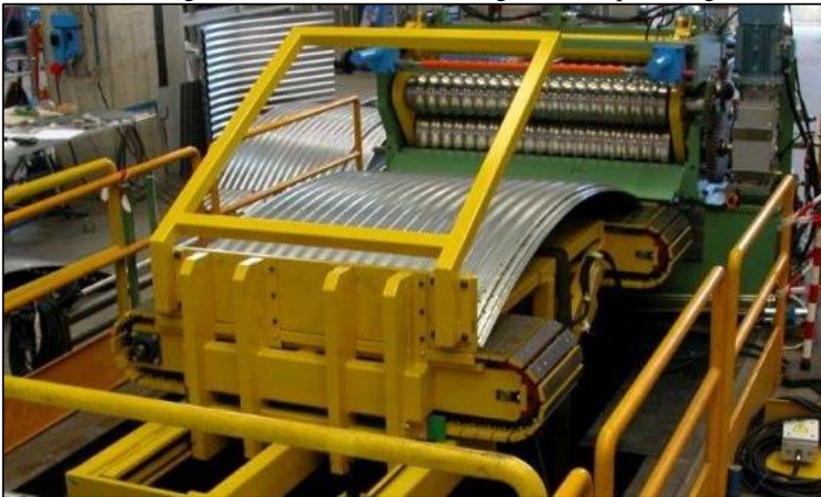
Figura 3 - Processo de calandragem da chapa corrugada
