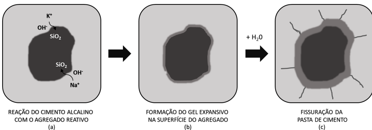
Figura 2.2 - Mecanismo da reação álcali-sílica.
