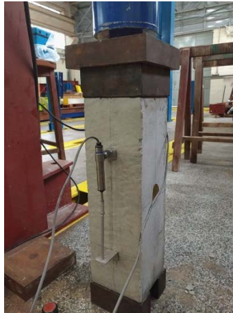
Figura 3. 9 – Posicionamento do transdutor LVDT durante a terceira etapa de ensaios
