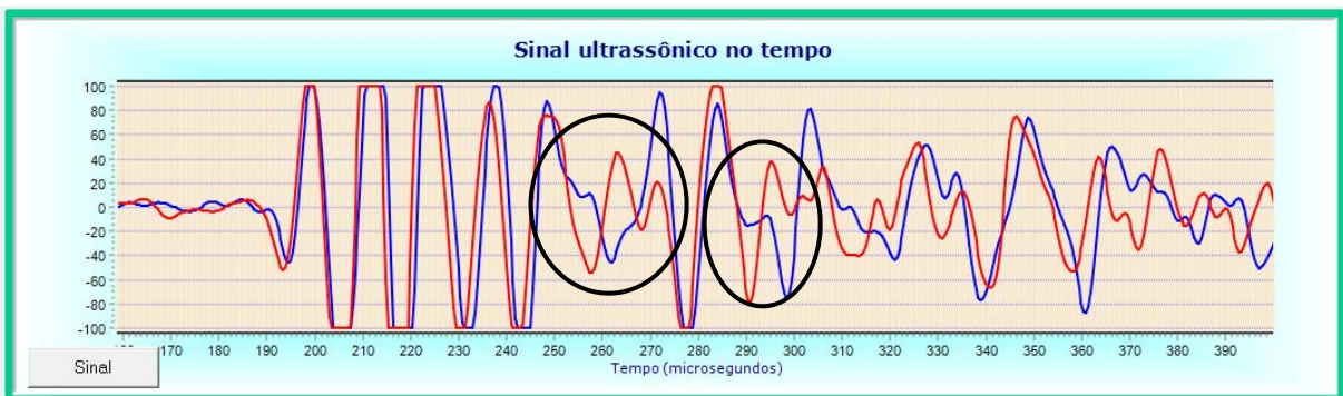
Figura 4. 16 – Detalhe da sobreposição dos sinais sem carregamento (onda azul) e com carregamento de 30% da tensão de ruptura (onda vermelha)
