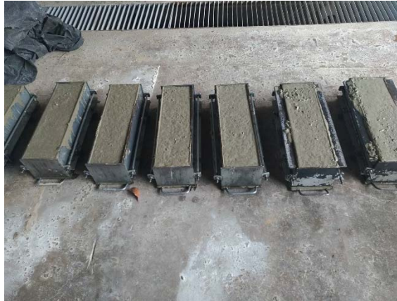
Figura 5. 1 – Prismas após a concretagem
