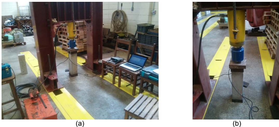
Figura 3. 6 – Ensaio preliminares: (a) configuração do ensaio e (b) detalhe do posicionamento do corpo de prova
