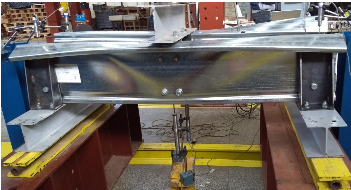
Figura 5.12 – Rotação da mesa superior nas regiões dos apoios (protótipo ZAE 340-2.N)
