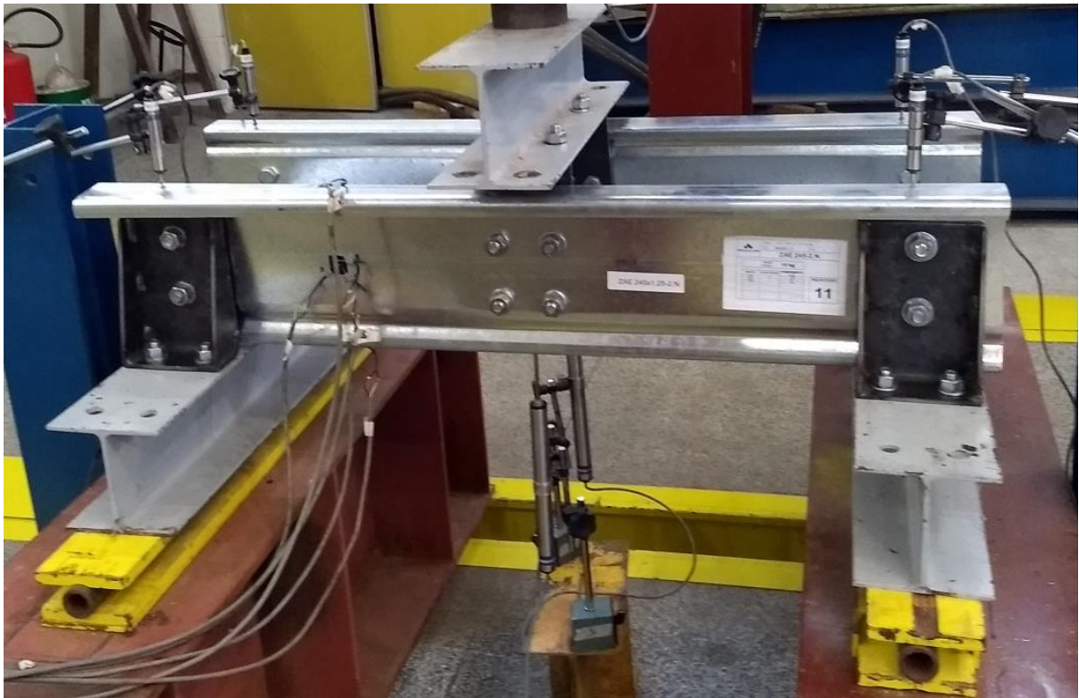
Figura 4.13 – Vista geral de um ensaio de combinação de momento fletor e força cortante (protótipo ZAE 245-2.N)
