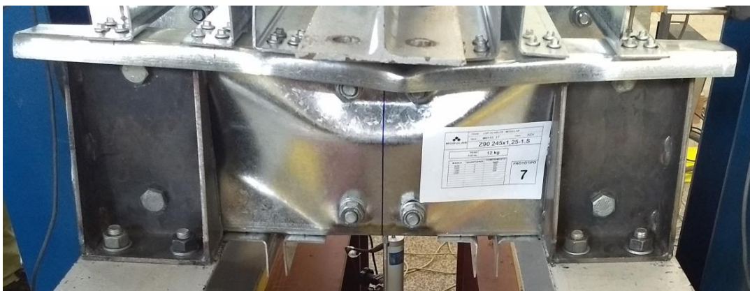
Figura 5.16 – Enrugamento da alma em ensaio de relação a/h = 1 (protótipo Z 245-1.S)
