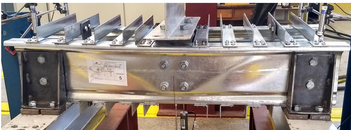
Figura 5.17 – Modo de falha para alma enrijecida e relação a/h = 2 (protótipo ZAE 245-2.S)
