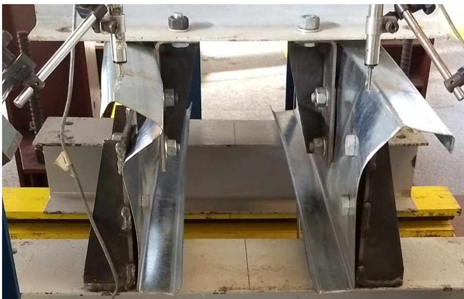
Figura 5.14 – Rotação da mesa no apoio durante ensaio complementar (protótipo Z 245-1.N_comp)
