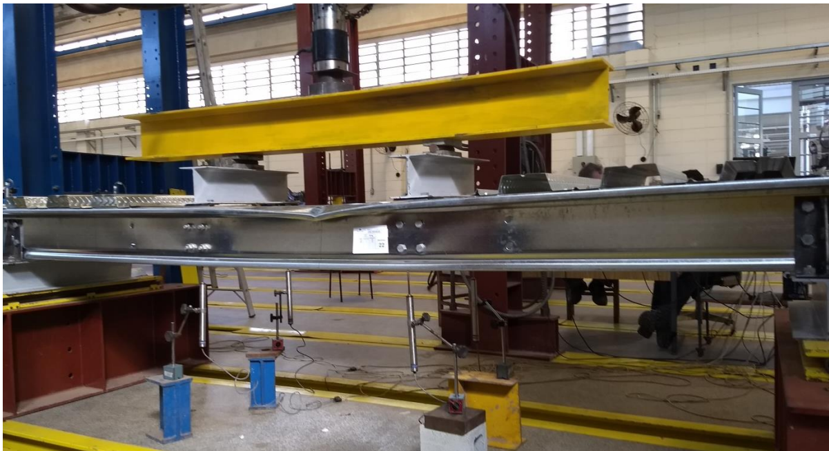
Figura 5.21 – Falha por instabilidade distorcional em ensaio de predomínio de momento fletor (protótipo Z 245-M.N)
