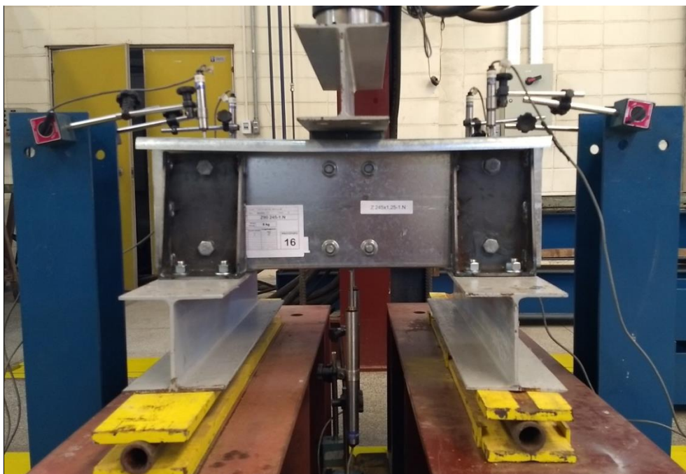
Figura 4.12 – Vista geral de um ensaio de predomínio de força cortante (protótipo Z 245-1.N)
