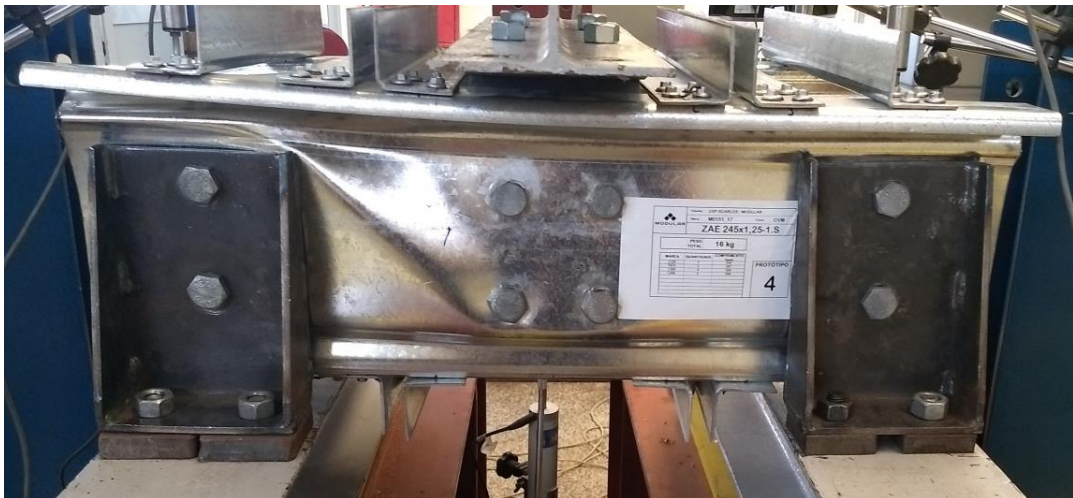
Figura 5.15 – Formação de diagonais em ensaio de relação a/h = 1 (protótipo ZAE 245-1.S)
