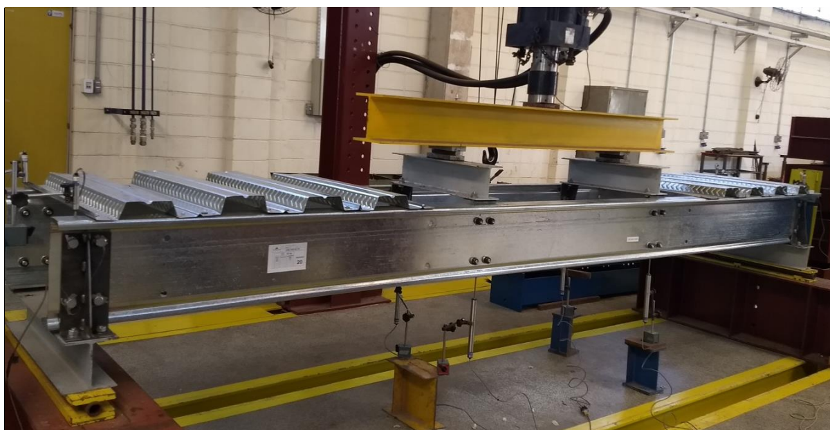
Figura 4.16 – Vista geral de um ensaio de predomínio momento fletor (protótipo ZAE 340-M.N)
