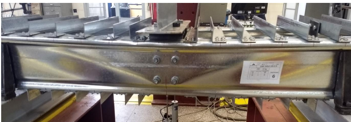
Figura 5.18 – Modo de falha para alma enrijecida e relação a/h = 3 (protótipo ZAE 245-3.S)
