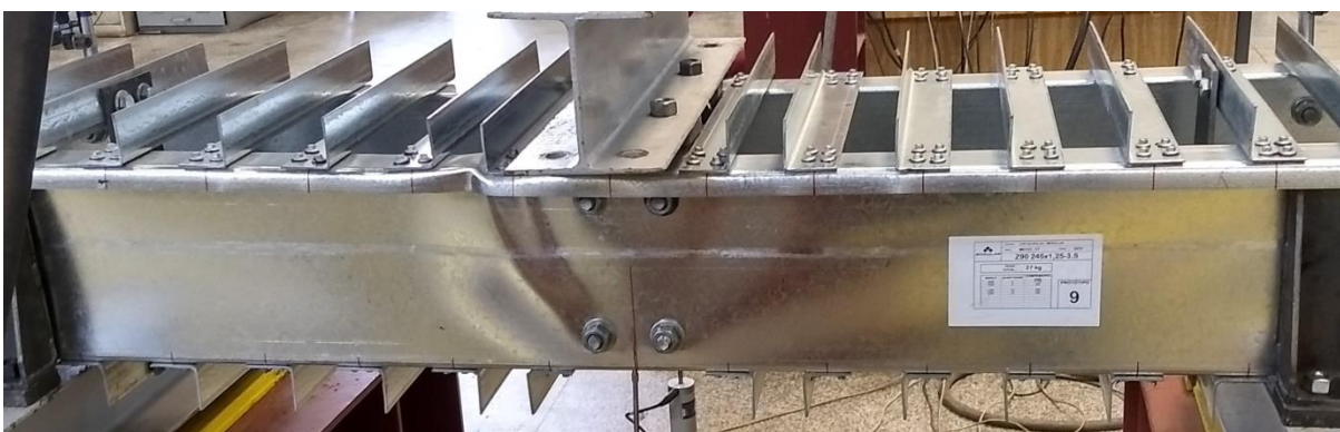
Figura 5.20 – Modo de falha para alma plana e relação a/h = 3 (protótipo Z 245-3.S)
