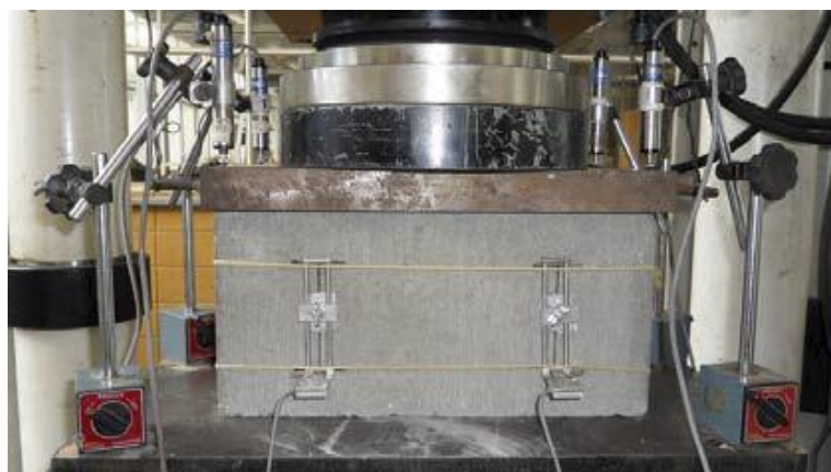
Figura 33 – Ensaio de compressão do bloco de concreto
