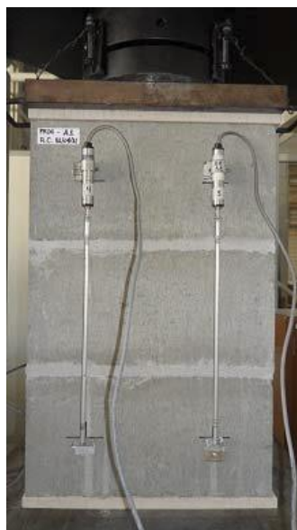
Figura 42 – Ensaio de compressão do prisma de três blocos com argamassamento parcial
