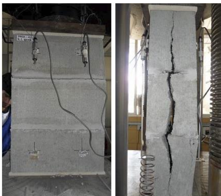
Figura 45 – Modo de ruptura do prisma de três blocos com argamassamento parcial
