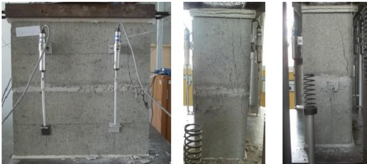
Figura 50 – Modo de ruptura do prisma de dois blocos com argamassamento total
