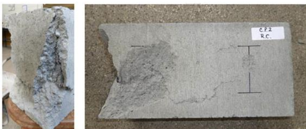
Figura 38 – Modo de ruptura do bloco de concreto
