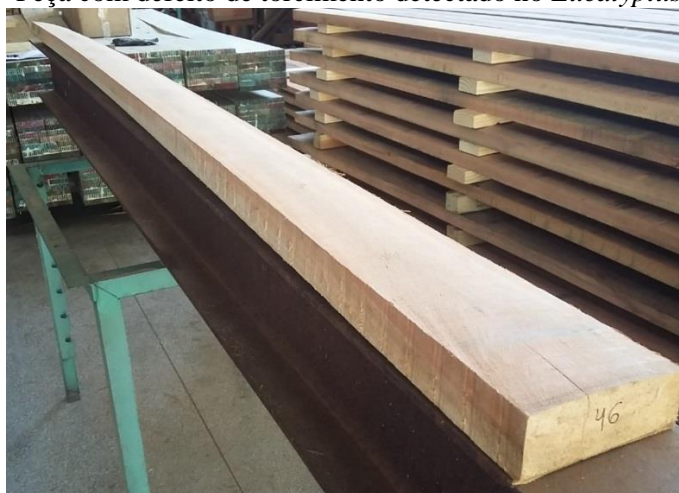
Figura 24 – Peça com defeito de torcimento detectado no Eucalyptus urograndis
