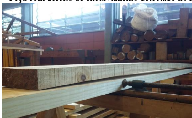
Figura 22 – Peça com defeito de encurvamento detectado no Pinus taeda
