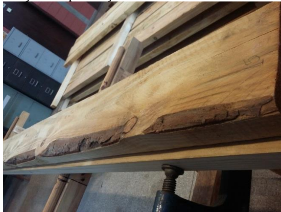
Figura 27 – Peça com presença de esmoado encontrado no Pinus taeda
