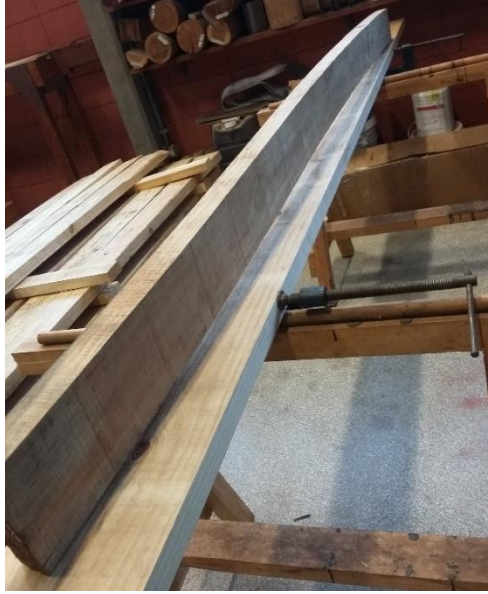
Figura 26 – Peça com defeito de arqueamento acentuado no Pinus taeda
