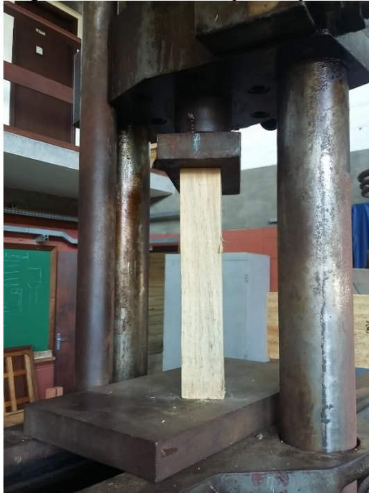
Figura 14 – Ensaio de compressão paralela
