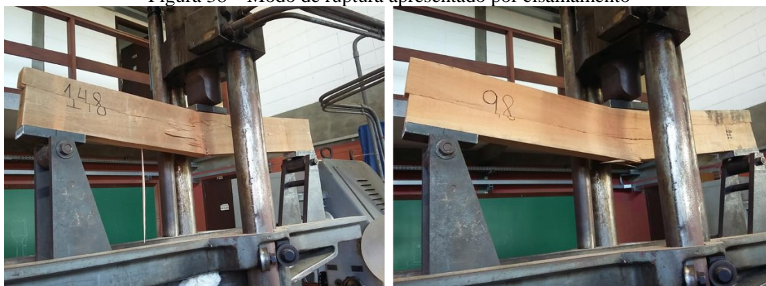
Figura 38 – Modo de ruptura apresentado por cisalhamento
