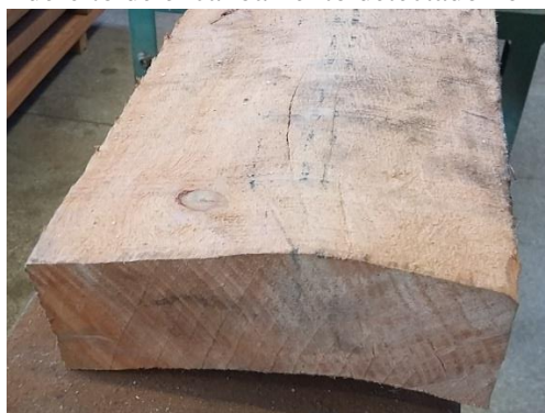
Figura 25 – Peça com defeito de encanoamento detectado no Eucalyptus urograndis
