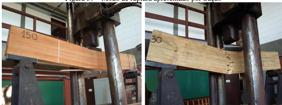
Figura 39 – Modo de ruptura apresentado por tração
