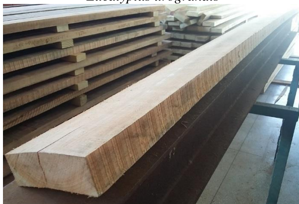
Figura 23 – Peça com defeitos de torcimento, fissura não passante e encanoamento encontrados no Eucalyptus urograndis
