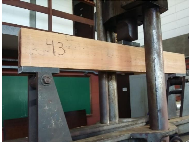
Figura 19 – Ensaio de cisalhamento paralelo às fibras
