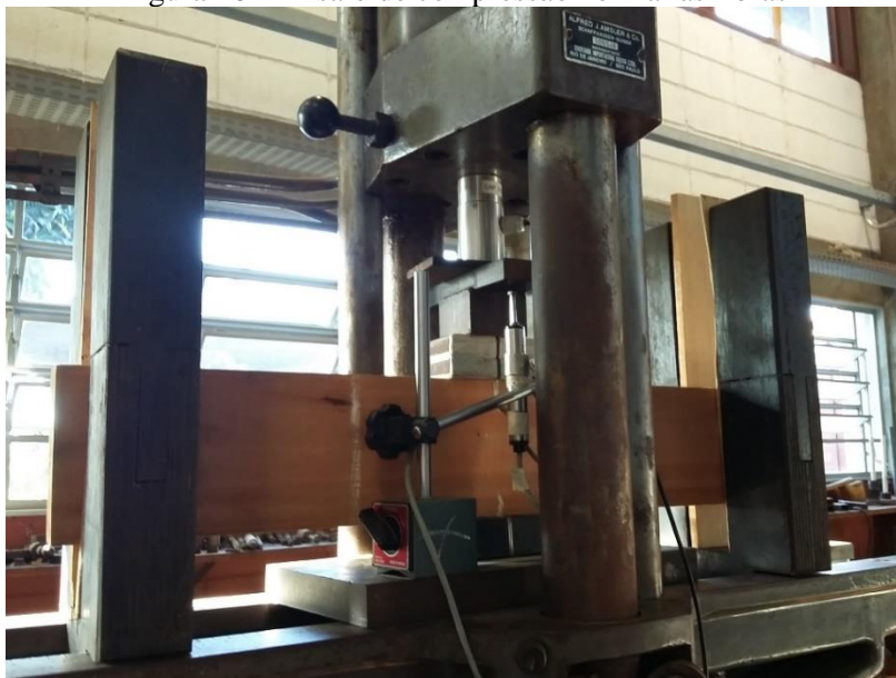
Figura 16 – Ensaio de compressão normal às fibras
