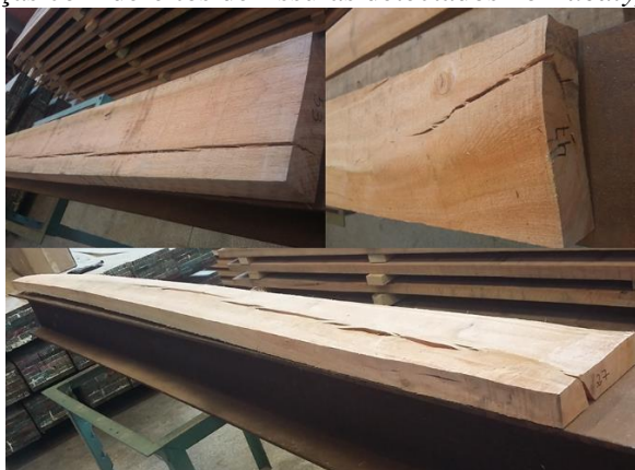
Figura 21 – Peças com defeitos de fissuras detectados no Eucalyptus urograndis
